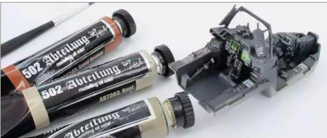
**13** Mit Ölfarben werden die Verunreinigungen erzeugt. Maßgeblich für den Modellbauer sind sand- und erdfarbene Töne, die von der Crew in das Cockpit getragen werden
