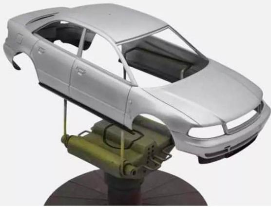
**13** Die Karosserie wurde vor der Lackierung nachgraviert und die angegossenen Verschlüsse wurden entfernt, da sie später durch Ätzteile ersetzt wurden
