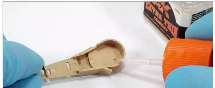
**4** Für die Kunststoffmontage wird AK Interactive „Extra thin Cement“ AK12002 verwendet. Da es sich um einen besonders dünnen Kleber handelt, eignet er sich ideal
