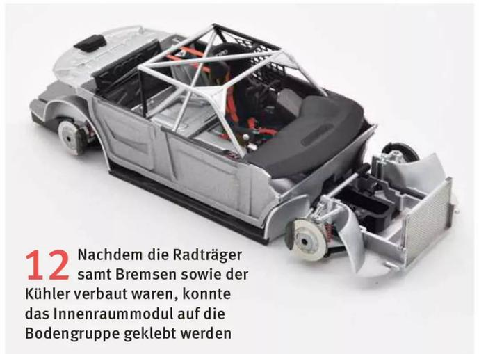
**12** Nachdem die Radträger samt Bremsen sowie der Kühler verbaut waren, konnte das Innenraummodul auf die Bodengruppe geklebt werden
