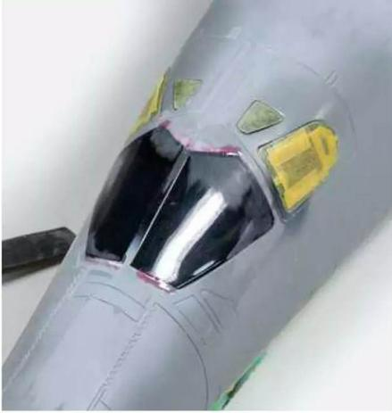
**16** Schritt 1: die Cockpitscheibe erst etwas größer plan mit dem Rest des Rumpfes schleifen ...
