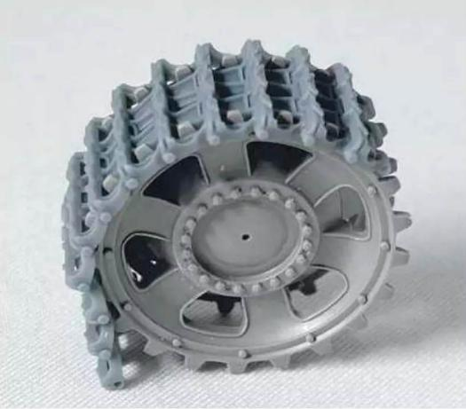
**4** Leider enthält der Bausatz nicht die passende Kette für das Vorbildfahrzeug. Ersatz kommt aus dem 3D-Drucker von Panzerwerk Design
