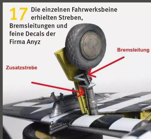
**17** Die einzelnen Fahrwerksbeine erhielten Streben, Bremsleitungen und feine Decals der Firma Anyz
