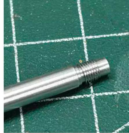
**6** Das Gewinde am Rohrende ist leider am Plastikteil des Bausatzes nicht vorhanden. Abhilfe schafft hier ein Alurohr von RB-Model
