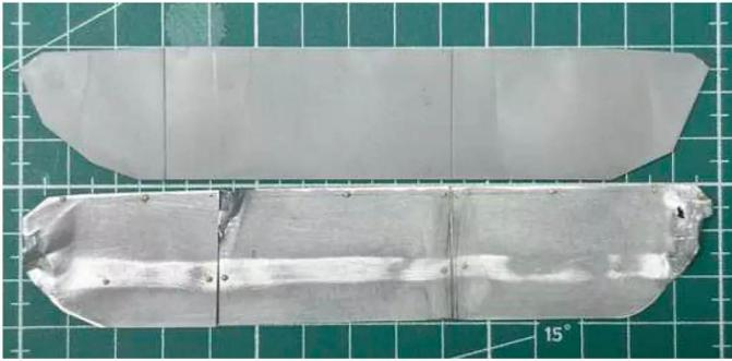
**14** Oben im Bild das Bausatzteil der linken Schürze. Darunter die drei Segmente in veränderter Einteilung aus Alublech
