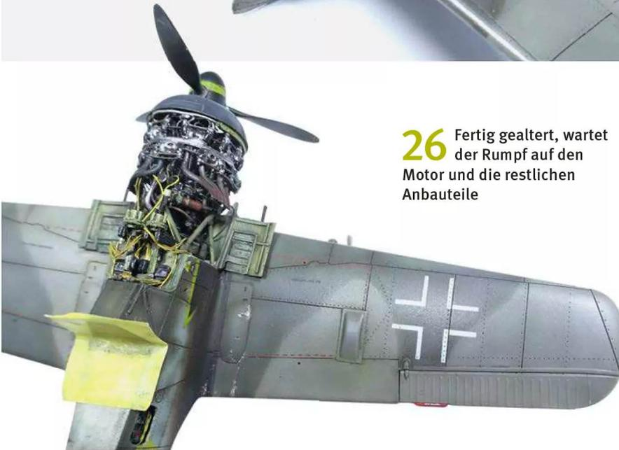
**26** Fertig gealtert, wartet der Rumpf auf den Motor und die restlichen Anbauteile
