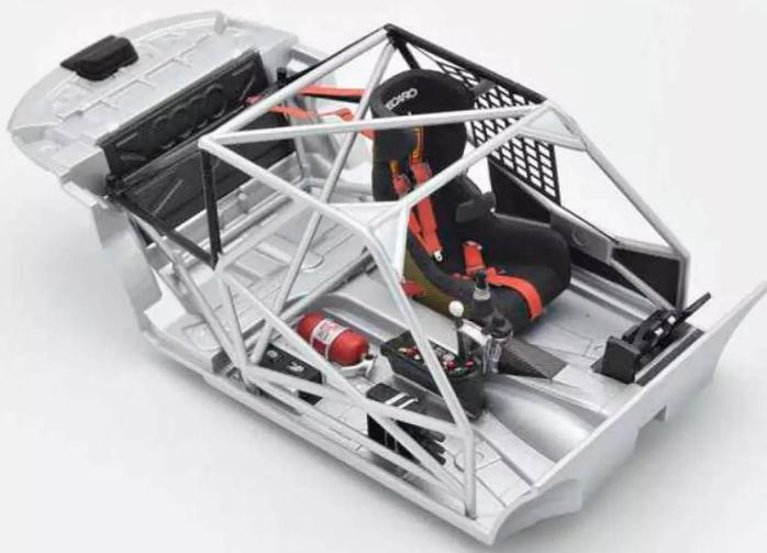
**9** Die Passgenauigkeit des Überrollkäfigs war hervorragend. Um die lackierte Oberseite zu schützen, wurde der Käfig von der Unterseite mit Sekundenkleber verklebt
