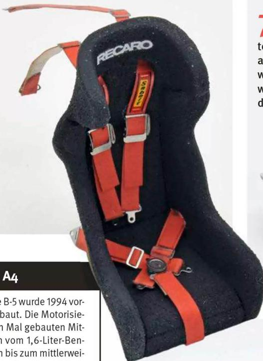
**7** Bevor der Überrollkäfig verbaut werden konnte, musste der Fahrersitz auf das Bodenteil geklebt werden. Die Schultergurte werden an der Gurtstrobe des Käfigs befestigt
