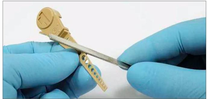
**2** Der Kunststoff ist sehr hochwertig und leicht zu bearbeiten. Um den überschüssigen Kunststoff zu entfernen, werden normale Schleifmittel verwendet
