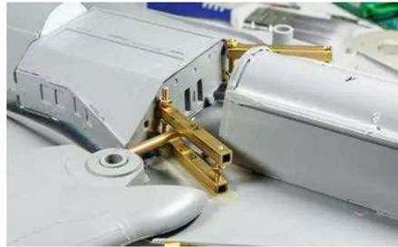
**13** Auf Messingschienen gleitet die Flügelstrebe. Die vordere und hintere Position lassen sich individuell einstellen
