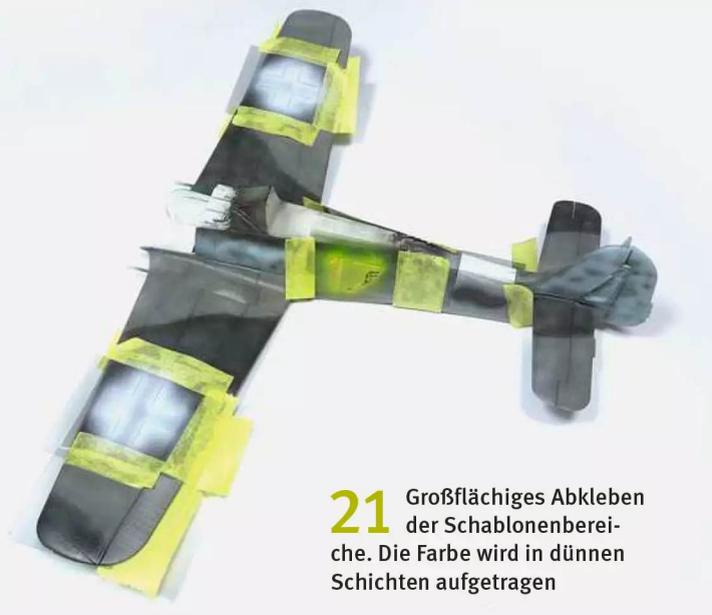
**21** Großflächiges Abkleben der Schablonenbereiche. Die Farbe wird in dünnen Schichten aufgetragen
