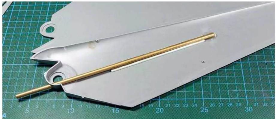
**15** Die Strebe ragt ein ganzes Stück in den Flügel und zwingt ihn so in eine immer gerade Position. Das ist aufwendig, jedoch dann dauerhaft stabil und haltbar
