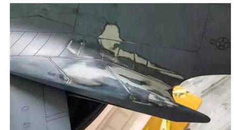
**34** Da hilft nur Warten bis es trocken ist, abschleifen, neu grundieren und lackieren
