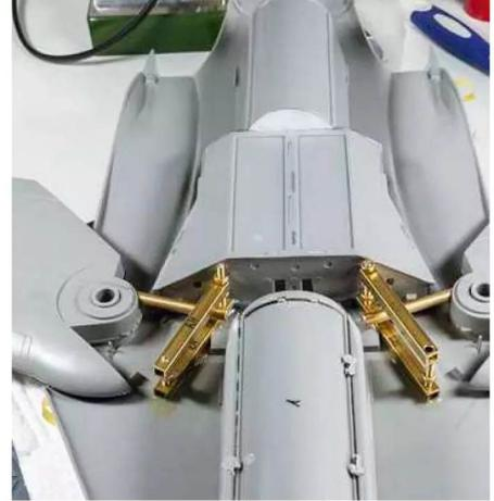
**14** So hängen die schweren Flügel in den völlig überlasteten Plastiklagern nicht nach unten
