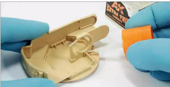
**7** Hauptteile des Turms werden zusammengebaut. Auch hier wird AK-Interactive „Extra thin Cement“ verwendet. Die Endfestigkeit ist gleichwertig wie bei normalen Klebstoffen
