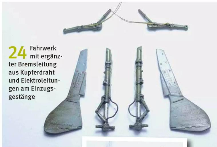
**24** Fahrwerk mit ergänzter Bremsleitung aus Kupferdraht und Elektroleitungen am Einzugs-gestänge
