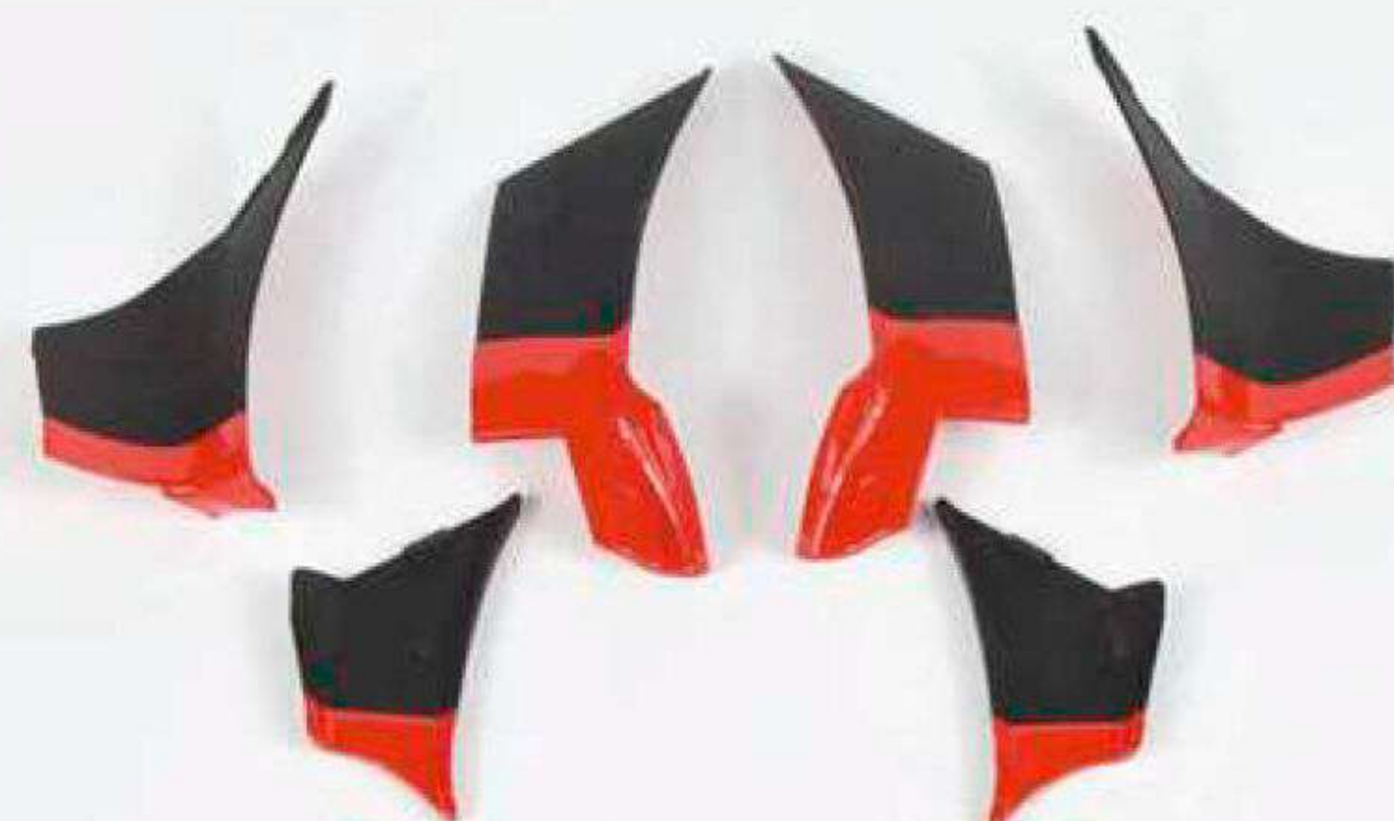
5 Auch die Innenseiten der Kühlluftkanäle sollten vor dem Zusammensetzen bemalt werden. Die Farbgrenze zwischen Rot und Carbonfarbe ist mit einer feinen Naht markiert
