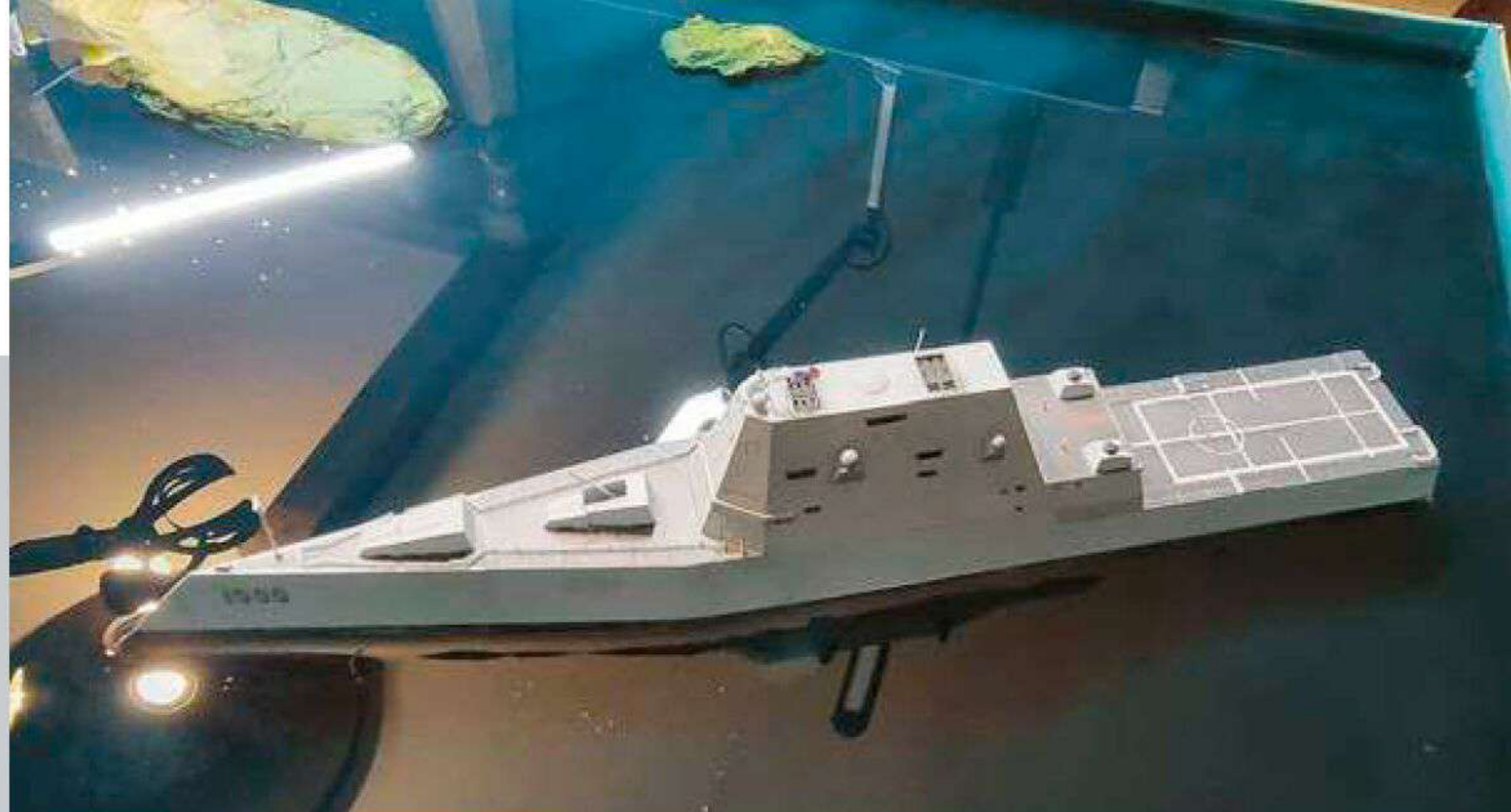
30 DDG 1000 steht nun kippsicher im Harz und die Folgeschichten können langsam (!) hochgegossen werden
