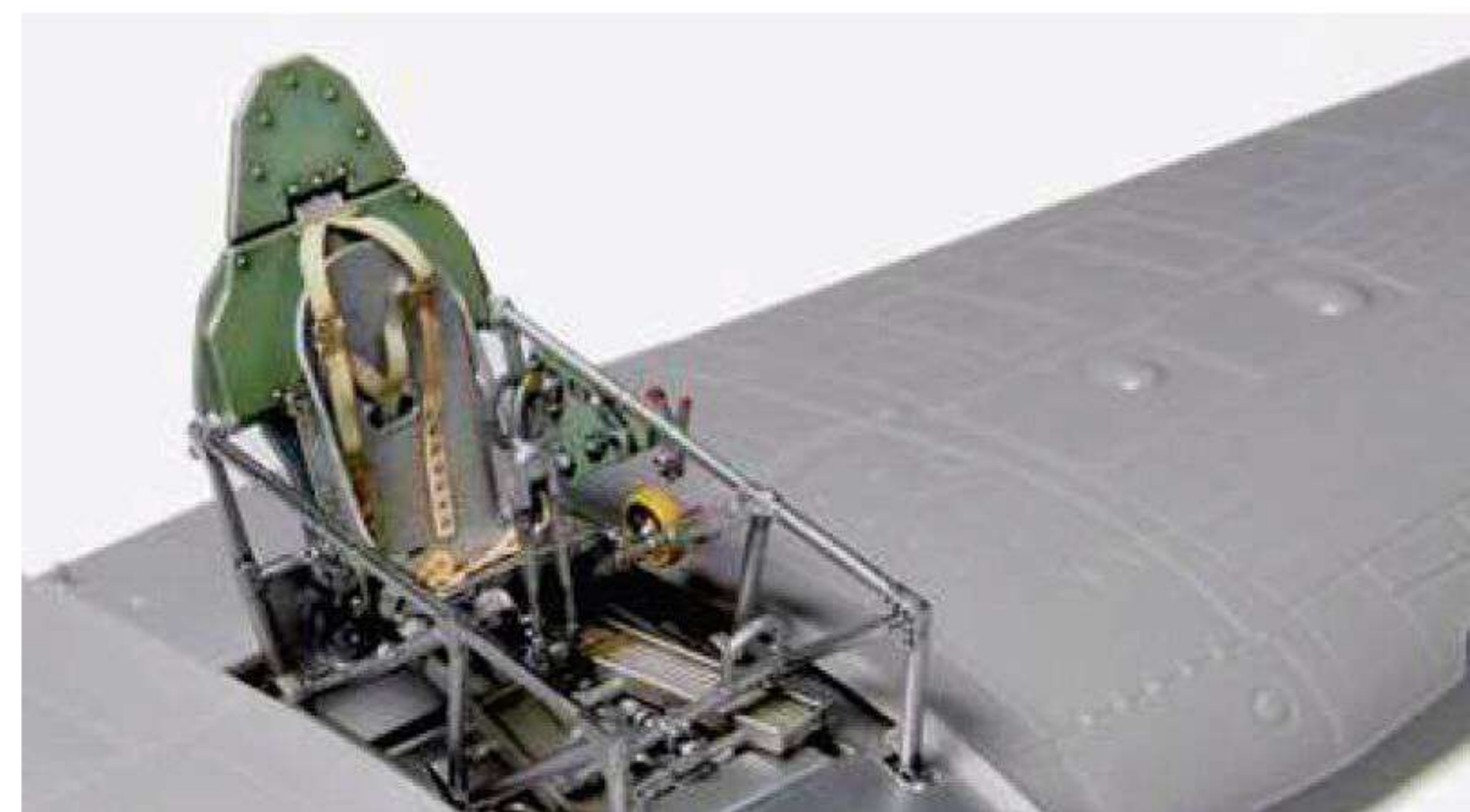
5 Der Aufbau der Cockpitkonstruktion auf der Tragfläche ist ungewohnt, hat sich aber in der Praxis bewährt
