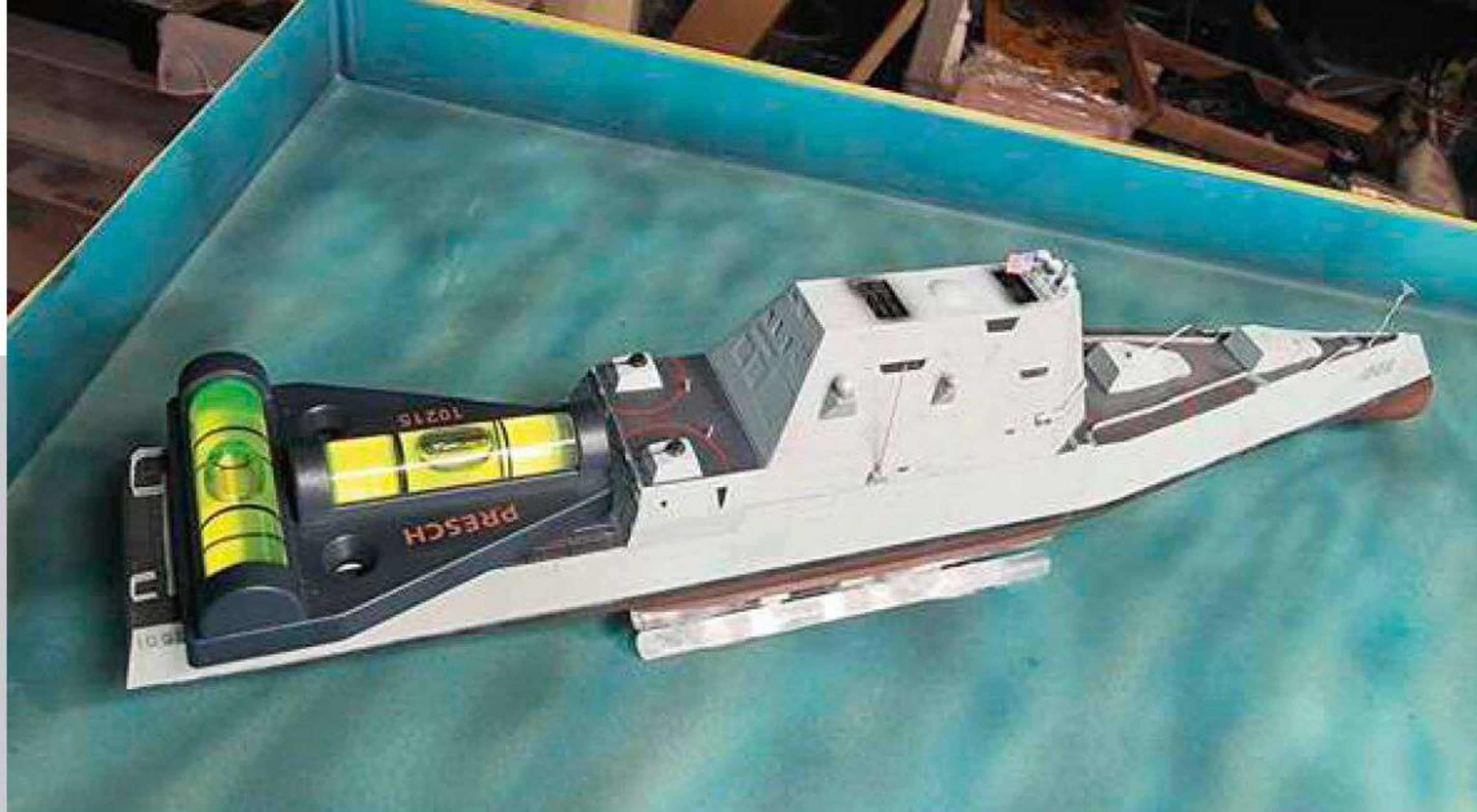
29 Mit dem Acrylstab-Konstrukt unter dem Modell und Waagen kann das gesamte Modell genau ausgerichtet werden
