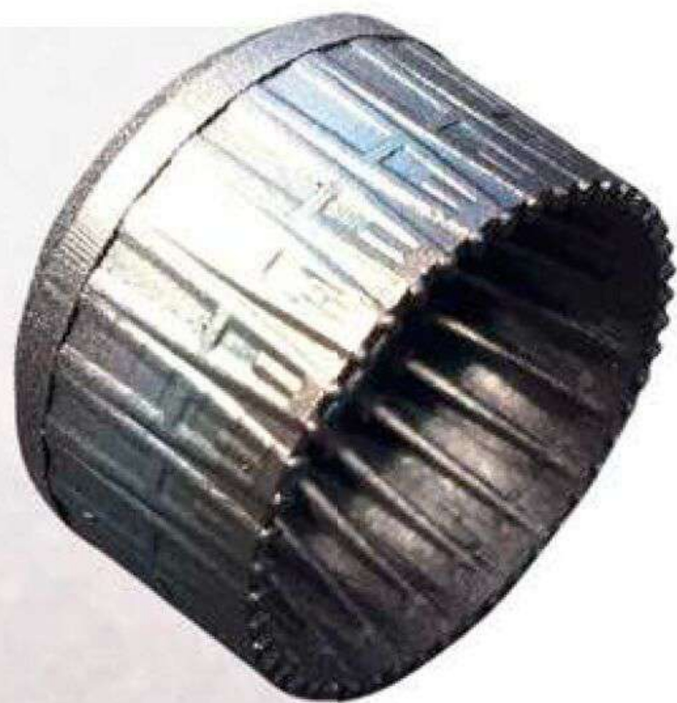
24 Die Nozzle des frühen Triebwerkes ist im 3-D-Druck superfiligran ausgeführt
