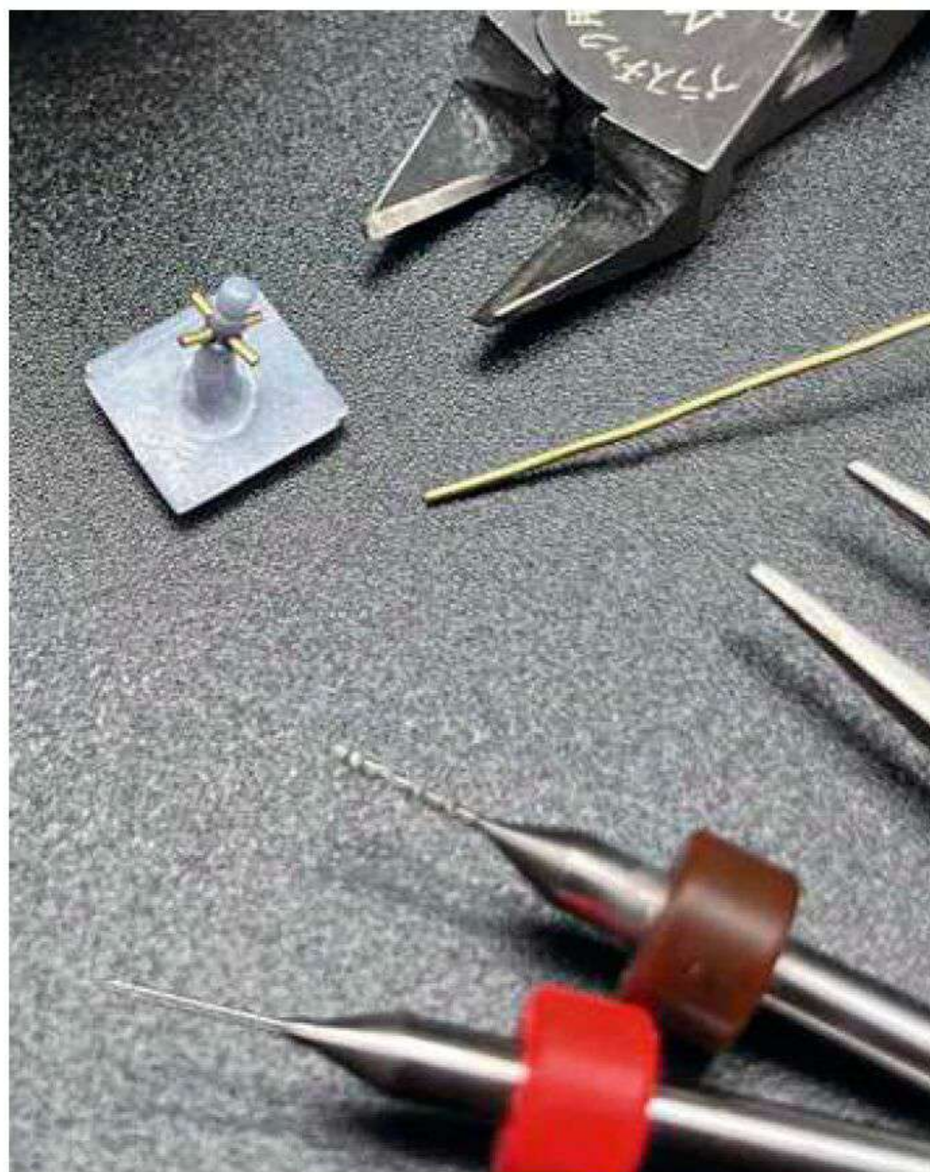
7 Die Rampenstützen werden mit 0,6 Millimeter starkem Messingdraht ergänzt. Feinste Bohrer helfen
