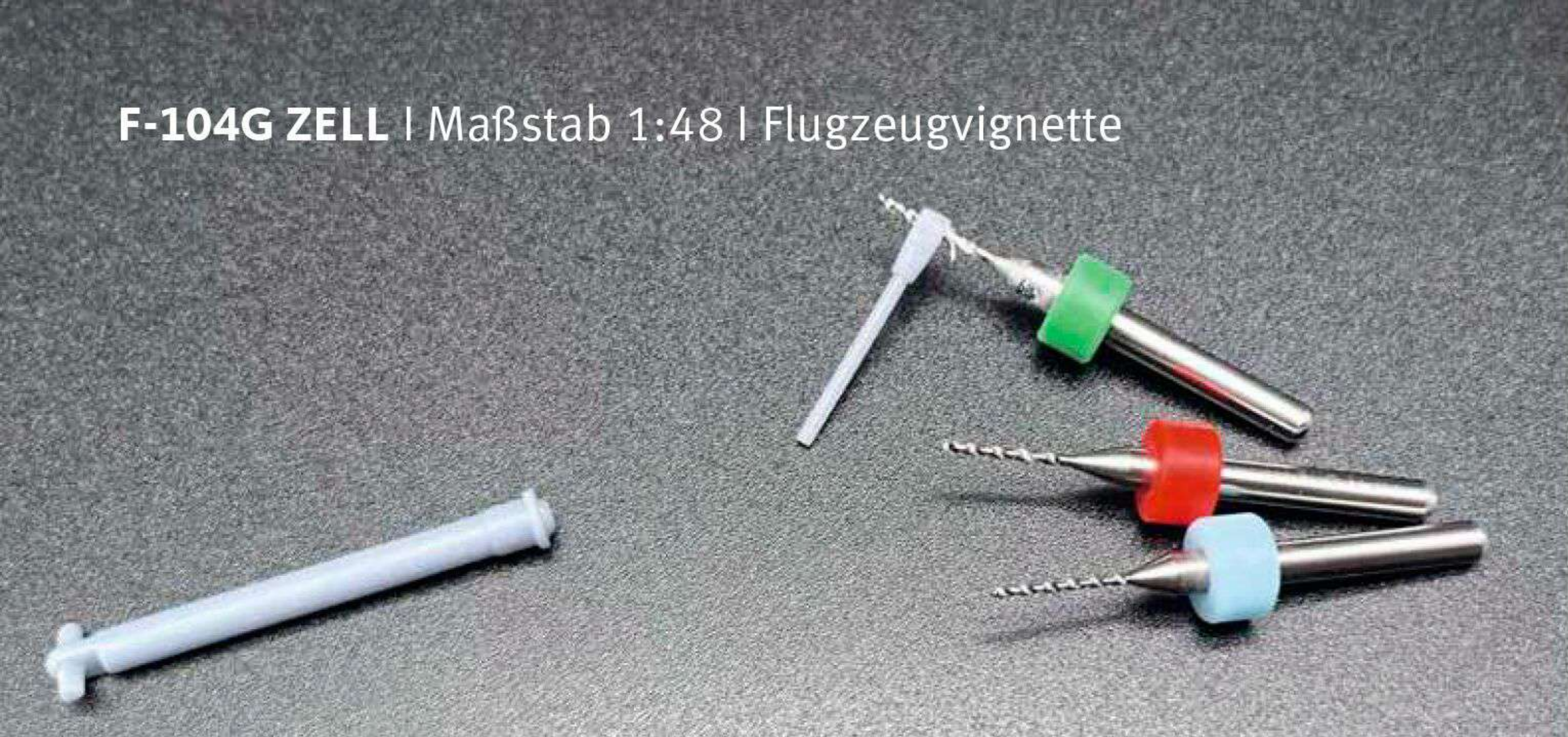
13 Nachbohren der Kopfteile mithilfe der sehr sinnvollen Mikrobohrer für Handbetrieb
