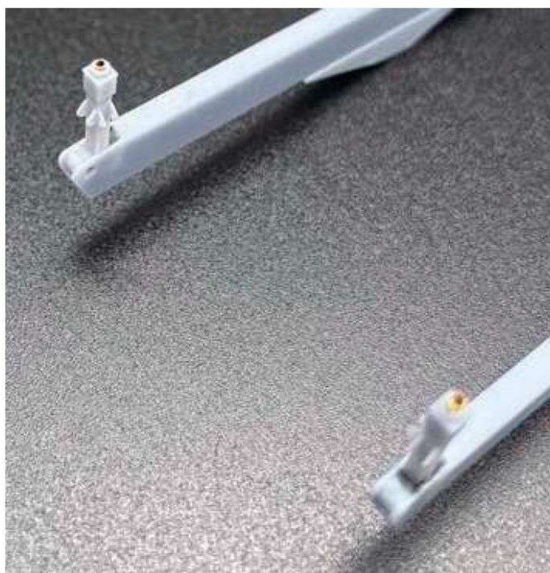
9 Die Pendelstützen können vor dem Einsetzen in den Ausleger mit einem Messingrohr ausgebuchst werden
