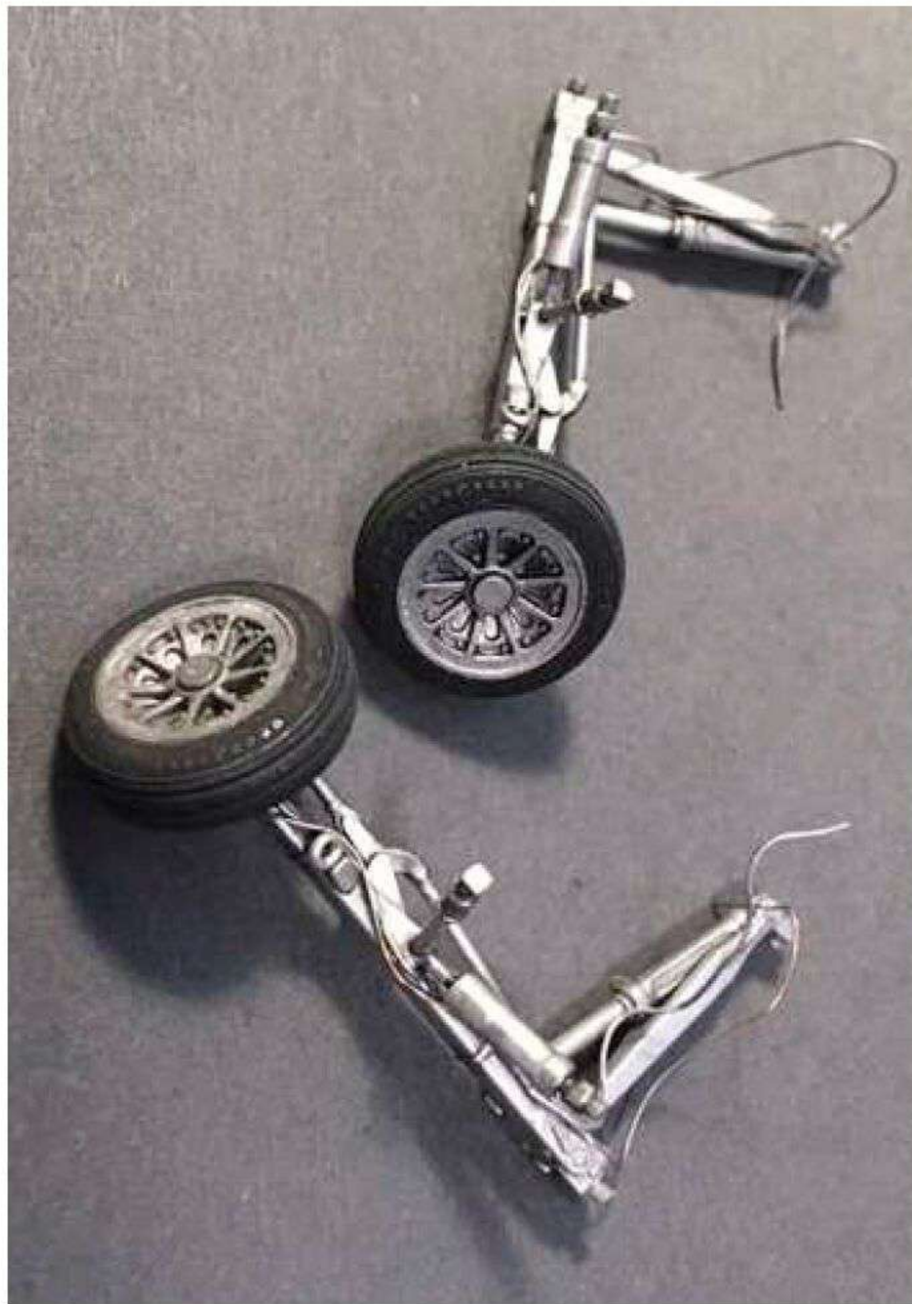
27 Die Fahrwerksbeine wurden um die fehlenden Bremsleitungen und nicht abgeflachte Reifen von Reskit ergänzt
