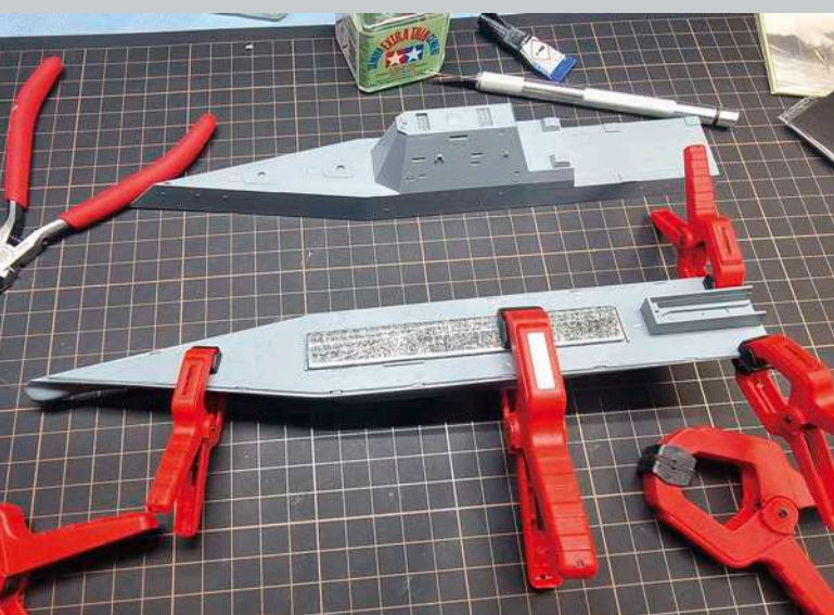
11 Der Rumpf muss mit Klammern in Form gehalten werden. In der Mitte ein Kit-Metallgewicht zur Beschwerung
