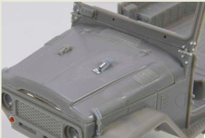
7 Alle T-Griffe werden mit ihren Halterungen neu aufgebaut. Die Scharniere erhalten zusätzliche Schraubenköpfe
