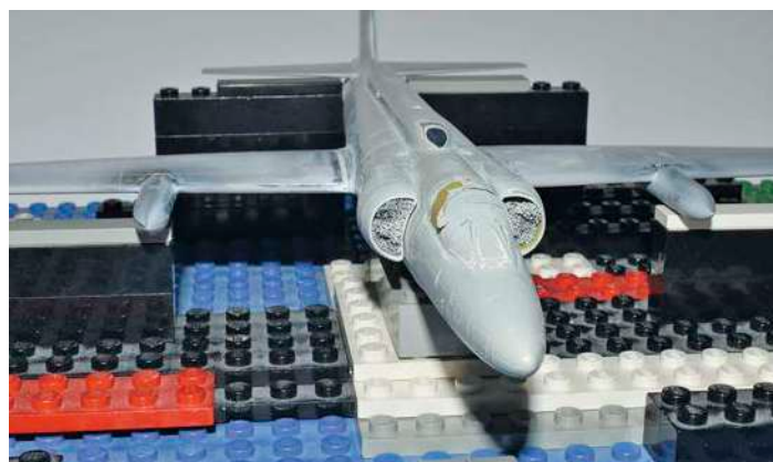
22 Auf der Helling müssen Flügel und Leitwerke ausgerichtet werden. Serienmäßig ist das Hobby-Boss-Leitwerk krumm!
