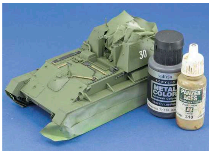
17 Werkzeug und Ausrüstungsgegenstände bemalte ich mit Vallejo-Acrylfarben. Um die Basislackierung zu schützen, schiebe ich immer dünnes Papier unter das Werkzeug
