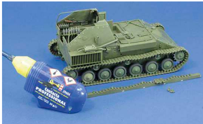
13 Der Aufbau der Kette mit der Lehre für den Kettendurchhang ist denkbar einfach. Ich habe die Kette ohne Lackierung montiert, als der Rest des Laufwerks bereits koloriert war
