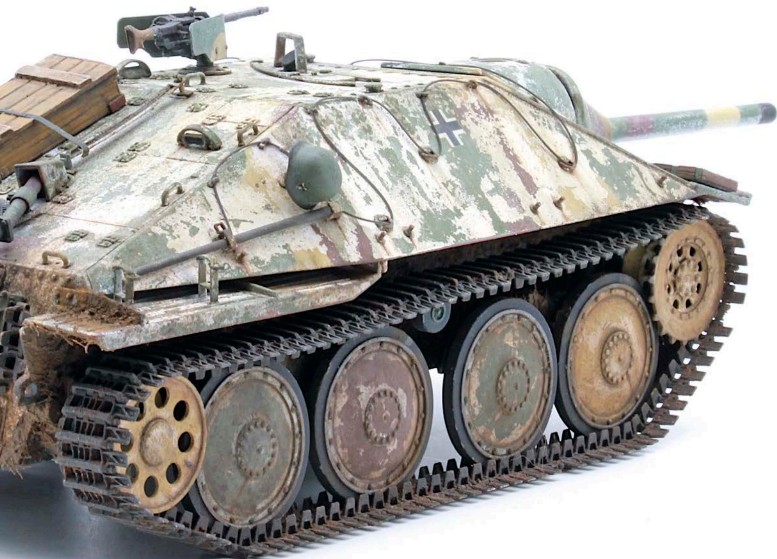
14 Eine weitere Schicht Klarlack schützte auch diesen Farbauftrag und so konnte ich ein Wash anwenden, welches ich mit „White Spirit“ in Form brachte
