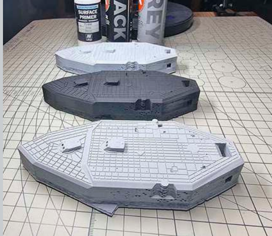
3 Die fertigen 3D-Drucke sind schon in drei unterschiedlichen Primerfarben lackiert
