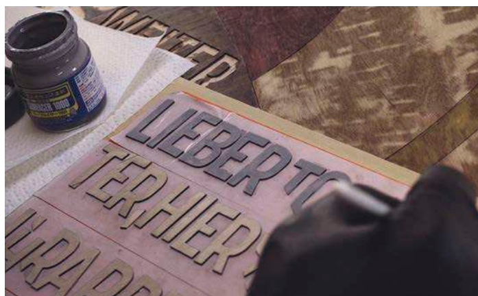
12 Das mit Schnellschleifgrund behandelte Holz ist mit Mr. Surfacer 1000 bemalt und geschliffen, um die Holzmaserung für den Metallic-Lack zu minimieren
