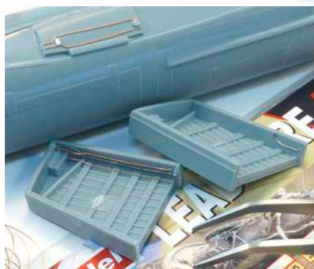
6 In den Fahrwerkschächten müssen hässliche Auswerferstempel entfernt und ein paar Leitungen gezogen werden
