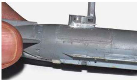
14 Großer Fehler: Das Spritzblech fehlt und muss, nach Schablone geschnitten, angebaut werden
