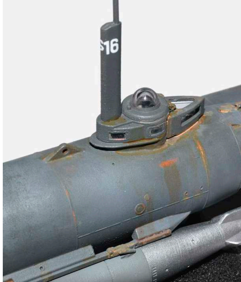
26 Schichten glänzenden Klarlacks unter und auf dem Decal „S16“ lassen den Trägerfilm verschwinden; der Rost bleibt
