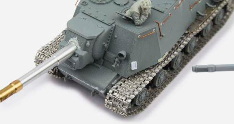
5 Das neue Rohr aus Aluminium passte nicht zu der Öffnung im Aufbau. Auch hier kamen Sheet und Spachtelmasse zum Einsatz
