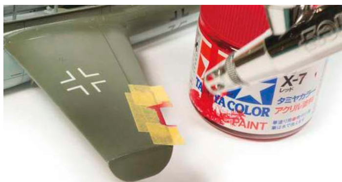
15 Manchmal ist es einfacher, zu malen, als Abziehbilder zu verwenden. Die Trimmklappen gehören dazu
