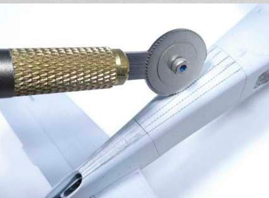
12 Nach der Grundierung mussten noch weggeschliffene Nieten und Blechstöße nachgraviert werden
