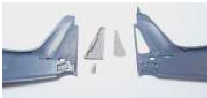
4 Auch für den Spornradeinzug im hinteren Leitwerk von Aires musste für den perfekten Sitz ordentlich Material entfernt werden
