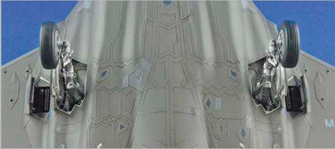
**11** Roll Posts und Hauptfahrwerke mit vom Autor ergänzten Hydraulik- und Bremsleitungen
