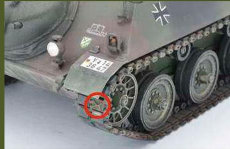
**7** Der rote Kreis verweist auf Eis-/Schneegreifer auf der Kette, die in Abständen von acht Gliedern mal rechts, mal links eingefügt wurden
