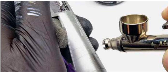
**13** Hataka-Farbe Basalt Grau RAL 7012 macht bereits beim ersten Test einen sehr guten Eindruck. Das Mischungsverhältnis beträgt hierbei 20 Teile Farbe zu 80 Teile Verdünnung
