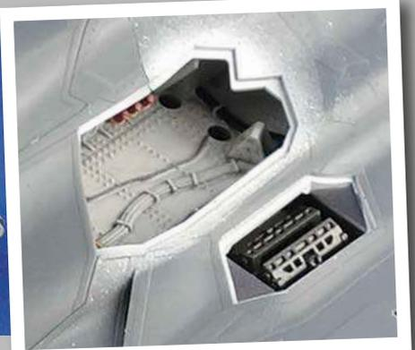
**7** Teilgeöffneter linker Hauptfahrwerkschacht, daneben einer der beiden „Roll Posts“, Hilfsdüsen zur Stabilisierung
