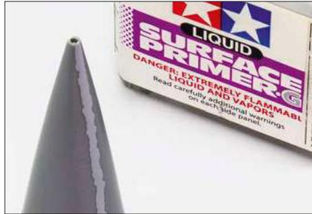
**2** Das Verspachteln der Klebnaht an der Nase ist unumgänglich. Hierzu müssen mehrere Runden eingepant und zudem das Ergebnis mit einer Farb-schicht überprüft werden
