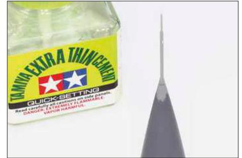
**3** Ob mit oder ohne Staurohr aus dem Hause Master: Das Bausatzteil ist im ersten Schritt einzusetzen. Schnellklebender Plastikkleber verkürzt die Wartezeit deutlich
