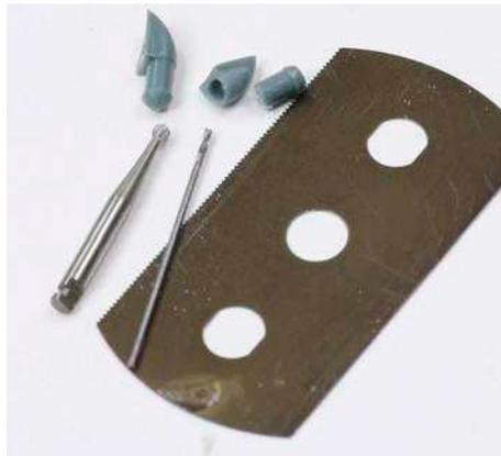
**11** Der Luftenlass der gewählten Version hatte keinen Filter. Diesen entfernen, anschließend den Luftenlass aufbohren
