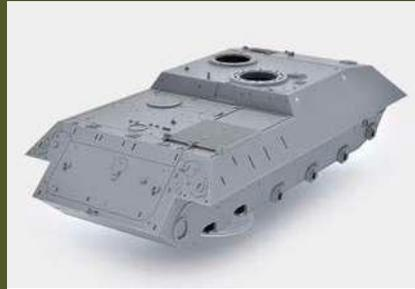
**1** Die Wannen des KajaPa/BeoPz wird nur aus Ober- und Unterwanne sowie Heckplatte passgenau zusammengefügt
