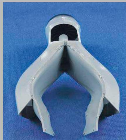
**3** Die Lufteinlässe zeigen sich vorne unten. Hinten befindet sich die Öffnung für das Hubtriebwerk mit der darin befindlichen Antriebswelle
