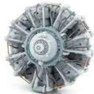
**28** Der gebaute Nakajima-Sakae-12-Motor mit Messingdraht-Stößeln und Bleidraht-Zündkabeln
