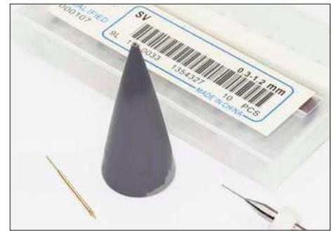
**6** Um das Staurohr aus Messing korrekt einzusetzen, muss man zunächst die Nasenspitze aufbohren. Dringend zu empfehlen ist hier der Einsatz mehrerer Bohrer nacheinander
