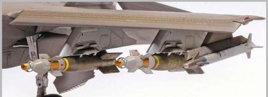
Um das Klappenthema mal zu einem Abschluss zu bringen, folgten nun die Landeklappen und Vorflügel, beide aus- oder eingefahren darstellbar, ganz wie sie benötigt werden. Diese habe ich ebenso wie die Höhen- und Seitenruder separat lackiert und erst ganz zum Schluss eingesteckt beziehungsweise eingeklebt.
