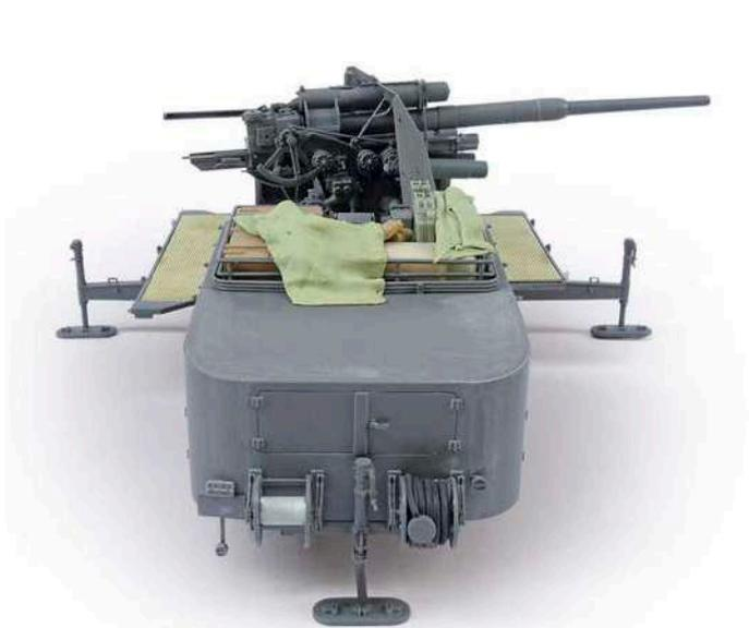
**11** Auf den Kabeltrommeln am Heck befanden sich die Verbindungskabel zum Kommandogerät. Die Kabel müssen am Modell ergänzt werden
