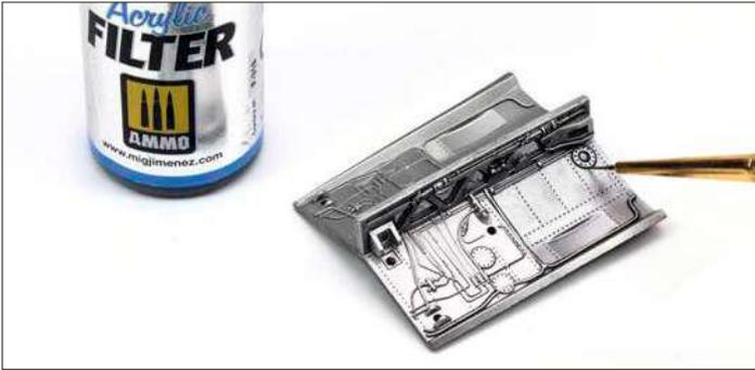
**1** Zunächst kommt ein Pinwash mit einem Acrylfiter aus der Ammo-Reihe zur Anwendung. Der Vorteil hierbei ist, dass kein schützender Klarlack zwischen den Arbeitsschritten notwendig ist
