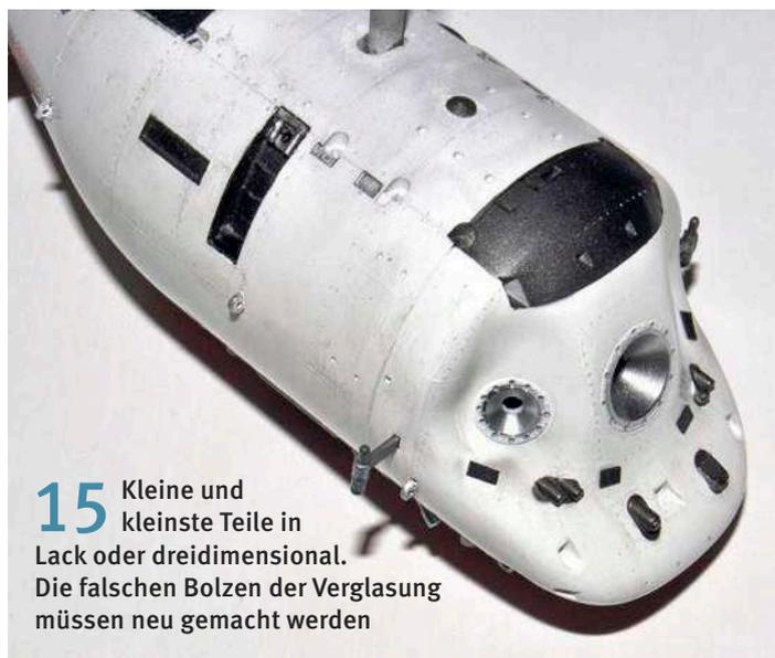
**15** Kleine und kleinste Teile in Lack oder dreidimensional. Die falschen Bolzen der Verglasung müssen neu gemacht werden
