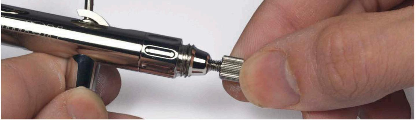
**55** Alle Teile müssen nun losgeschraubt werden. Wichtig: Die Nadel muss die Airbrushpistole unbedingt verlassen
