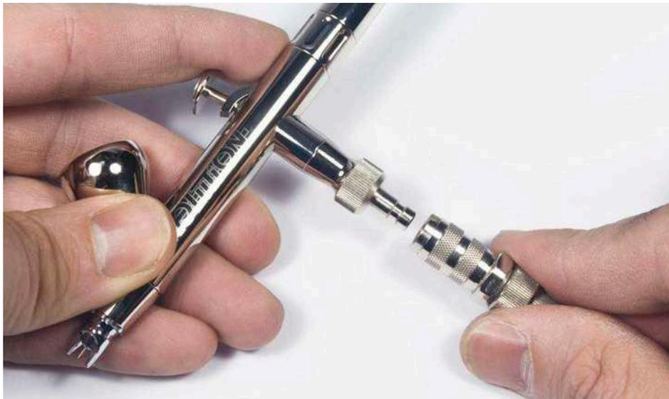
**11** Für einen schnellen Wechsel von Geräten ohne Druckverlust am Kompressor werden diese Schnellkupplungen empfohlen
