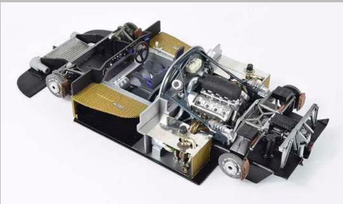
**10** Mit dem Aufsetzen des Cockpitmoduls auf den Unterboden des Saubers war der Bauabschnitt des Chassis schon abgeschlossen
