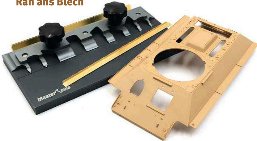
**5** Wer sich für die Zurüstsets von RFM entscheidet, muss unter anderem bei der Oberwanne die Kettenabdeckungen durch die fotogeätzten Versionen ersetzen. Mit einer Biegehilfe brachte der Autor das PE in Form
