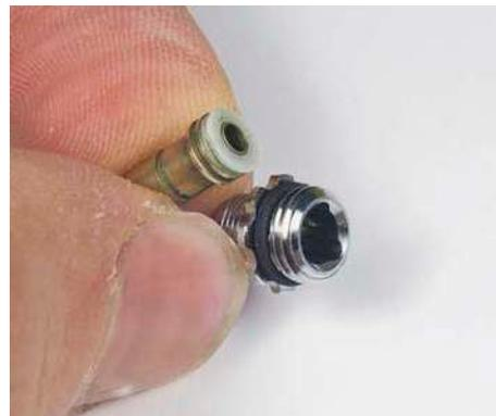
**8** Zahlreiche Gummidichtungen finden sich an Ventil und Düse. Diese können mit der Zeit porös werden
