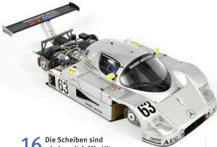
**16** Die Scheiben sind wieder mit A-Mig Ultra Glue eingeklebt. Der Scheibenwischer musste etwas gebogen werden, um der Kontur der Frontscheibe zu folgen
