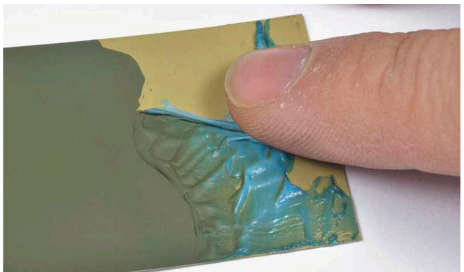
**46** Beim Entfernen der Maske ist darauf zu achten, dass keine feinen Details am Modell mit abgezogen werden
