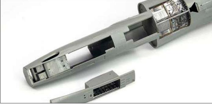
**9** Sind sämtliche Flächen verschliffen, montiert der Modellbauer die weiteren Bauteile in den Rumpf, beginnend mit der Unterseite
