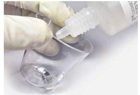
**12** Der erste Schritt ist die Wahl des korrekten Verdünners, der sogleich in einen kleinen Plastikbecher gefüllt wird
