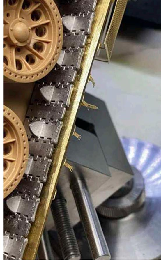
**12** Nach dem Verlöten schiff der Autor die Überstände mit einem Schleifkörper plan ab und so verblieb nichts außer einer perfekten Lötstelle
