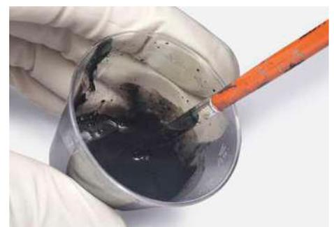
**14** Mit einem ausgedienten Pinsel wird alles vermischen. Es ist wichtig, dass beide Komponenten zu einer Flüssigkeit werden
