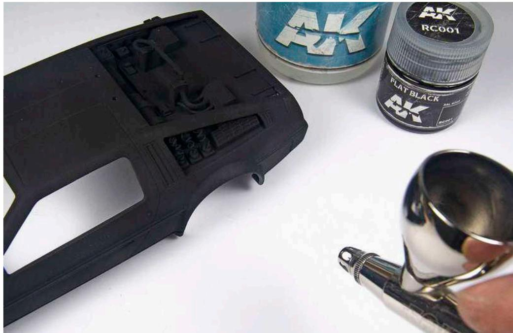
**22** Dieser Farbtyp lässt sich hervorragend mit der Airbrush verarbeiten und weist eine sehr hohe Deckkraft auf
