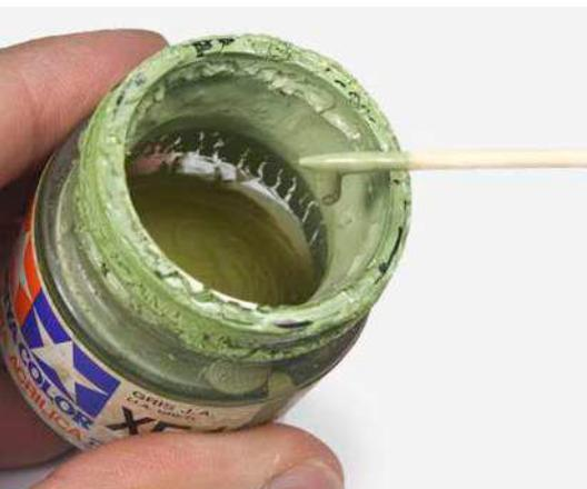
**21** Lacke, wie hier von Tamiya, haben eine dicke Konsistenz und müssen unbedingt mit dem passenden Verdüner angepasst werden
