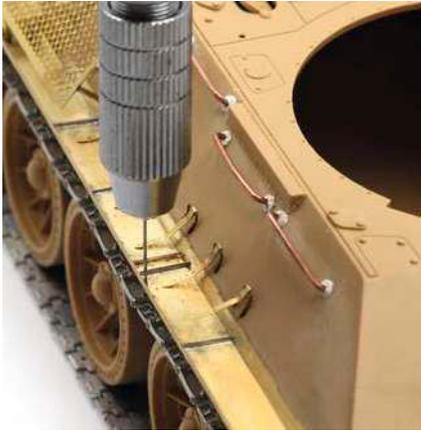
**10** Um mir den Bau zu vereinfachen, bohrte ich Löcher in die Kettenabdeckung, um die Drahtösen besser verlöten zu können
