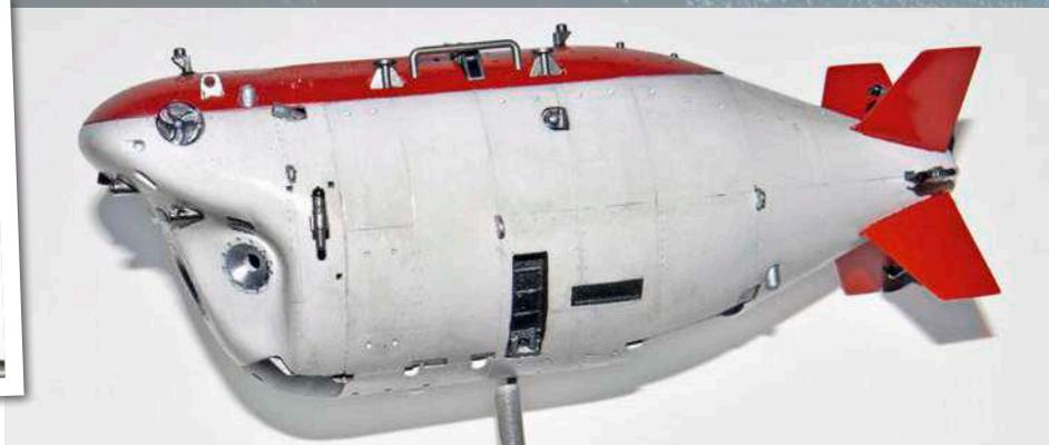
**13** Die vier nachdetaillierten Stabilisatoren sitzen zwischen den Heckmotoren. Farbe macht die Passungen zu knapp
