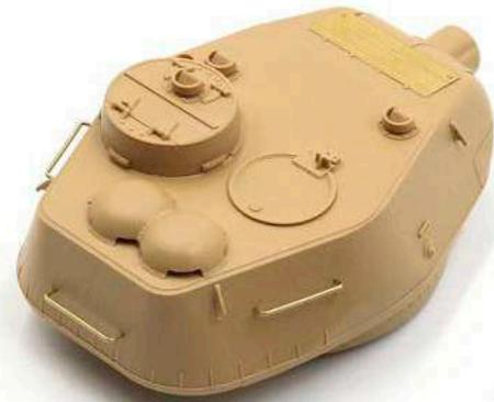
**14** Die Griffstangen am Turm sowie an der Wanne wurden aus Messing oder Kupfer nachgebildet. Für die Formung der Griffe half wieder eine spezielle Biegehilfe
