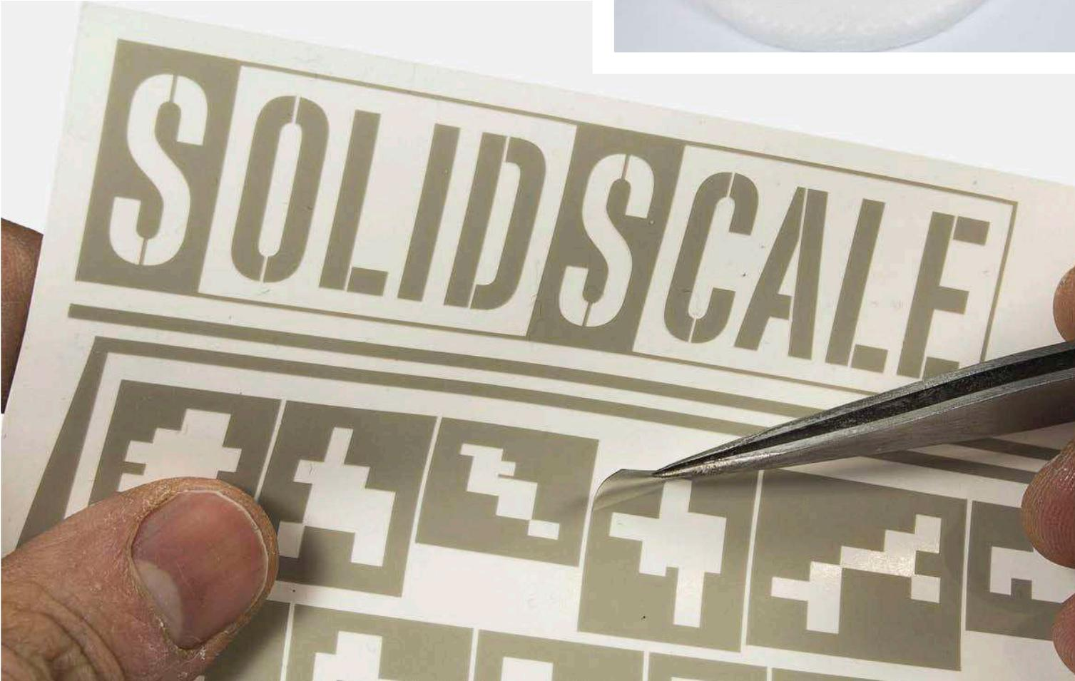
**33** Mit Pinzette und Silikonpinsel lassen sich diese Masken leicht auf der Oberfläche positionieren. Alle Seiten müssen gut anliegen
