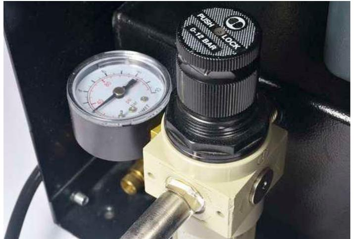
**10** Der Kompressor ist der Antrieb. Wasserabscheider, Druckbehälter und Druckregulator sind die hier wichtigsten Komponenten
