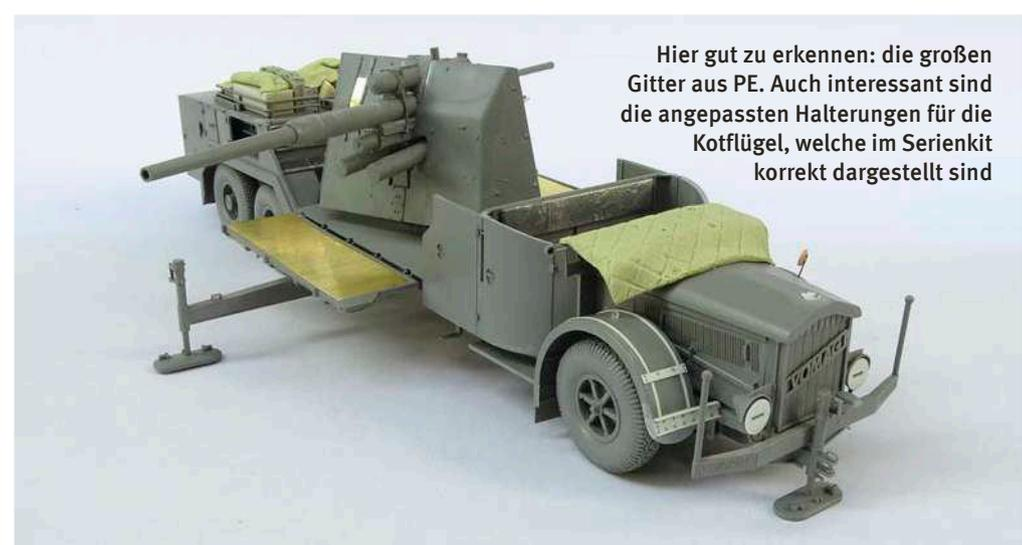
Hier gut zu erkennen: die großen Gitter aus PE. Auch interessant sind die angepassten Halterungen für die Kotflügel, welche im Serienkit korrekt dargestellt sind
