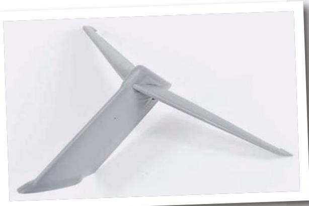
**4** Beim Leitwerk auf korrekte Geometrie achten, da die Bausatz-Passstifte diese nicht gewährleisten können
