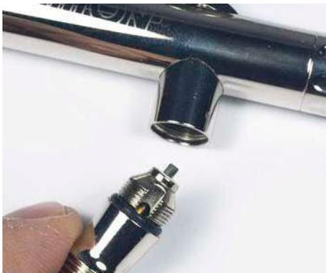
**7** Das Luftventil ist die Schnittstelle zwischen Airbrushpistole und Kompressor. Dieses Teil muss stets dicht sein
