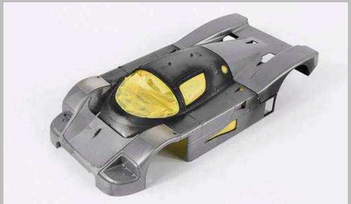
**11** Die Lackierung der Karosserie startet mit dem Innenraum in Schwarz, welcher dann vor der Außenlackierung abgeklebt werden musste
