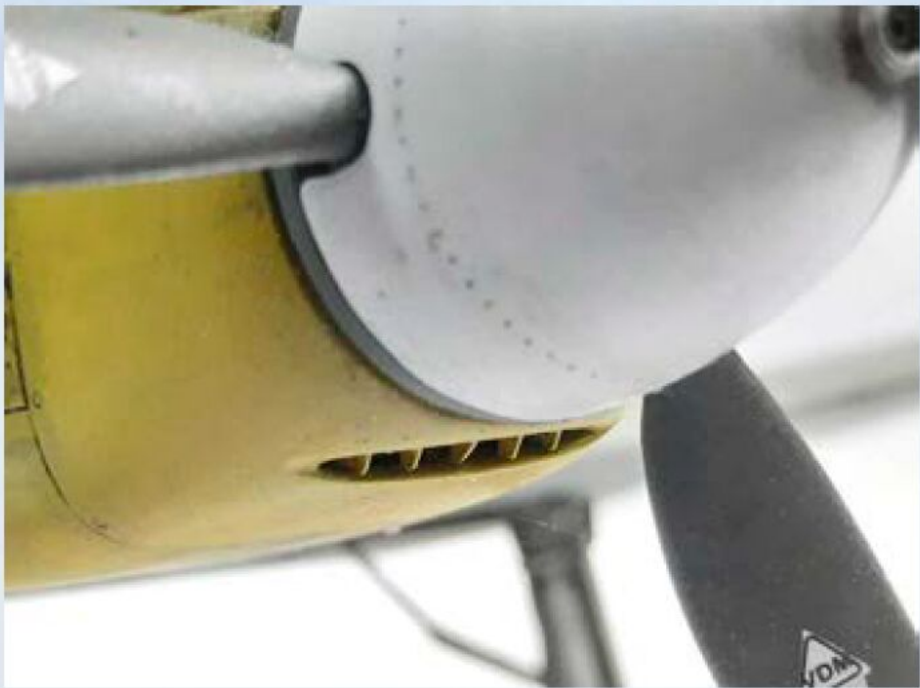
10 Mit nur wenig Aufwand lässt sich mit dünnem Sheet ein sehr überzeugender Lufteinlauf darstellen
