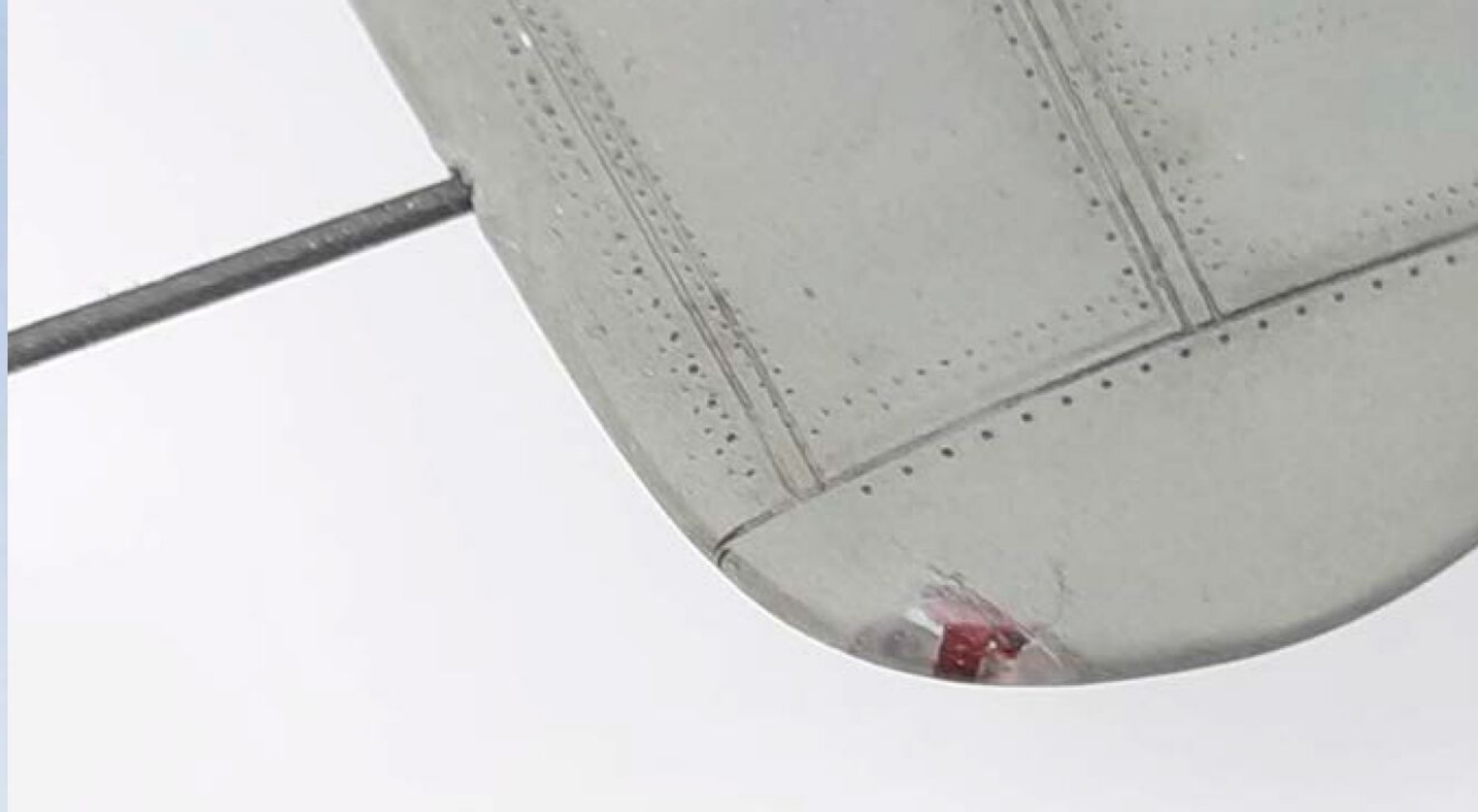
20 Die Positionsleuchten sind bemalt, verschliffen und auf Hochglanz poliert. Die Staudruckmesser sind aus Spritzenkanülen gemacht
