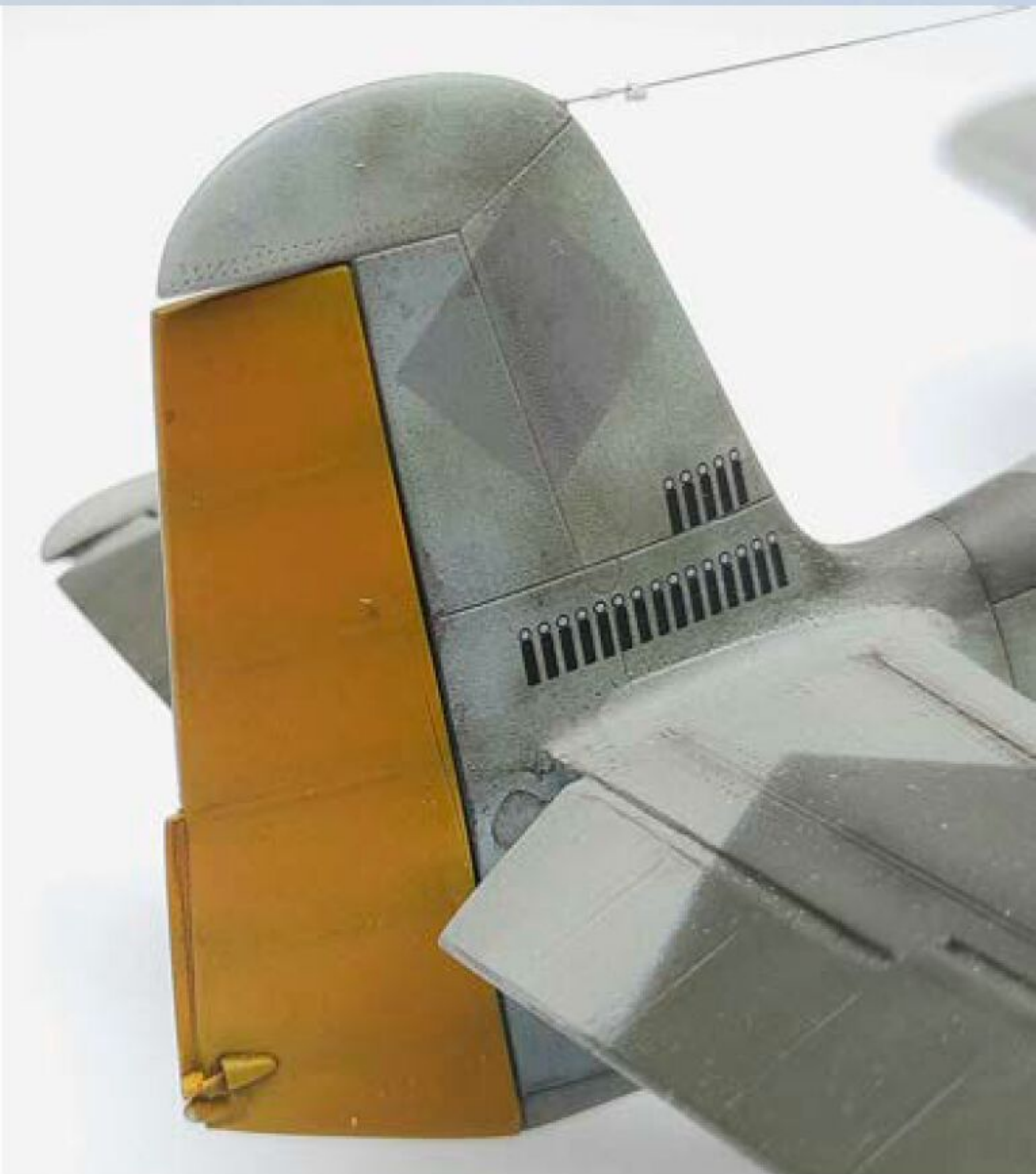
8 Trimmruder erhielten den Mechanismus aus Draht und Spitzen von Granaten. Am Seitenruder ist eins neu aus Sheet
