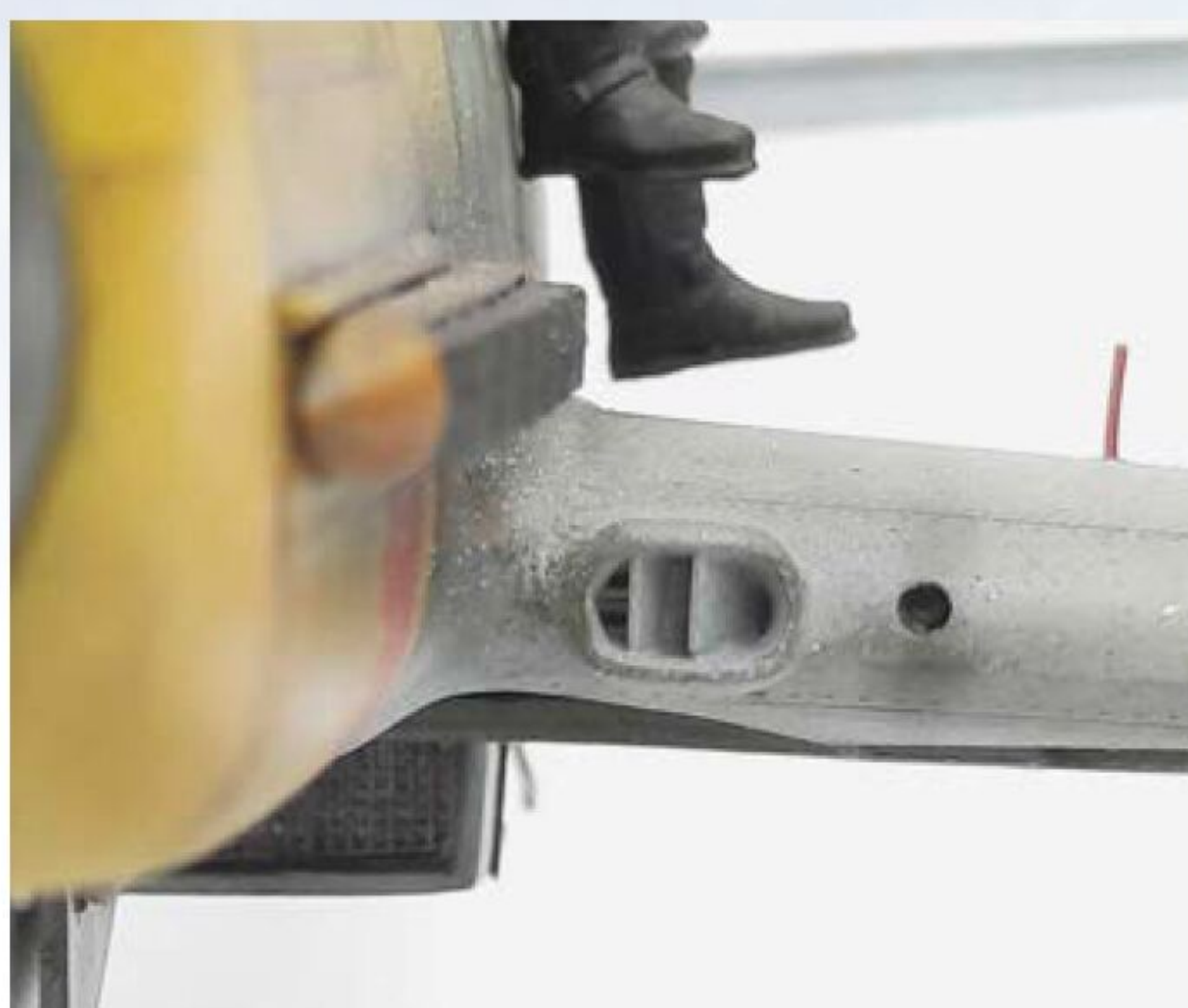
22 Der Lufteinlauf erhält zwei Lamellen aus dünnem Sheet. Schwer erkennbar ist das MG-Rohr (eine Spritzenkanüle)
