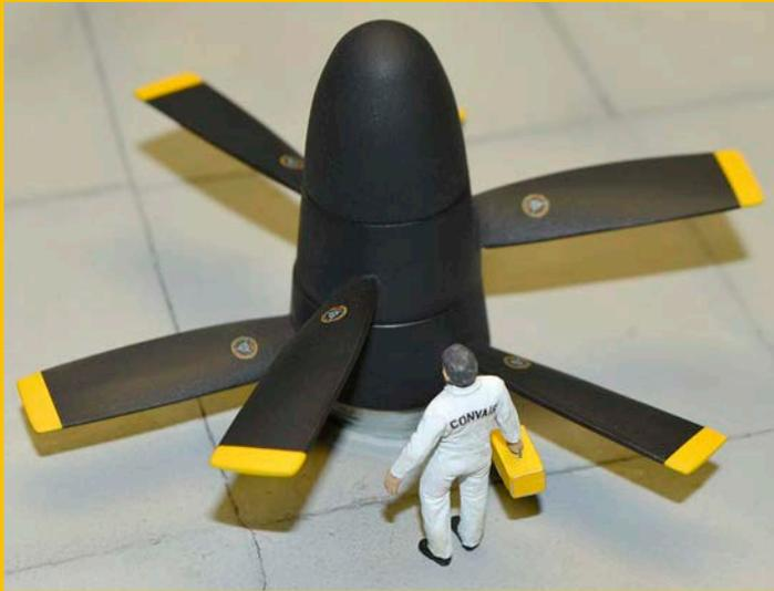
**11** In der voluminösen Spinnerhaube wäre bei späteren Serienmaschinen das Bordradar untergebracht worden
