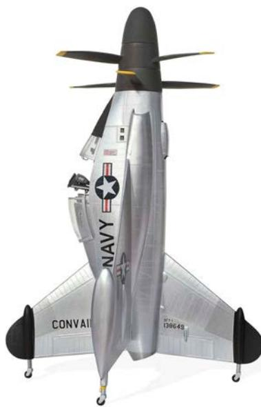
In der Seitenansicht ist erkennbar, dass das Cockpit über dem Zwillingstriebwerk und dem zugehörigen Propellergetriebe sitzt
