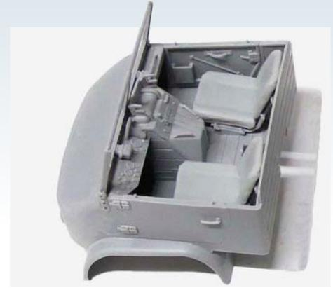
**2** Das Fahrerhaus war schlicht und nur mit dem Notwendigsten ausgestattet. Zur Arbeit am Motor konnte die hintere Abdeckung entfernt werden
