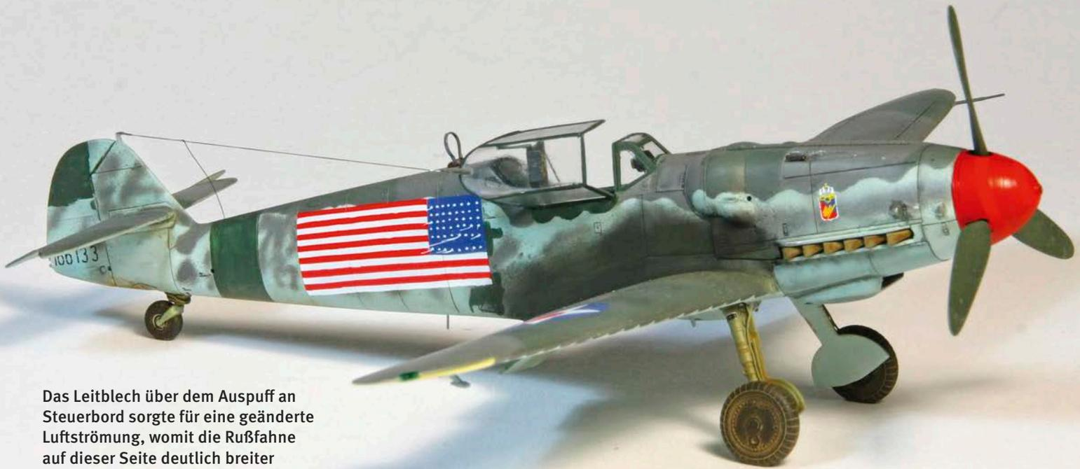
Das Leitblech über dem Auspuff an Steuerbord sorgte für eine geänderte Luftströmung, womit die Rußfahne auf dieser Seite deutlich breiter ausfiel als an Backbord
