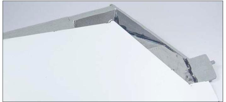
**4** Der hintere Teil des Gebäudes wird mit einer zugeschnittenen Platte aus Sheet bedeckt und somit verschlossen. Wieder kommt CA-Kleber zum Einsatz
