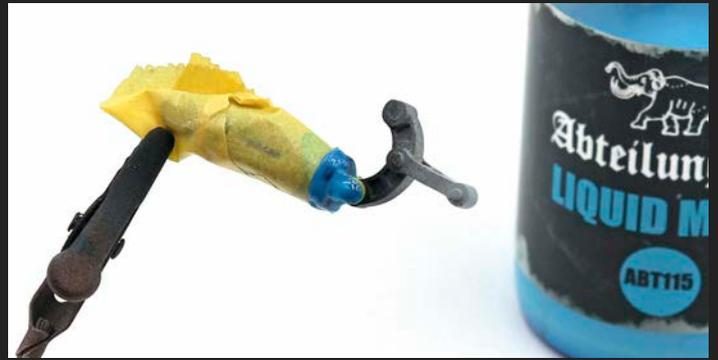
**13** Um die teilweise aufwendig geformten Teile zu maskieren, erwies sich die Liquid Mask von Abteilung 502 als sehr hilfreiche Unterstützung. Nach dem Trocken lässt sie sich einfach abziehen
