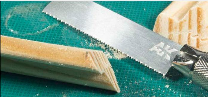
**11** Nun folgt der Zuschnitt auf Gehrung mittels Modellbausäge. Der Schnitt ist nicht perfekt, lässt sich aber ohne größeres Werkzeug durchführen
