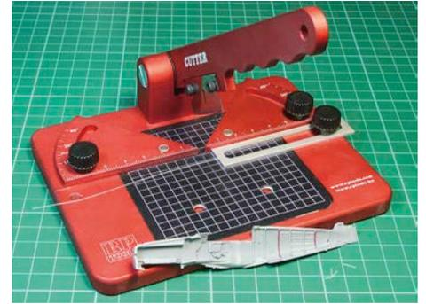
**2** Der Cutter von RP Toolz ist eine Hilfe. Hier schneidet er gleichmäßige Stringer für die sichtbare Innenstruktur
