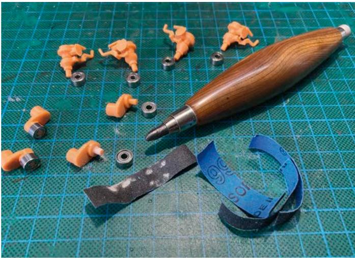
**4** Die Schwingarme der Mittelräder und die zusätzlich mit Umlenkgetriebe versehenen äußeren Räderpaare sind zur Aufnahme der Kugellager einzupassen
