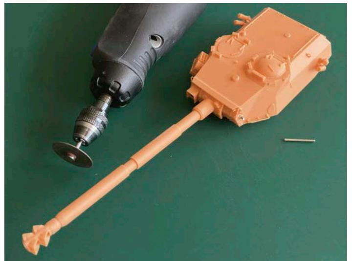
**7** Das Rohr wird mit einem Metallstab höhenbeweglich gestaltet und dieser sodann passgenau mit der Miniflex abgelängt
