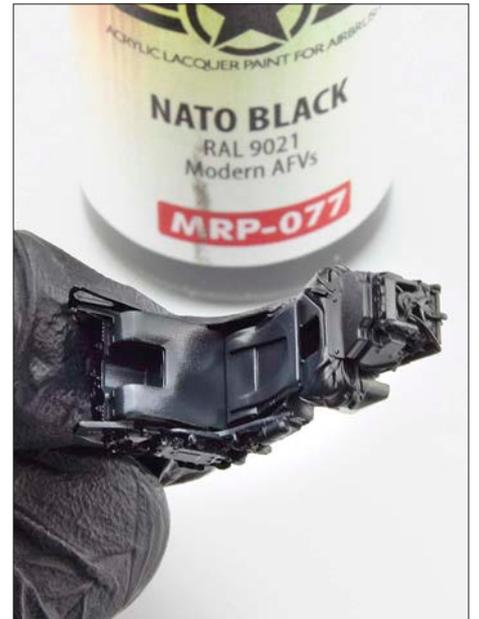
**7** Erste Lichter erhält man, indem die horizontalen Bereiche bereits mit einer leicht helleren Farbe lackiert werden. Die Voraussetzung von Druck und Düse/Nadel ist dabei identisch
