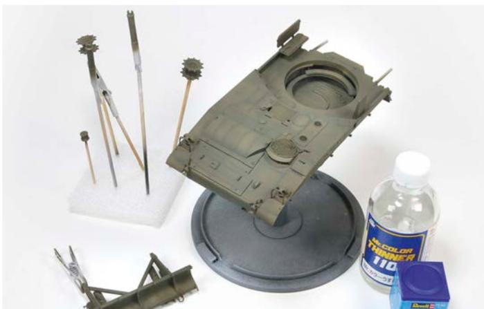
**10** In mehreren dünnen Schichten stellte der Modellbauer die Basislackierung mittels Airbrush und mit Mr. Color Thinner verdünnter Revell-42-Gelboliv-Farbe her
