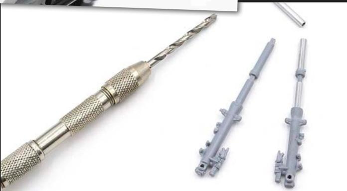
**14** Poliertes Metall lässt sich nur mit einer Möglichkeit am besten darstellen: mit poliertem Metall. Die Standrohre aus gedrehten Aluminiumrohren ersetzen die Teile aus Plastik
