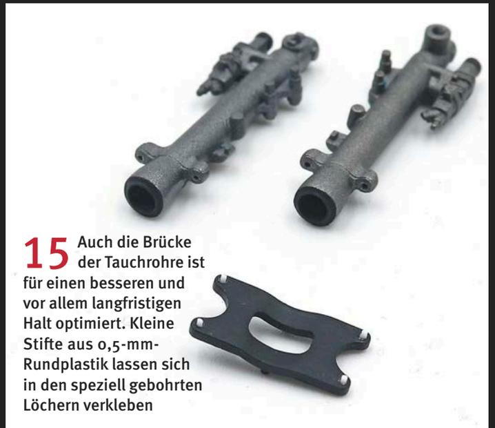
**15** Auch die Brücke der Tauchrohre ist für einen besseren und vor allem langfristigen Halt optimiert. Kleine Stifte aus 0,5-mm-Rundplastik lassen sich in den speziell gebohrten Löchern verkleben
