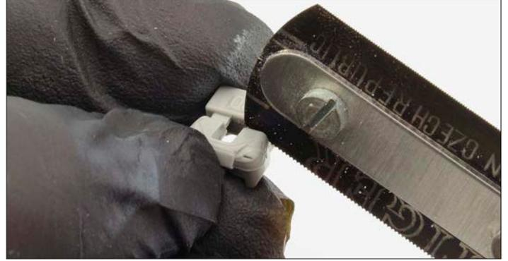
**2** Das Trennen der Brassinbauteile vom Sockel ist schnell mit einer geeigneten geätzten Säge umgesetzt. Vorsicht bei der Handhabung ist dennoch immer geboten
