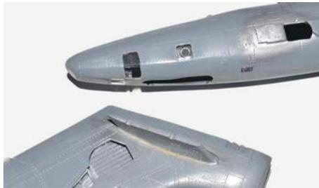
**17** Die dank Cyankleber bombenfesten Gläser standen leicht vor und sind so leicht separat plan und glatt zu arbeiten
