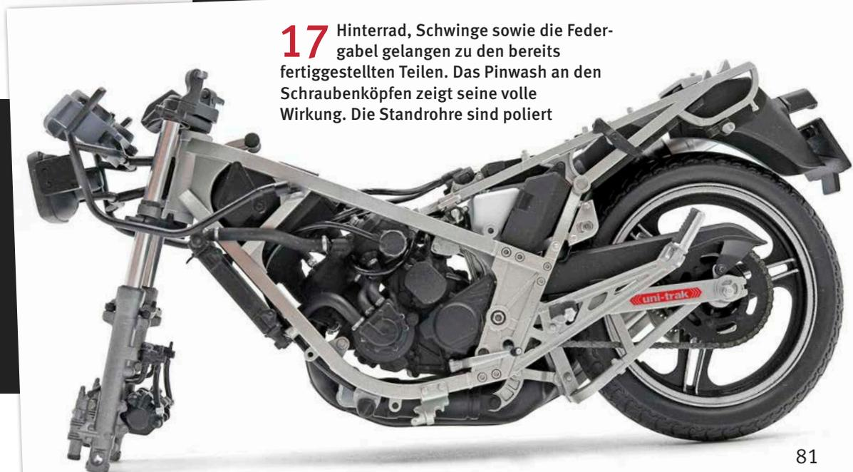
**17** Hinterrad, Schwinge sowie die Feder gabel gelangen zu den bereits fertiggestellten Teilen. Das Pinwash an den Schraubenköpfen zeigt seine volle Wirkung. Die Standrohre sind poliert
