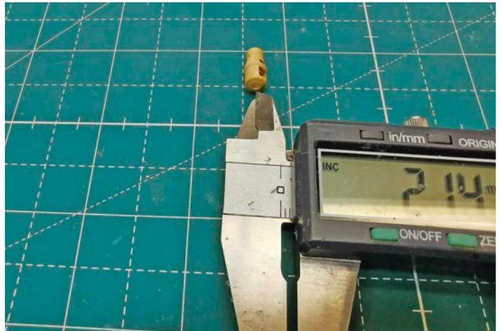
**4** Die Öffnung der Mündungsbremse war zu klein für das Kaliber 7,5 Zentimeter und musste entsprechend dem Maßstab 1:35 auf 2,14 Millimeter aufgebohrt werden
