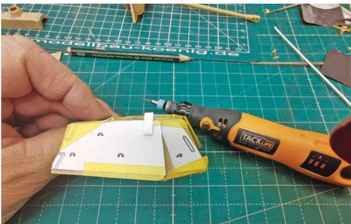
**5** Für die Ösen am Turm werden Löcher für den Draht gebohrt. Eine Kopie aus einer Zeichnung im Maßstab 1:35 half für die einfache Bestimmung
