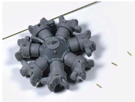
12 Kleine Zündkerzen aus Messingrohr in aufgebohrten Zylindern: So liegen sich die Zündkabel besser befestigen
