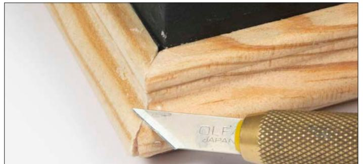
**14** Mit einem Messer werden alle Stöße nachbearbeitet und Reste von Weißleim entfernt. Hier ist zu erkennen, dass die Ecken verspachtelt werden müssen
