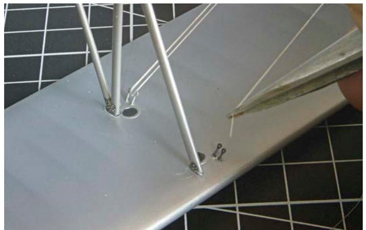
**26** Das Garn für eine leichte Spannung fünf Millimeter kürzen, dann per fixem Sekundenkleber am Spannschloss anbringen
