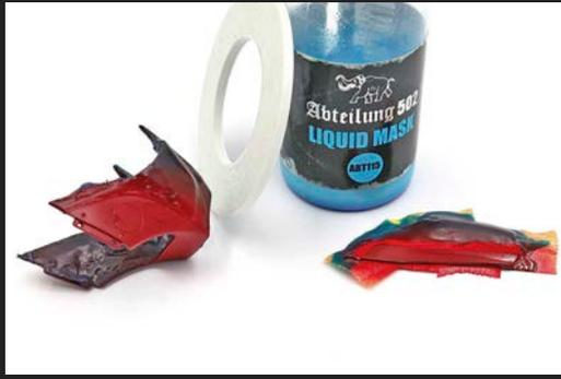
**19** Die mehrteiligen Decals zur zweifarbigen Darstellung kamen nicht infrage. Die entsprechenden Flächen wurden, ähnlich wie bei den Felgen, mit Masking Tape und Liquid Mask abgeklebt
