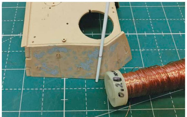
**6** Anschließend wird 0,2-mm-Kupferdraht über einen Rundstab gefädelt und im Turm verdrillt. Zuletzt fixiert der Modellbauer das Ganze mit Sekundenkleber
