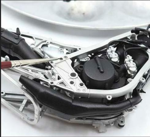
**4** Die Rahmenteile und der Motor wurden miteinander verklebt. Es folgten die ersten Komponenten der Auspuffanlage samt Wash, um die Vertiefungen der Verschraubungen hervorzuheben
