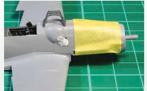
**4** Hier die Motorverkleidung mit einer weiteren Beule, die im Bausatz fehlt und nach Fotos scratch nachgebildet ist
