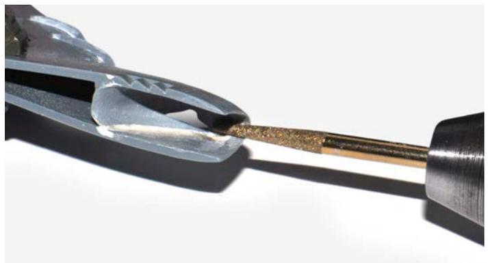
**8** Die Luftenläufe sind bis zum Triebwerk einsehbar und werden, detailgetreu gerundet, geschliffen ausgeführt
