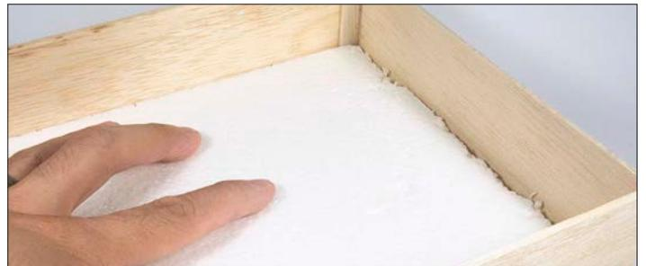
**8** Um die erste Platte herum kommen Wände aus Balsaholz. Beide Komponenten lassen sich mit Weißleim verkleben. Kleine Leisten aus Balsa verstärken die Stöße
