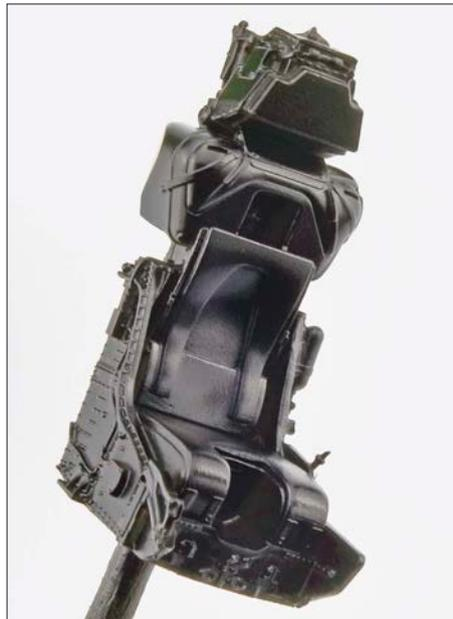
**6** Grundiert wird das Ganze in der Grundfarbe des Schleudersitzes und mit einem Arbeitsdruck von etwa 1,2 bar und einer 0,4 Millimeter großen Nadel/Düse
