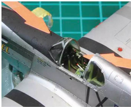
1 Das vordere Gegenstück des Hilfsviers ist der Kornstachel vor der Panzerscheibe
