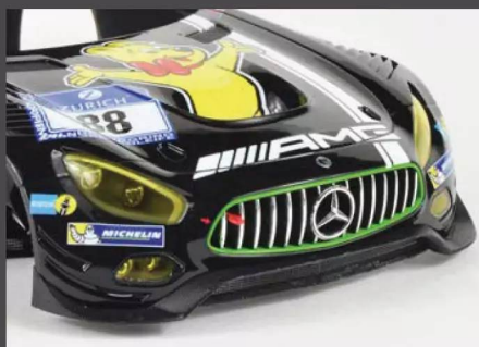
15 Zunächst sind die Scheinwerfer mit den für die GT3-Klasse beim 24-Stunden-Rennen auf dem Nürburgring typischen gelben Gläsern einzusetzen. Danach folgt der Kühlergrill
