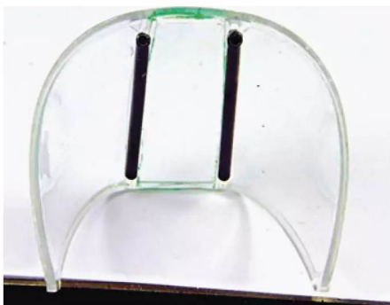
15 Die Belüftung für den Piloten entstand aus schwarzen Röhrchen an den Innenstreben der Frontscheibe
