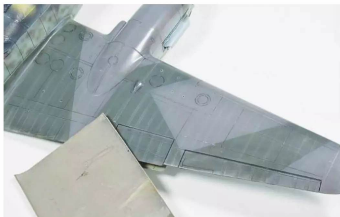
21 Durch Polieren erscheinen die Nietreihen dezent sichtbar, wobei der Effekt nach mattem Klarlack schwindet
