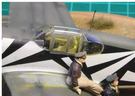
5 Dieser andere P-51A-Aufklärer des Autors zeigt neben dem Einbau der K-22-Kamera auch ein ausgestellttes Seitenfenster
