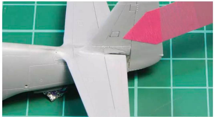
14 ... auch weil die Klebekante der Seitenflossen vorne nicht dem originalen Blechstoß folgt und Verschraubungen fehlen
