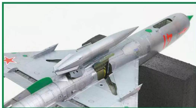
17 Erst der Tank, dann die Fahrwerksklappen. Jetzt ist der beste Zeitpunkt für die Hydraulikzylinder der Klappen
