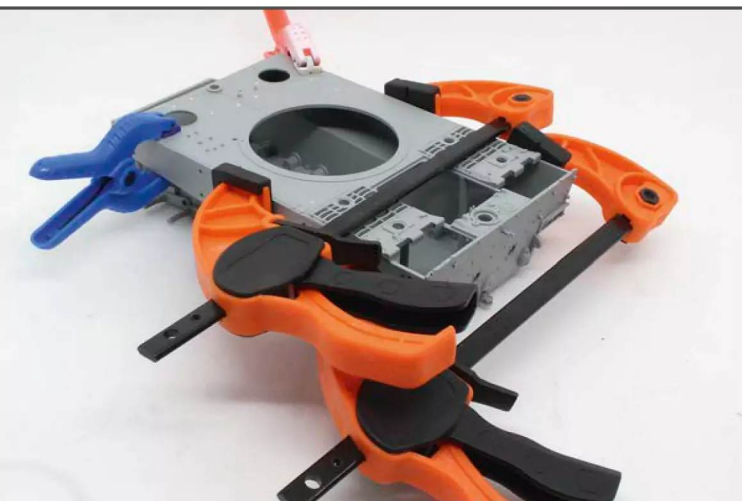
1 Um Spalten beim Verkleben zu vermeiden, werden Ober- und Unterwanne mittels Klemmzwingen zwangsverheiratet
