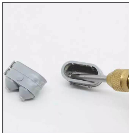
5 Mit einem Fräser lässt sich die Wandstärken auf Papierdicke ausdünnen. Anschließend kann man die Filter perfekt beschädigen
