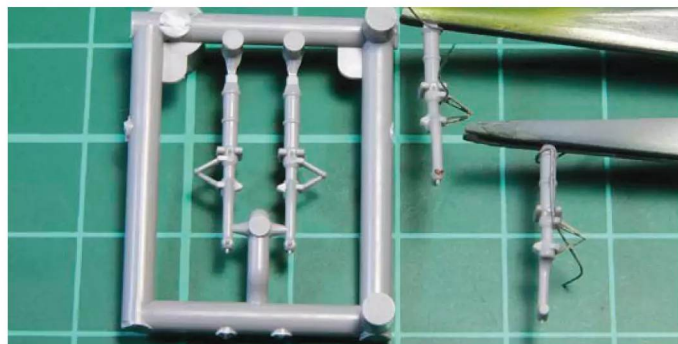
28 Die technischen Merkmale der Federstreben sind bereits am richtigen Platz, daher fehlt „nur“ die Bremsleitung
