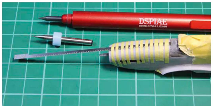
16 Nach der Gravur des Blechstoßes: An den Endpunkten der fehlenden Schnellverschlüsse ist ein Nietlineal drahtfixiert
