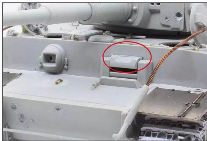
3 Ab Februar 1943 entfiel das K.F.F. 2. Gemeint sind die kleinen Löcher über der Panzerklappe des Fahrersichtblocks
