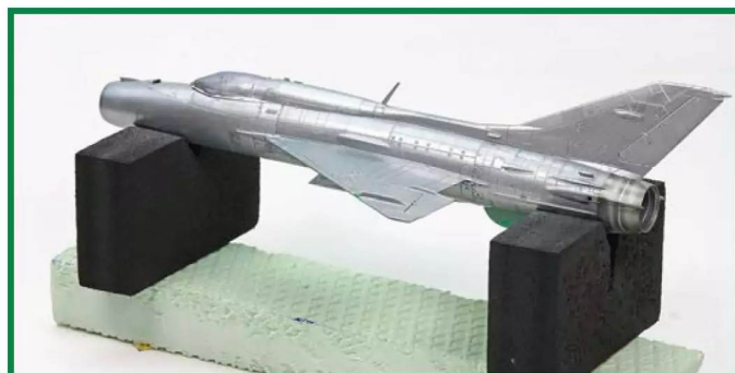
13 Wichtig ist das Absetzen der Flächen. Hellings aus Styrodur und Moosgummi sind schnell gebaut
