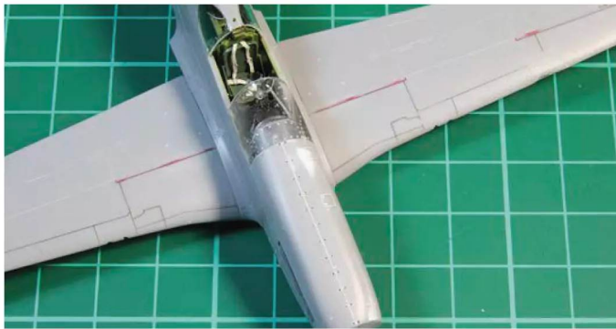
17 Zwei parallele Reihen mit je zwölf Schnellverschlüssen im gleichen Abstand sehr nahe an der Gravur: Geduld ist gefragt
