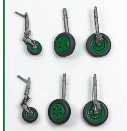
11 Die Fahrwerke mit Ätzteilen. Die Resinräder (oben) unterscheiden sich durch die Abplattung und die Profilrillen
