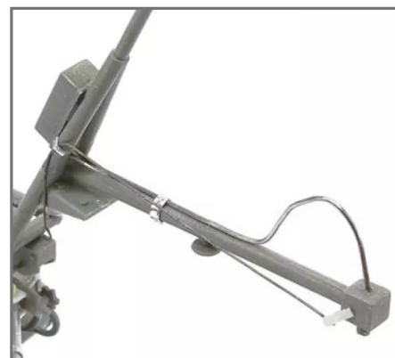
14 Auch an dem oberen Ausleger fehlen eine Leitung sowie die Notentriegelung – hier aus Bleidraht ergänzt
