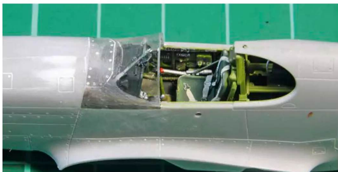
15 Das Bauteil T1 mit Windschutz und Wartungsblechen fluchtete nicht einwandfrei und forderte Nacharbeit
