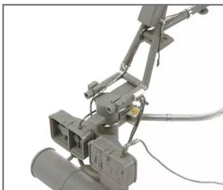
11 Der seitliche Ausleger, neu aus Aluminiumrohr. Er führt an einen Zugang hinten unten an die V1
