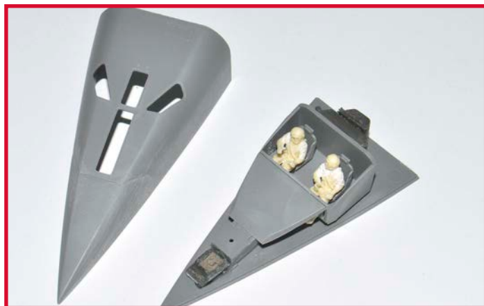
4 Das Cockpit und die Nase beinhalten nun Gewichte, sicherheits-halber so viel, wie hineinpasst
