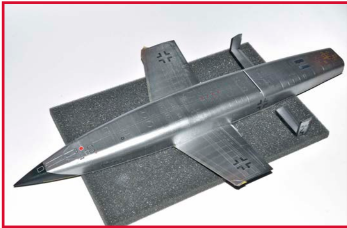
16 Das vorgefertigte Leitwerk kommt erst zum Schluss, da es sonst abbruchgefährdet ist
