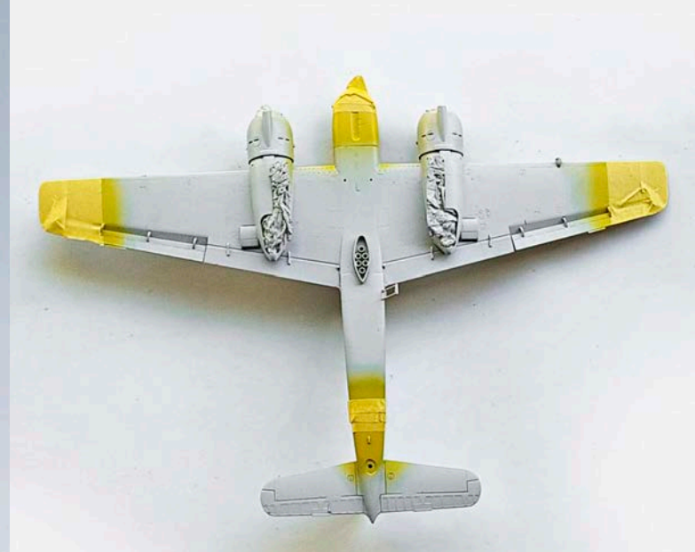
16 Auch die Tragflächenenden auf der Unterseite waren gelb lackiert, abgeklebt für den nächsten Schritt
