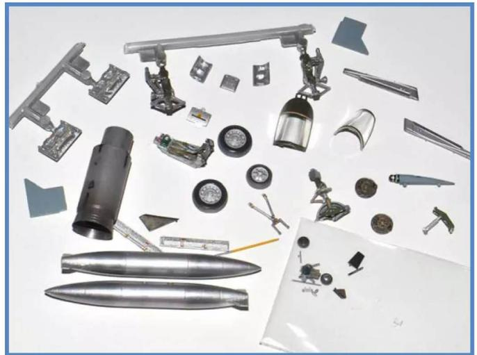
**21** Die superdetaillierten Teile dürfen beim Einbau nicht beschädigt werden: Deshalb vorher trockenproben!
