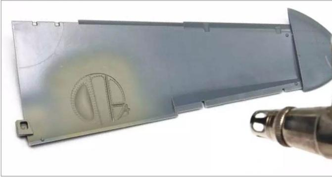
**1** Begonnen wird mit der Lackierung der Fahrwerksschächte in RLM 02 von fertig verdünnten Mr.-Paint-Farben
