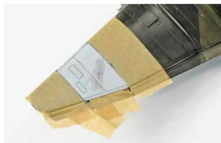
**14** Der Schaden ist auf zwei Paneele begrenzt. Diese werden exakt abgeklebt. So entsteht keine Stufe in der Lackierung. Sauber ausschleifen
