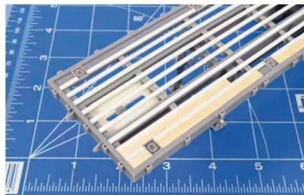
**12** Echte Holzbeplankung, umgesetzt mithilfe von einem ein Millimeter starkem Balsaholz. Doppel-T-Profile von Evergreen verstärken den Boden der Pritsche
