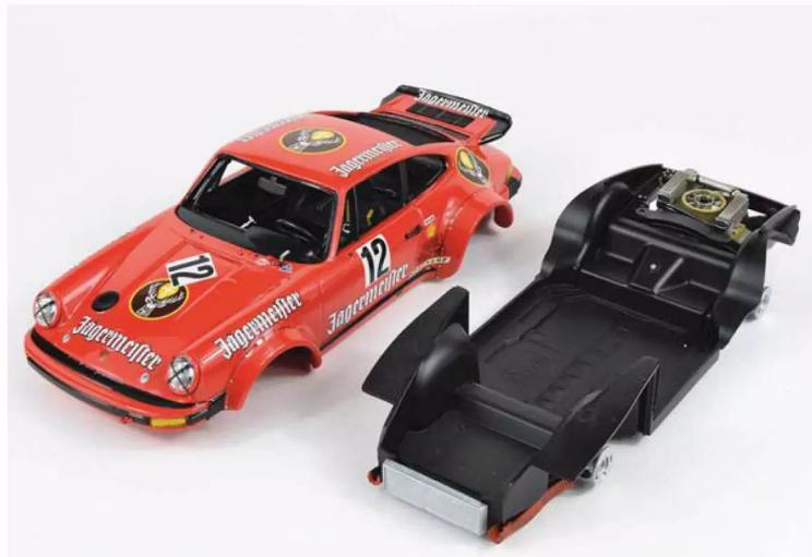
**16** Danach muss der Innenraum an vier stabilen Verbindungspunkten ebenfalls mit der Karosserie verklebt werden
