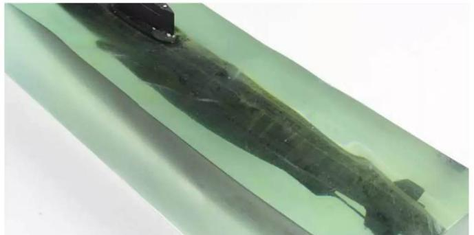
**9** Die Backbordseite ist plan geschliffen und mattiert, während die Oberfläche mittels 12000-Nassschleifpapier fertig poliert ist
