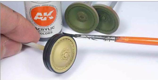
**13** Die Gummibandagen der Laufrollen werden einfach per Hand mit dem Pinsel und dunklem Grau lackiert
