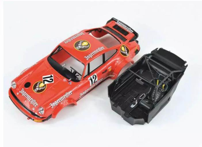
**15** Das fertige Armaturenbrett wird nicht mit dem Innenraummodul, sondern mit der Karosserie verklebt
