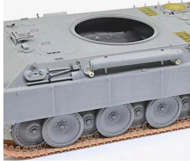
**3** Zahlreiche Details aus dem 3D-Drucker und die Aufnahmepunkte der Brückenteile aus Resin von PanzerArt sind hier verbaut
