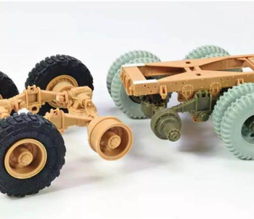
**1** Die Pendelachse wird ausgetauscht, um den Truck auf die A1-Version zurückzubauen. Als Ersatz dient eine M54-Achse von AFV Club
