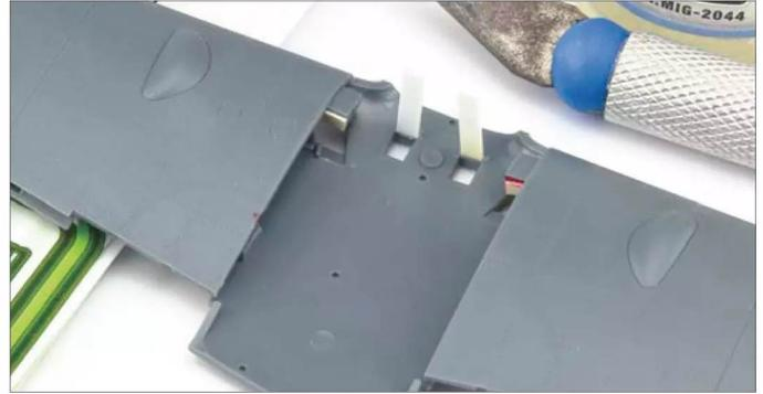
**10** Die Hülsen-Auswurfkanäle fehlen komplett, sind aber rasch mittels Plasticsheet ergänzt
