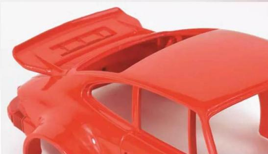
**9** Die bewegliche Heckklappe des Modells ist fest verklebt, da die notwendigen Scharniere durch die Heckscheibe zu sehen wären
