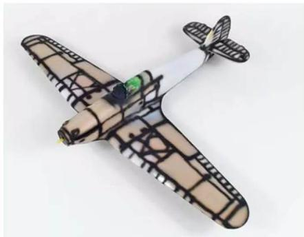
**10** Die Hurricane hatte hinten einen stoffbespannten Rumpf. Dies muss man beim Preshading berücksichtigen
