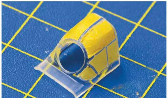
**7** An den freigeschnittenen Rahmen das Tape entfernen. Übrig bleiben die exakt abgedeckten Scheiben und das Bauteil ist lackierfähig
