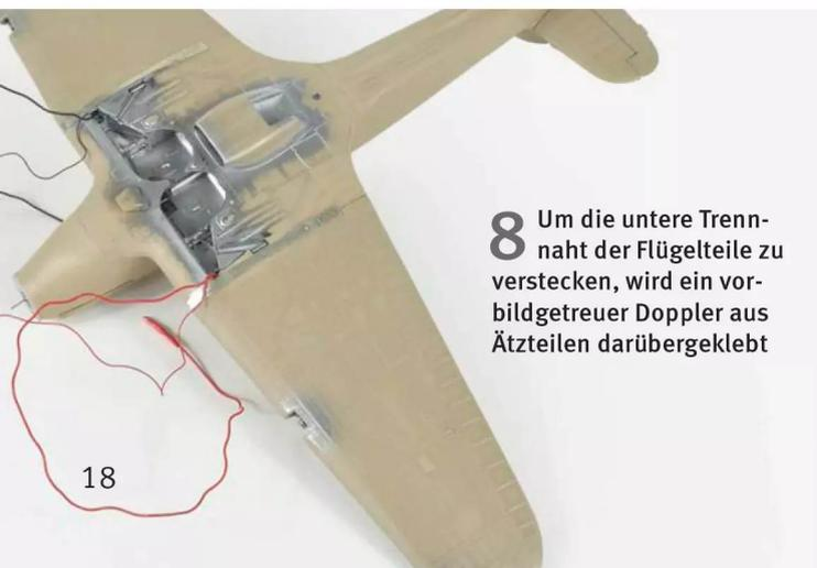
**8** Um die untere Trennnaht der Flügelteile zu verstecken, wird ein vorbildgetreuer Doppler aus Ätzteilen darübergeklebt
