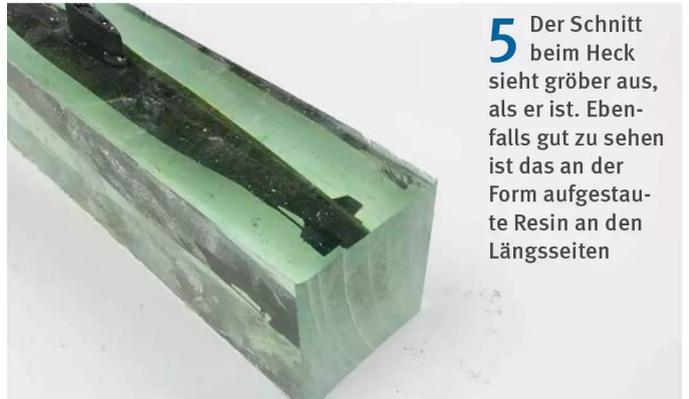
**5** Der Schnitt beim Heck sieht gröber aus, als er ist. Ebenfalls gut zu sehen ist das an der Form aufgestaute Resin an den Längsseiten
