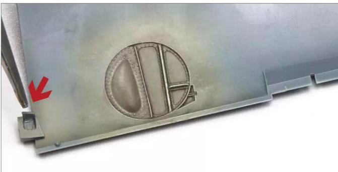
**7** Der nun lose hintere Steg kann mithilfe einer Flachzange entfernt und anschließend entgratet werden
