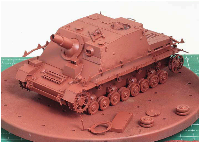
7 Eine Grundierung in Oxidrot sollte immer der erste Schritt sein – ideal auch für die Haarspray-Chipping-Technik
