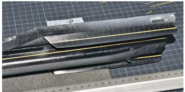
16 Der Wasserpass in dunkelschwarzem Ton wird vorlackiert und exakt mit auf ein Millimeter Breite geschnittenem Band maskiert
