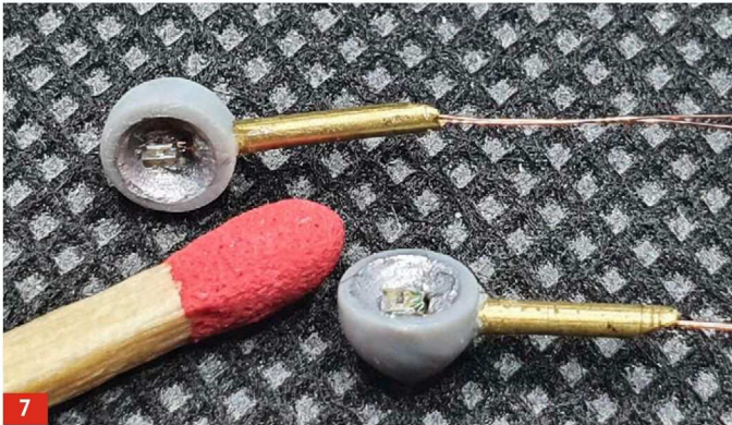
7 Die Bugscheinwerfer wurden aufgebohrt, eine Messinghülse eingesetzt, je eine SMD-LED installiert und verkabelt
