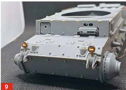
9 Das Installieren der Frontscheinwerfer gestaltete sich schwierig, da der exakte Winkel zur Bugplatte gefunden werden musste
