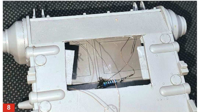
8 Durch einen Ausschnitt im Wannenboden sind die Kabel der Scheinwerfer verlötet. Der Ausschnitt wird wieder verschlossen
