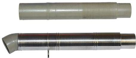
**21** Das serienmäßige Abgasrohr ist durch ein selbst gefertigtes Drehteil aus Alu ersetzt (unten)
