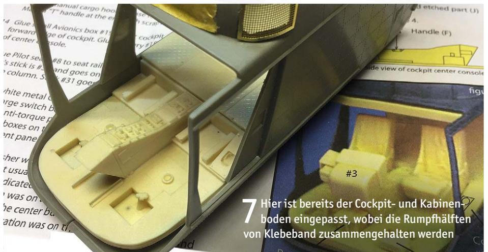
**7** Hier ist bereits der Cockpit- und Kabinenboden eingepasst, wobei die Rumpfhälften von Klebeband zusammengehalten werden
