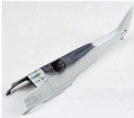
**10** Wichtig: Beim Verkleben des Rumpfes sollte die Einheit aus Baustufe 9 (Teile F46 und F47) gleich mit verklebt werden
