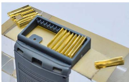
**10** Ein häufiges Problem beim Biegen und Korrigieren: Das Maß für die Biegung ist so, dass das Ätzteil leicht brechen kann
