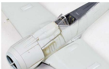
**17** Mit dem Verschleifen der Klebenähte und dem Einbau der Frontscheibe war der Bauabschnitt der Focke-Wulf abgeschlossen
