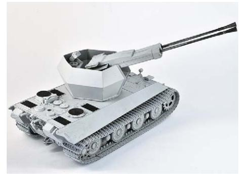
Auf einem Panther-II-Fahrgestell mit E-50-Ketten befindet sich passgenau eine 5,5-cm-Zwillingsflak Ger. 58 im Drehturm
