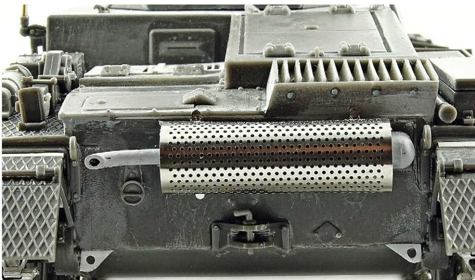
**13** Am Heck fällt der geänderte Lüfter aus dem Umbausatz auf. An der Unterseite der Wanne sind kleine zusätzliche Verstärkungen angebracht worden
