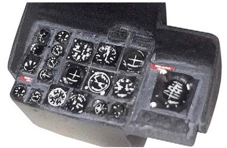
**14** Das Instrumentenbrett nach dem Lackieren mit selbst gedruckten Instrumenten-Decals und Beschriftungen
