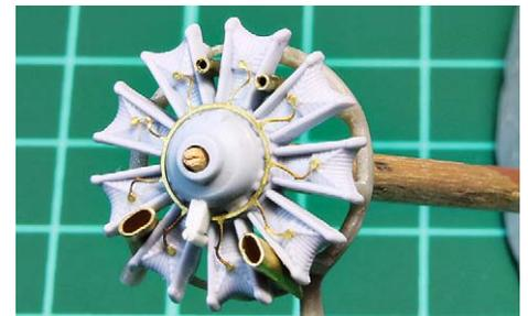
**14** Ergänzungen am Airfix-Triebwerk: Ölpumpe unten, Lufteinläufe für Motorluft oben und Ölkühler seitlich
