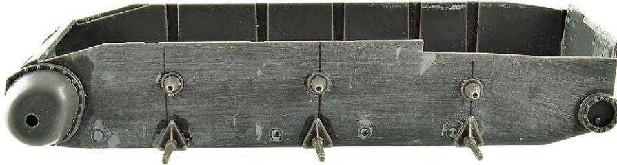
**2** Die umgebaute Wanne, nachdem alle Details entfernt und die neuen Aufnahmen für das Laufwerk montiert sind
