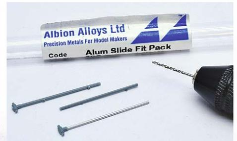
**13** Für das metallische Aussehen der Hydraulikstangen kann man sehr gut ein poliertes Alurohr (hier von Albion Alloys) einsetzen
