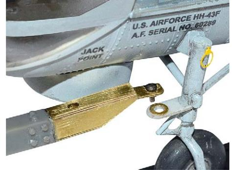
**28** Die modifizierte Zugstange und die Ösen im Rohbau. Als Verbindungsbolzen dienen gekürzte Stecknadeln
