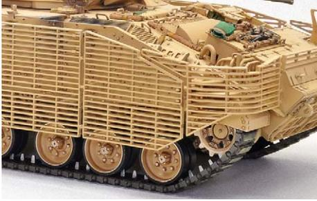
**1** Die Gitter-Zusatzpanzerung ist in Spritzguss sicher eine Herausforderung, da die Streben relativ dick ausfallen
