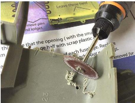
**5** Für die Superset-Innenverkleidung müssen an den serienmäßigen Rumpfhälften Passstifte und Stufen entfernt werden
