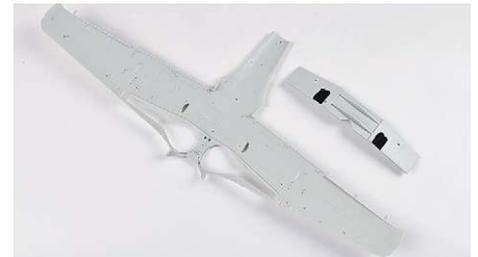
**11** Durch den modularen Aufbau müssen die Löcher der „Sturmböcke“ in die Tragfläche gebohrt werden. Das Bauteil F49 versteift
