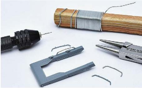
**4** Bei den Kleinteilen und Griffen besteht Bruchgefahr. Die Haltestangen entstehen hier aus 0,6-mm-Lumendraht neu
