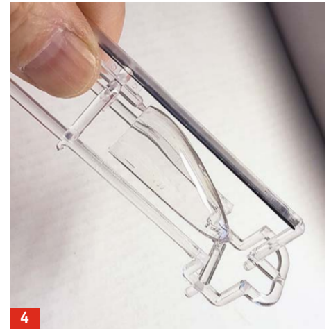
4 Die glasklare Cockpithaube ist vorteilhaft von einem Spritzrahmen umgeben, welcher als Schutz für die Gleitschiene dient
