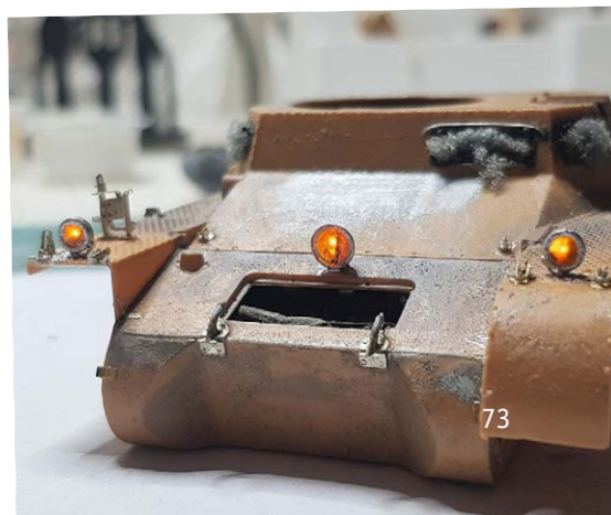
9 Die drei Frontscheinwerfer erhielten je eine SMD, ansteuerbar durch die Schalter auf der Dioramen-Rückseite
