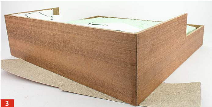
3 Der Sockelrahmen wird nach der Verschraubung der einzelnen Elemente mit Furnier überklebt. Der Autor verwendet hier Mahagoni
