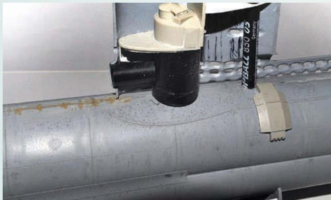
Bei einem Spantenabstand von meist 50 Zentimetern hatten auch die Boote vom Typ XXIII Wellen und Dellen schon ab Werft vom Schweißen und Verarbeiten
