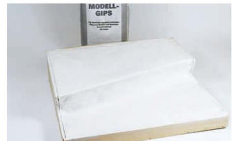
**2** Unter dem aufgetragenen Modellgips befindet sich ein blauer Styrodur-Kern. Diesen mit dem Messer grob in Form schneiden
