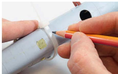
**12** Kabelbinder eignen sich hervorragend als flexibles und verschiebbares Lineal zum Anzeichnen der Nietverläufe
