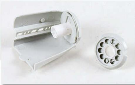
**5** Für die Elektromotoren braucht es eine passende Halterung in der Gondel. Hierbei ist auf eine zentrische Ausrichtung zu achten
