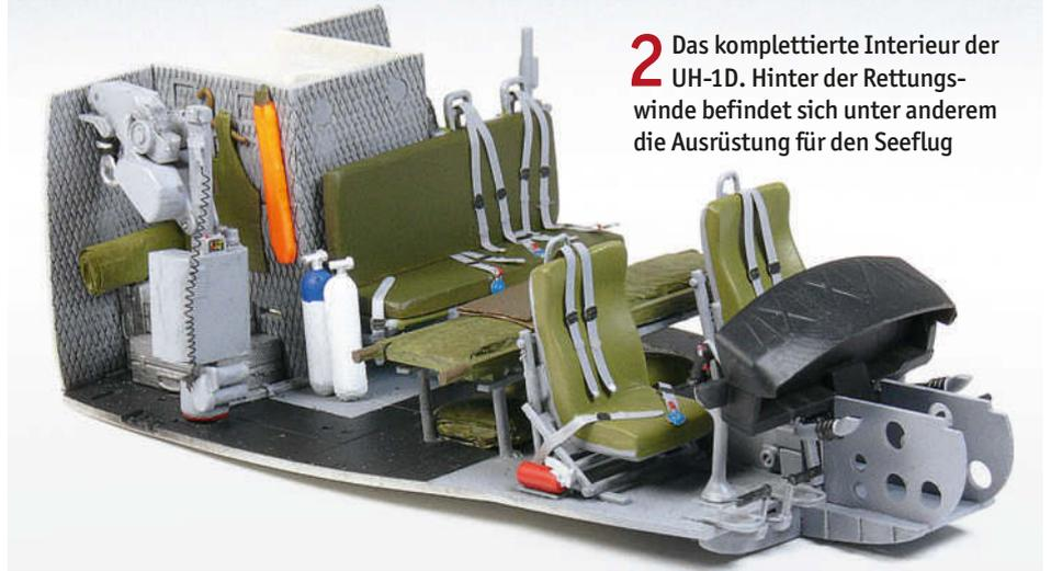
**2** Das komplettierte Interieur der UH-1D. Hinter der Rettungswinde befindet sich unter anderem die Ausrüstung für den Seeflug
