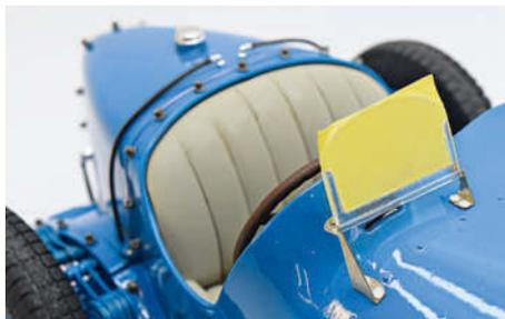
**21** Die geätzte Halterung für die Windschutzscheibe ist fertiggestellt, die Scheibe selbst für die Lackierung abgeklebt
