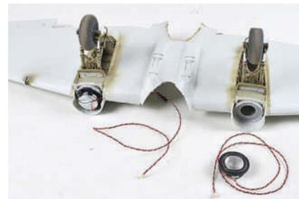
**9** Die beiden Lautsprecher des Elektroniksets werden mit einer Halterung zum Einkleben geliefert
