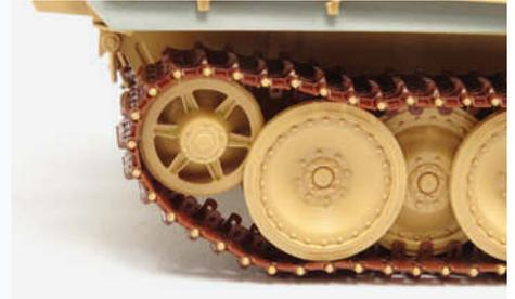
**10** Das zu diesem Zeitpunkt noch nicht befestigte Leitrad ermöglicht später das Spannen der dem Kit beiliegenden Gleisketten
