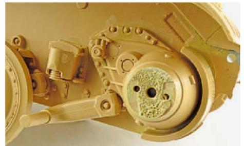
**12** Kleine Korrektur, große Wirkung: Nachdem das sowieso nicht sichtbare Teil N12 entfernt ist, passt alles andere genau
