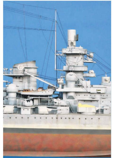
**24** Noch ein zu spät entdeckter Fehler: Die vom Masttop schräg nach vorne laufenden Wanten verhindern die volle Umdrehung des Entfernungsmessers
