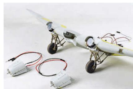
**10** Für die Motor-gondeln ist die Klebfläche sehr klein. Sie mit Plas-tiksheets zu vergrößern, erhöht auch die Stabilität
