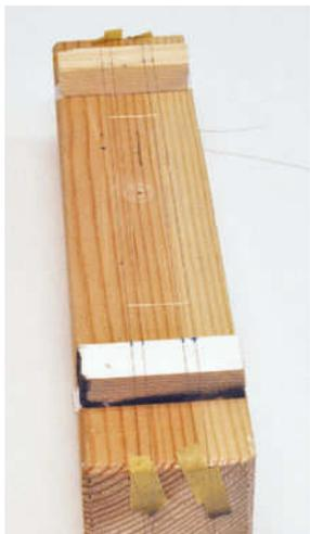
**25** Auf der Bauhilfe werden vier Stücke Fliegen-Bindegarn aufgespannt. Quer darüber sind zwei Stücke von 0,2-mm-Gitarrenseiten festgeklebt
