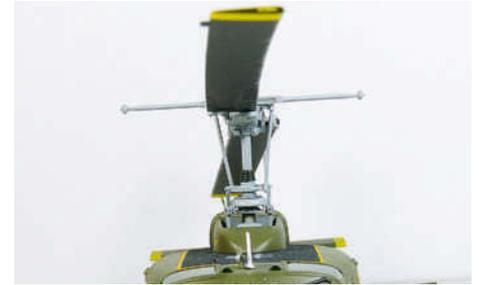
**13** Am Rotormast sind die äußeren Steuerstangen unten nach außen versetzt. Die Optik entspricht nun eher dem Vorbild
