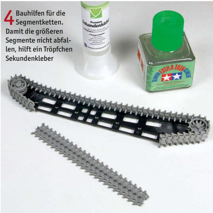
**4** Bauhilfen für die Segmentketten. Damit die größeren Segmente nicht abfallen, hilft ein Tröpfchen Sekundenkleber
