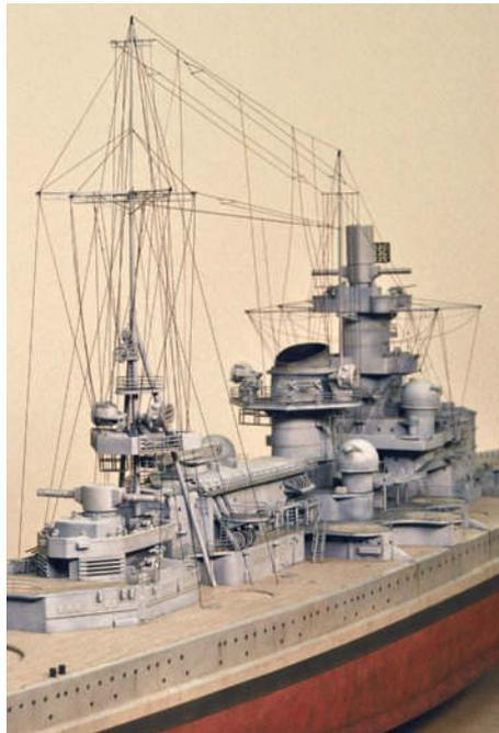
**23** Die aufwendige Takelage erhöht den Detaileindruck des Modells deutlich. Man bemerke, dass man die Geschütztürme erst nach dem Takeln montiert hat
