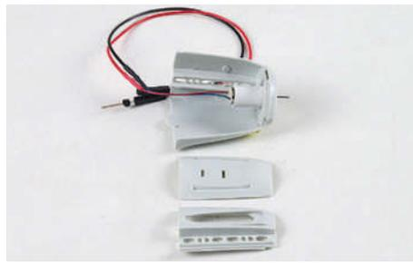
**6** Der Motor für die drehenden Propeller wird mit Sekundenkleber in die Halterung aus einem Evergreen-Plastikrohr geklebt
