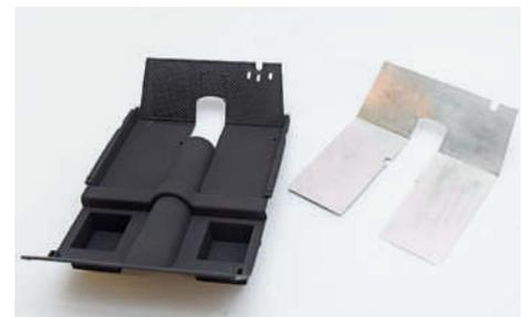
**13** Aus dünnem Aluminiumblech entsteht der Fußboden-Einsatz. Vorlagen zu dieser Änderung lieferte wieder das Internet
