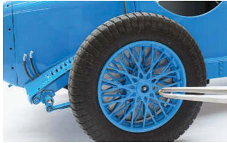
**16** Mit je einer beiliegenden winzigen Mutter lassen sich auch die Felgen mit Reifen auf den Achsen stabil montieren
