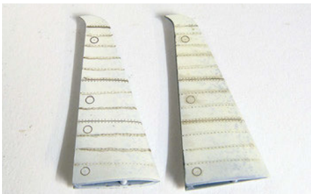
17 Das Washing: Mit in Feuerzeugbenzin getränktem Ohrstäbchen nimmt man die überschüssige Farbe ab
