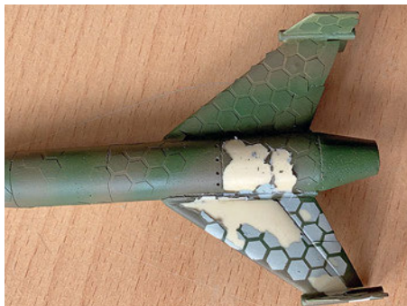
Massiver Rückschlag: Die äußerst unzureichende Haftung der Grundierung auf der Modelloberfläche verhindert dies jedoch
