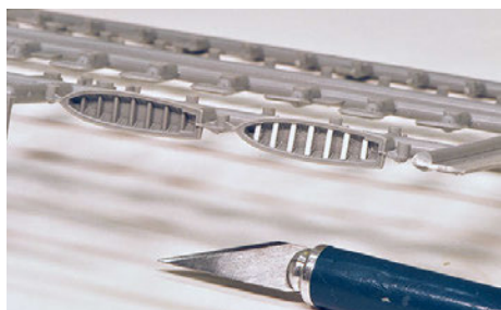
13 ... Kuttern, die einteilig gegossen sind. Rechts die neuen Duchten aus Polystyrol. Später kamen fotogeätzte Riemen dazu
