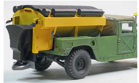
7 Höhe: Am Streuaufsatz die schwarze Verteilereinheit zum Schluss montieren, Streuteller und Radnabe bilden eine Linie
