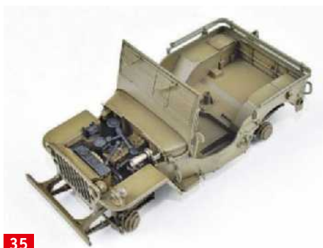
35 Beim Willys von Bronco stellt die Hochzeit von Karosserie und Rahmen den einzigen kritischen Bauabschnitt dar. Besonders der geringe Spielraum zwischen Karosserie und Motor erfordert Aufmerksamkeit
