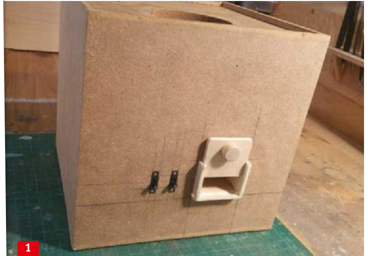
Als Sockel diente mir der Korpus eines alten Lautsprechers. Auf der Rückseite befinden sich das Batteriefach sowie die Kippschalter
