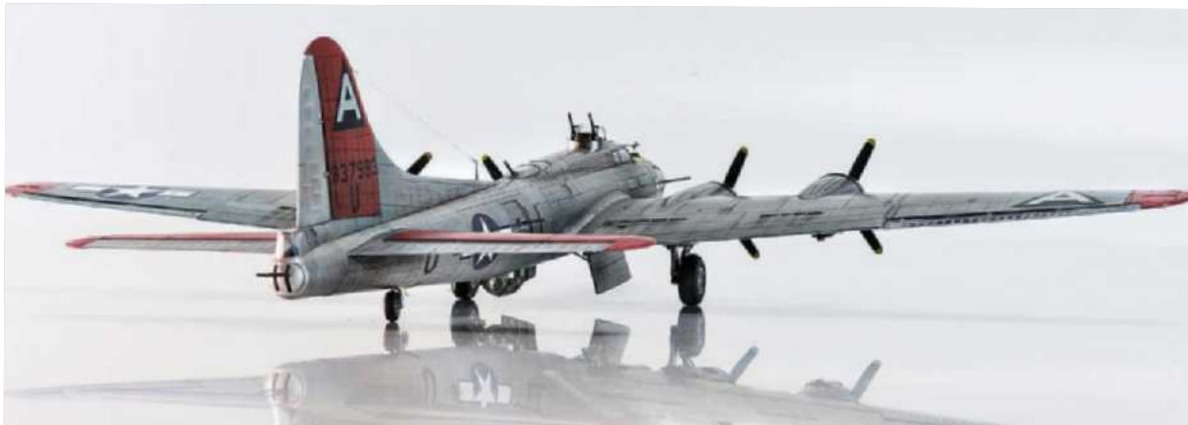
Hinter dem charakteristisch großen Seitenleitwerk befand sich eine Waffenkanzel mit einem Browning-M2-Zwillings-Maschinengewehr, das von einem Schützen bedient wurde, der die gefährlichste Position im Flugzeug einnahm
