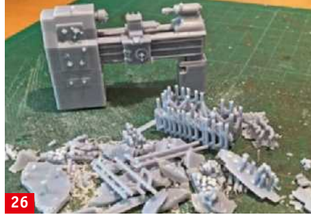
26 An allen Maschinen sind vorwiegend feine „Gussstützen“ zu entfernen. Dabei nicht die winzigen Details der Maschinen mit kappen!
