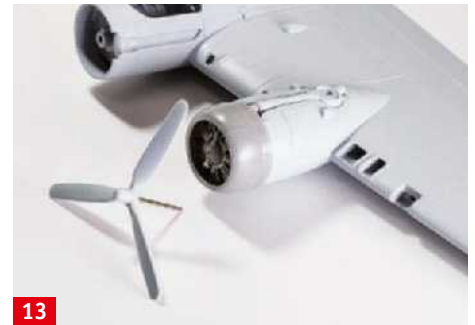
13 Die Cowling ist jetzt probenhalber montiert und der Propeller schon auf sauberen und freigängigen Lauf getestet
