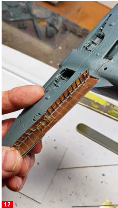
Hat man die Landeklappen fertiggestellt, muss der Modellbauer diese noch in Flügel und Rumpf einpassen
