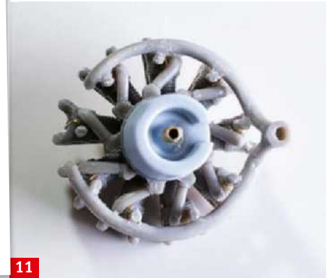
11 Die Montage der Auspuff- und Ansauganlage ist fummelig und muss am Flügel-Motor-träger trocken angepasst werden
