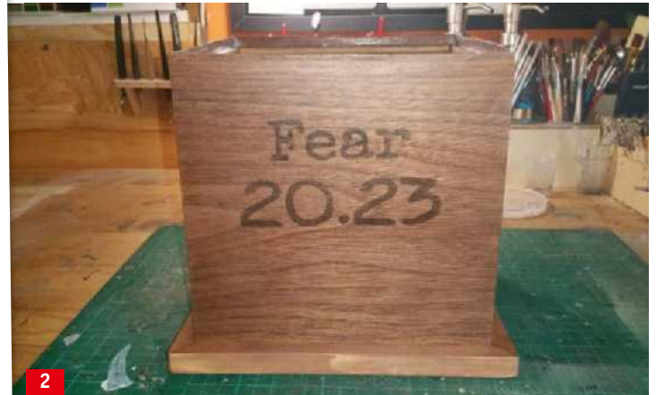
Der Lautsprecherkorpus wurde mit Furnier verkleidet. Den unteren Abschluss bilden auf Gehrung geschnittene Kanthölzer
