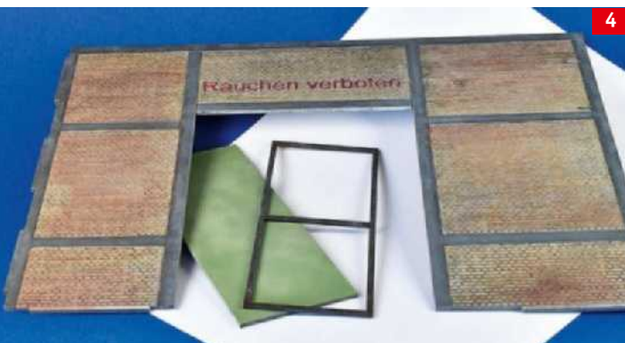
Die braunen Kanten entstehen beim Lasern. Das Material: MDF (mitteldichte Faserplatte), hier zwei Millimeter stark. Auf dem Boden eine Platte mit Stahlträger teilen
