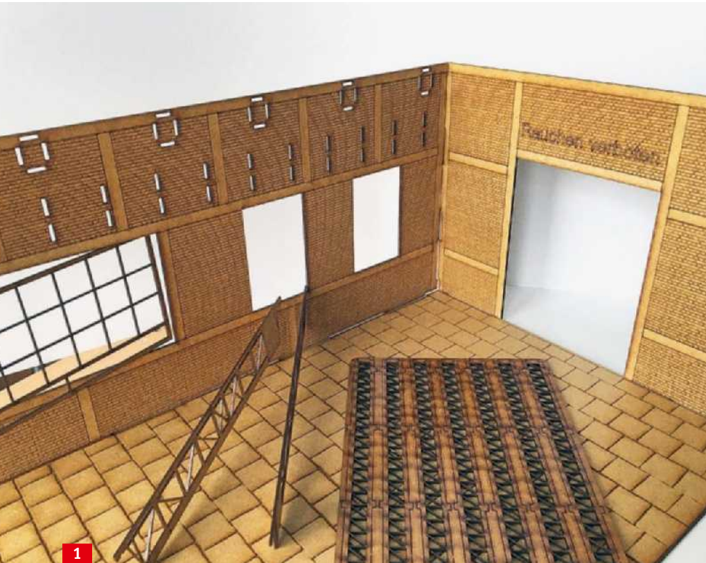
Die braunen Kanten entstehen beim Lasern. Das Material: MDF (mitteldichte Faserplatte), hier zwei Millimeter stark. Auf dem Boden eine Platte mit Stahlträger teilen
