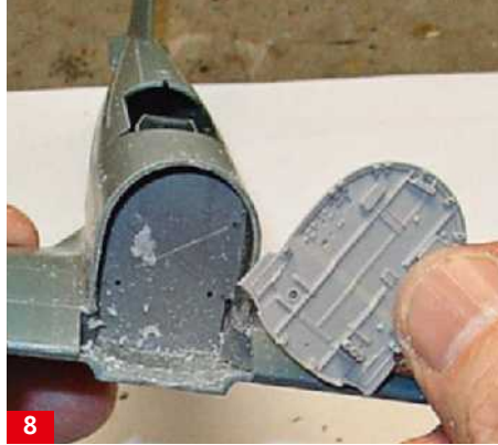
Zum Einbauen des Motors ist es notwendig, die gesamte Front des Modells abzutrennen
