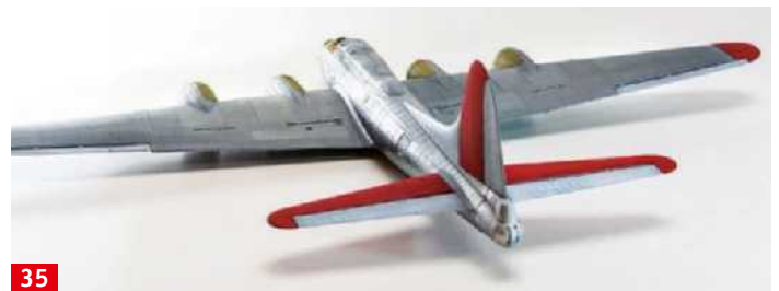
35 Die roten Kennfarben und die olivgrünen Antireflex-Bereiche sind direkt auf der Alclad-II-Schicht
