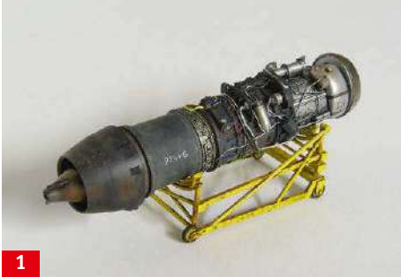
1 Das aus mehreren Resinteilen zusammengebaute Modell des kleinen BMW 003 ist schon ein echter Hingucker. Kleine Ziffern gelangen am besten mit einem ganz feinen Pinsel und verdünnter Farbe
