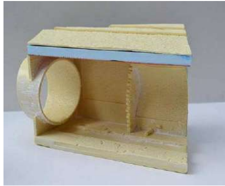
Zwischen Mauerwerk und Straße ist eine einen Zentimeter starke Styrodurplatte eingesetzt, um Höhe zu gewinnen
