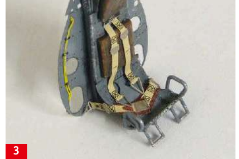
3 Der Katapultsitz aus Resin mit fein detailiertem Rückenspann. Kleine gelbe Kabel aus Bleidraht verfeinern das Werk. Die He 162 war nach der Arado 234 und der He 219 der dritte Luftwaffen-Typ mit Schleudersitz
