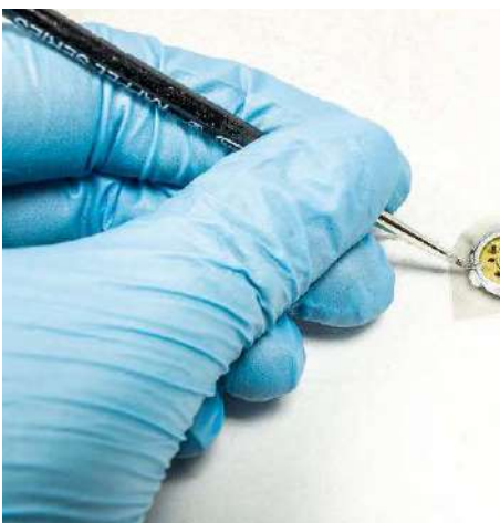
Der Brass Burnisher ist speziell für Messing gedacht. Mehrmaliges Brünieren von Messing ist eine gute Grundlage für das Lackieren
