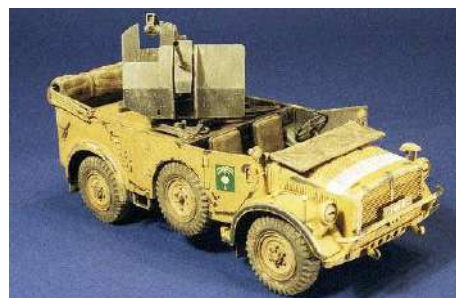
Tamiyas Horch mit 2-cm-Flak vom gleichen Hersteller. Die Plattform für die Flak entstand im Eigenbau. Schon damals war die Idee des „Chipping“ geboren, hier ausgeführt jedoch mit Maskol-Abdeckmittel
