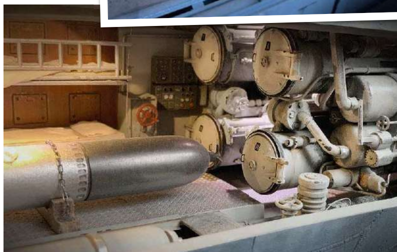
Im Bugtorpedoraum liegt ein glänzender Aal zum Nachladen bereit. Links sind die Kojen der Torpedowarte zu sehen
