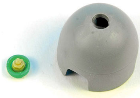
15 Der jetzt dank Eigenbau deutlich erkennbare Verschluss des Spinners im Rohbau ...
