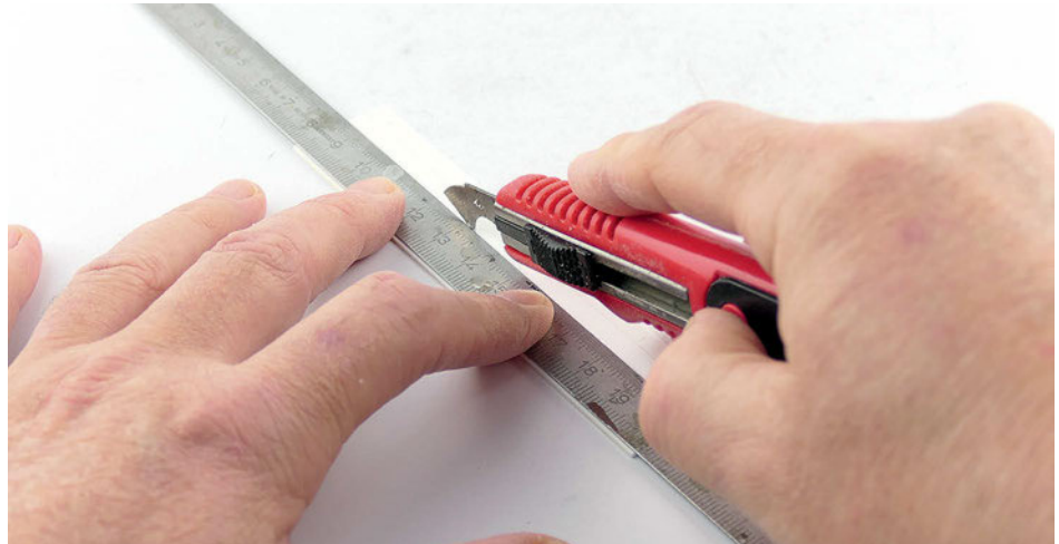
2 Mit einem Geodreieck und einem Bleistift Linien in Brettbreite vormarkieren und mit einem Graviermesser entlang eines stabilen Stahllineals einritzen
