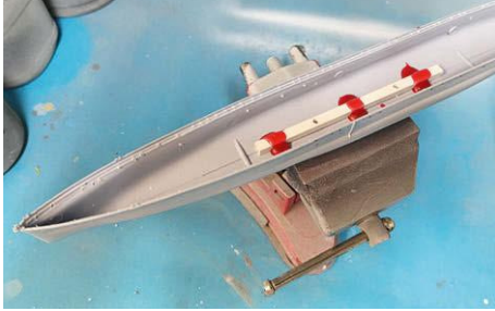
1 Die selbst gebaute Aufnahme mit Profil-Vierkantröhr für die Montageschrauben an ihrem Platz
