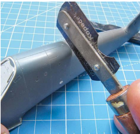
21 Zum Nacharbeiten der verlorengegangenen Gravuren leistet eine feine Resinsäge sehr gute Dienste
