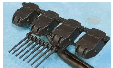
9 Die sehr fein detaillierten gedruckten Türme aus dem 3D-Printer nach dem Grundieren
