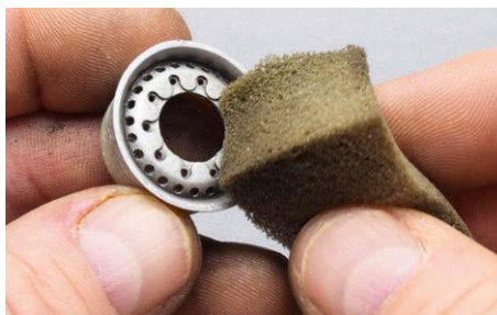
20 Mit einem Stück feinporigem Schaumstoff verreibt man das Pulver und trägt gleichzeitig den Überschuss nach Wunsch ab
