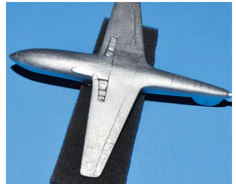
16 Das Alu bringt jeden Fehler ans Licht. Bevor die Kufendeckel kommen, soll alles symmetrisch und glatt sein
