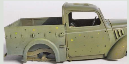
8 Unregelmäßig aufgetragene kleine Punkte aus Ölfarbe ergeben das sogenannte „Oildot Weathering“
