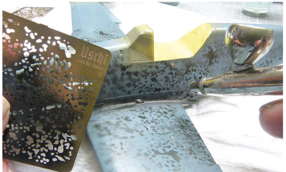
25 Ein sogenanntes Preshading mit Schablone soll nach dem Lackieren eine leicht diffuse Oberfläche erzeugen
