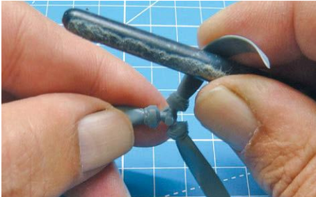
19 Der angenehm weiche Kunststoff des Bausatzes lässt sich über einem Rundholz hervorragend verbiegen ...
