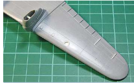
15 Die Delta 1C hatte auf der Unterseite nur zwei Stelltriebe für die Querruder, heißt: drei alte runter und zwei neue drauf
