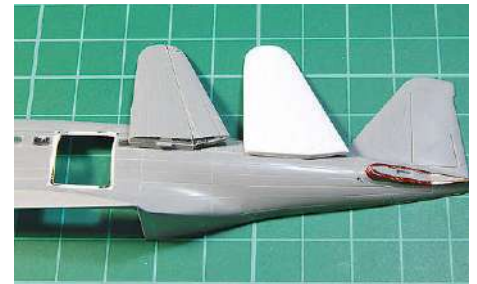
18 Dünnere Höhenleitwerke entstehen neu aus 2-mm-Sheet. Stelltriebe und Hohlkehlen für die ausgestellten Ruder
