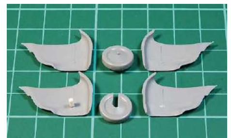
24 Dann wird die Radachse durchbohrt, das Rad auf gleicher Breite eingesägt und fertig lackiert in den Radausschnitt geschoben
