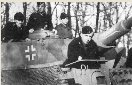
Ein typischer später Panzer IV der Ausführung J mit Thomaschürzen und an diesem Fahrzeug die u-förmigen Hebeösen an der Stirnpanzerung Foto: Sammlung F. Schulz
