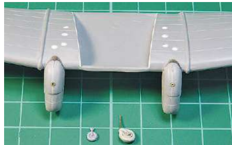
17 Tankverschlüsse von Brengun liegen bündig auf ausgestanzten Sheetscheiben, auch musste ein größeres Spornrad her
