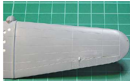
14 So stellen kleine Sheetstücke die Verkleidung der Querruderbetätigung dar, direkt über der Ansteuerung im Unterflügel
