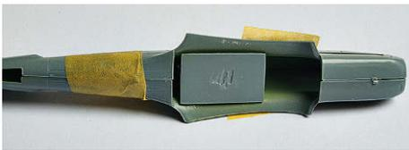
**4** Das Cockpit ist zuerst in eine Rumpfhälfte eingeklebt. Dabei sind die Rumpfhälften mit Klebeband zusammengehalten
