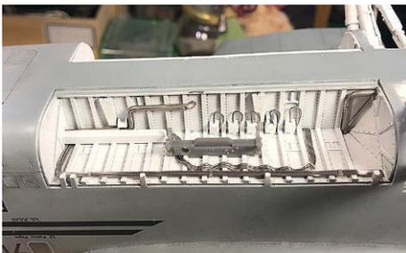
**7** Die Struktur der Waffenschächte ist 3D-basiert. Details entstehen in klassischer Manier mittels Sheet, Lötzinn und Bleidraht
