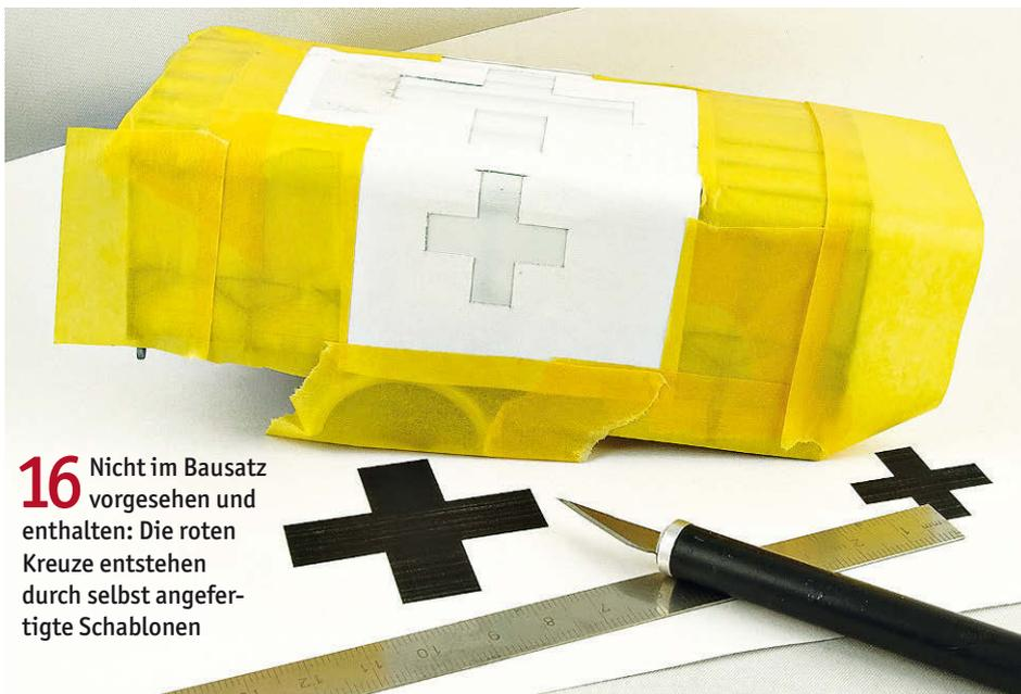
**16** Nicht im Bausatz vorgesehen und enthalten: Die roten Kreuze entstehen durch selbst angefertigte Schablonen
