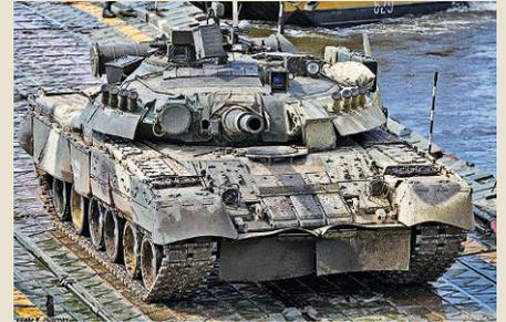
T-80U mit „Kontakt 5“-Zusatzpanzerung, 2016 Foto: Vitaly V. Kuzmin, CC BY-SA 4.0
