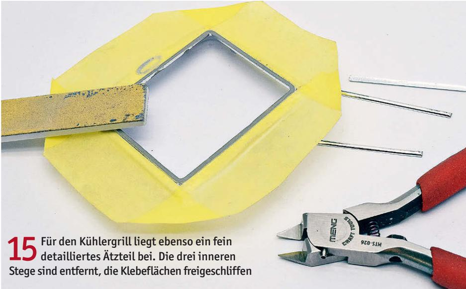
**15** Für den Kühlergrill liegt ebenso ein fein detailliertes Ätzteil bei. Die drei inneren Stege sind entfernt, die Klebeflächen freigeschliffen
