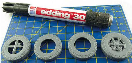
**6** Den kreuzförmigen Anguss mit einem Seitenschneider heraustrennen, Reste mit einer selbst gefertigten „Rundfeile“ entfernen
