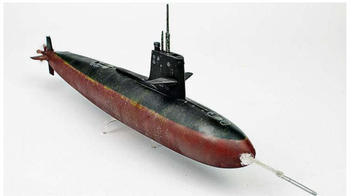
Der Torpedo „schwebt“ auf einem mit Baumwolle kaschierten MS-Stab (Blasenbahn), das Boot ruht auf glasklaren Gussästen
