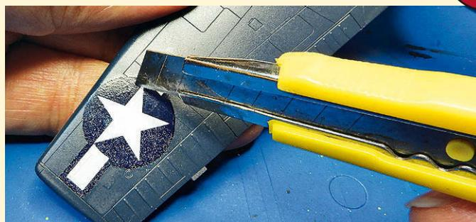
**2** Legen sich die Decals nicht an die Blechstöße an, mit dem Cutter einschneiden und den vorgenannten Vorgang (Bild 1) wiederholen
