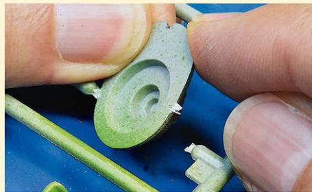
**5** Teile, bei denen die Angüsse später die Klebekanten sind, kann man auch durch Abdrehen vom Spritzling lösen
