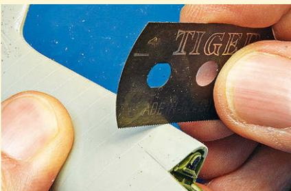
**4** Das Verschleifen hat den feinen Blechstoßen zugesetzt. Mit einer Microsäge deren Verlauf vorsichtig wiederherstellen
