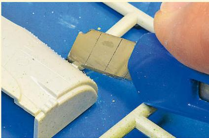
**4** Viele Angüsse, hier die Rumpfschalen, sind dünn und lassen sich mit einem Cutter aus dem Gussrahmen heraustrennen
