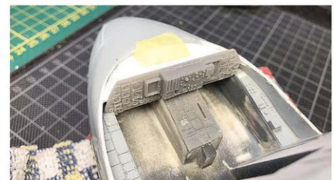
**11** Instrumentenpanel und Mittelkonsole wurden 3D-gedruckt
