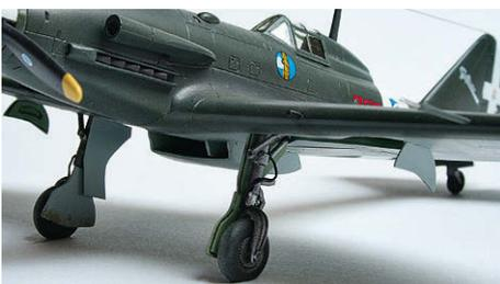
**20** Die Bremsleitungen entstehen aus 0,3-mm-Bleidraht. Der lässt sich sehr schön in Form biegen
