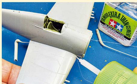
**5** Spachtel-Ersatz: Über der Flamme dünn gezogenen Gussast in den Spalt (Rumpf/Fläche) einlegen, mit Flüssigkleber verleimen
