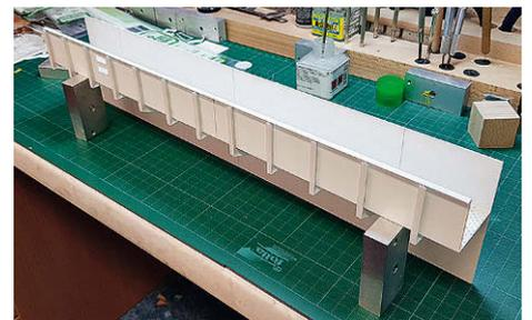
**22** Catwalk und Rumpfwand. Exakte Metallklötze erleichtern solcherlei Arbeiten und garantieren eine perfekte Ausrichtung
