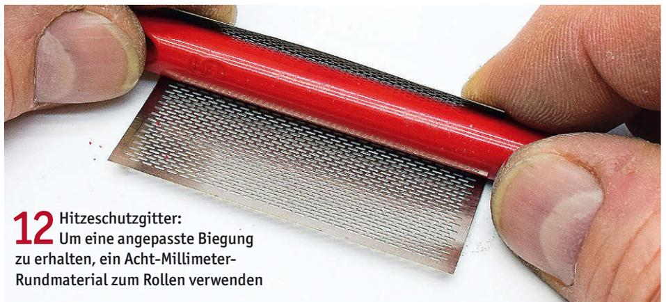
**12** Hitzeschutzgitter: Um eine angepasste Biegung zu erhalten, ein Acht-Millimeter-Rundmaterial zum Rollen verwenden
