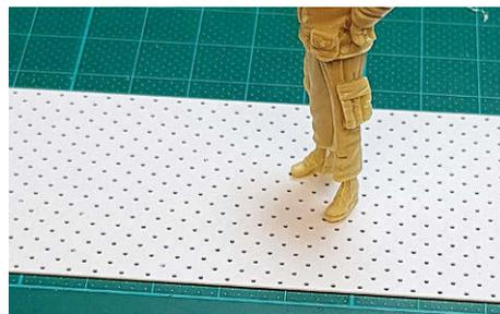
**21** Das gelochte Bodenblech entstand auf der CNC-Fräse. Von Hand so präzise zu bohren, erscheint schier unmöglich
