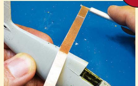
**3** Tritt aus den Klebeflächen Kleber-Plastikgemisch aus, dieses nach Trocknung mit dem Bügelschleifwerkzeug versäubern
