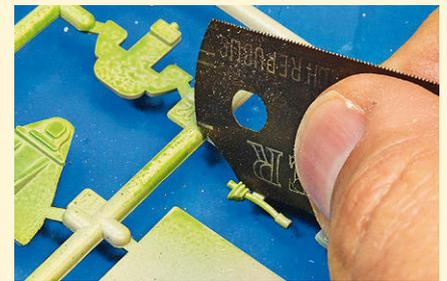
**6** Der Steuerknüppel ist sehr dünn. Solche Teile brechen beim Ansetzen eines Seitenschneiders gerne. Besser: absägen
