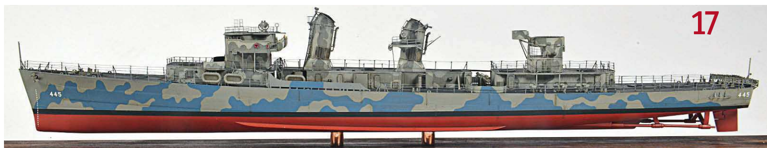
15–18 Bildserie mit Fortschritt der Baustadien. Höchster Punkt ist der Mast mit Radar, 26 Zentimeter über Kiel
