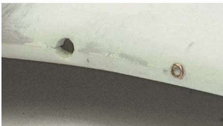
19 Die Schießkamera ist durch einen selbst angefertigten Ring aus Kupferdraht wiederhergestellt
