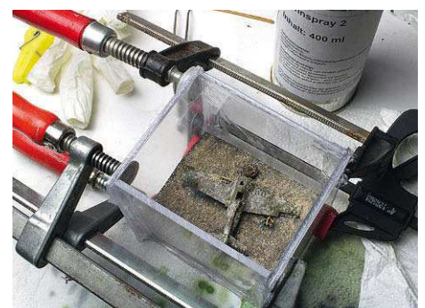
10 Polystyrol-Platten bilden die Form, Trennspray sorgt für leichtes Entformen, Silikon fungiert als Kleber und Dichtmittel
