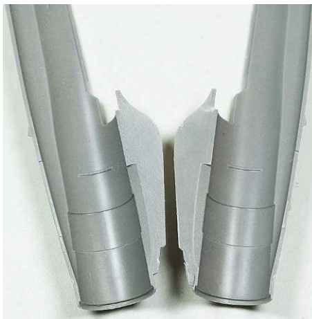
3 Die große Kielflosse muss an den Innen-seiten deutlich ausgedünnt werden
