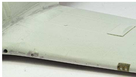
20 Mit Mr. Surfacer von Gunze kann der Modellbauer den Rand angleichen und verschleifen
