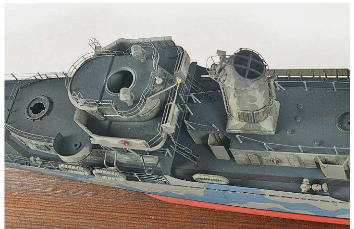
14 Auf den oberen Decks und den Türmen waren die Reelings als Fotoätzteile vorhanden und nicht einfach zu bearbeiten
