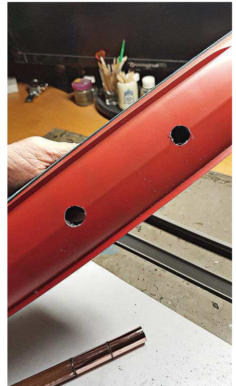
8 Mit einem Zirkel markierte der Modellbauer die Bohrloch-Durchmesser, damit diese die Kupferständer aufnehmen konnten
