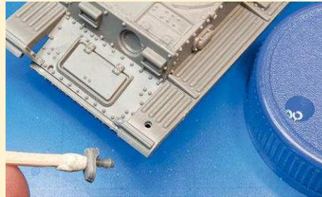
**5** Sehr kleine Teile verspringen leicht. Ein Kügelchen Uhu tac auf einem Zahnstocher hält das Detail sicher. So positionieren
