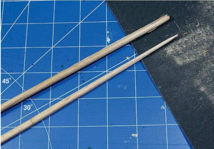
**1** Der Stamm aus leichtem und weichem Balsaholz lässt sich gut mit Schleifpapier über fast die komplett Länge konisch zuschleifen
