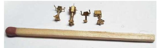
**16** Einige Ätzteile sind so klein, dass eine Biegehilfe nicht hilft, sondern nur die Finger, gute Pinzetten und Messer
