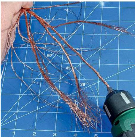
**4** Da das Verdrillen recht aufwendig ist, kann man auch einen Akkuschrauber mit niedriger Drehzahl als Hilfe verwenden
