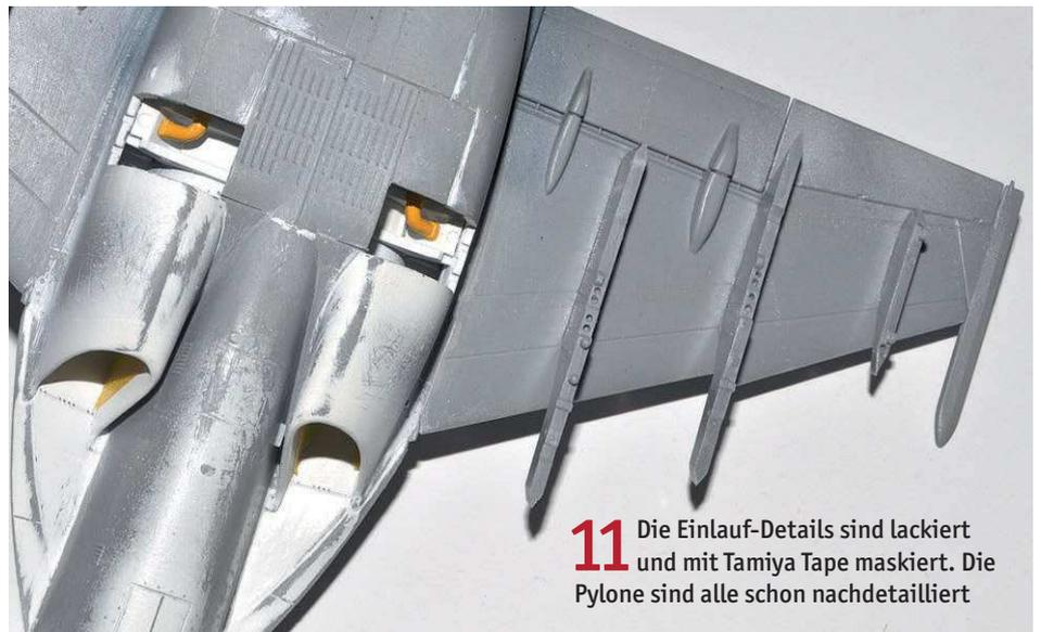
**11** Die Einlauf-Details sind lackiert und mit Tamiya Tape maskiert. Die Pylone sind alle schon nachdetailliert
