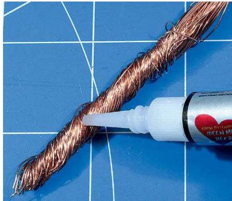
**2** Unmittelbar nach dem Entfernen der Ummantlung sollte man ein Ende des Geflechtes mit Sekundenkleber fixieren
