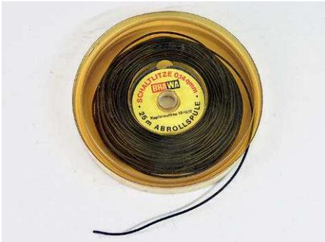
Als Ausgangsbasis lässt sich zum Beispiel Schalllitze, hier Brawa, mit einem knapp einen Millimeter starken Mantel verwenden
