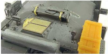
**3** Ein Ätzteil liegt dem Kit zwar bei, leider fehlt aber der Schieber für den Motorlüfter. PE-Details von Aber schaffen Abhilfe
