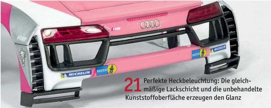
**21** Perfekte Heckbeleuchtung: Die gleichmäßige Lackschicht und die unbehandelte Kunststoffoberfläche erzeugen den Glanz
