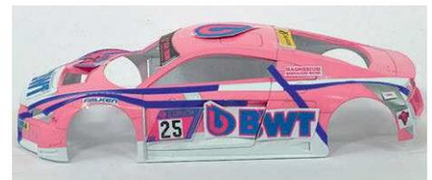
**7** Mithilfe von Klebandstreifen kann man die Ausdrucke positionieren, versetzen und später wieder entfernen, soweit alles passt
