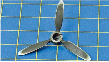
**10** RLM70 stark verdünnt und lasierend über Schwarz. Nach dem Aushärten wird alles mit 1200er-Schleifpapier überarbeitet
