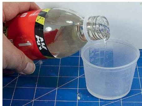
**4** Bei Resin ist generell ein genaues Mischungsverhältnis entscheidend. Also kommt ein Gefäß mit Skalierung zum Einsatz
