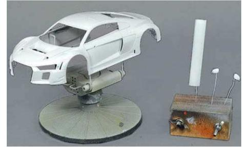
**3** Professionelle Autolacke wie von Standox kann man problemlos auf diese Grundierung mit dem Airbrush aufsprühen
