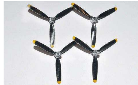
31 Propeller mit unterschiedlich starken Abnutzungen. Frischere mit weniger Abrasion vor allem hinten
