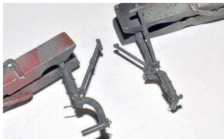
29 Die Fahrwerksstreben erhalten zusätzlich im Eigenbau Haltebänder, Leitungen, Ösen, Streben, Bohrungen und Muttern
