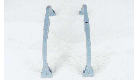
14 Die einteilig ausgeführten Kufenhalter weisen einen Formversatz und Sinkstellen auf, die beseitigt werden sollten
