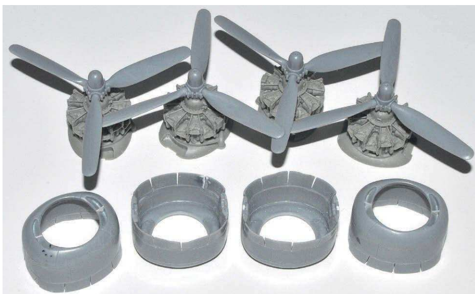
18 Propeller gibt es mehrfach, „Nanette“ hat gute von Hasegawa. Die Belüftungskappen und Umgebung sind ausgesägt, dünner geschliffen und nun unterschiedlich geöffnet
