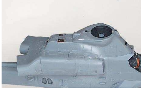
13 Selbstklebende Kupferfolie dient zur Herstellung der erhabenen Zugangsflappen über dem APU
