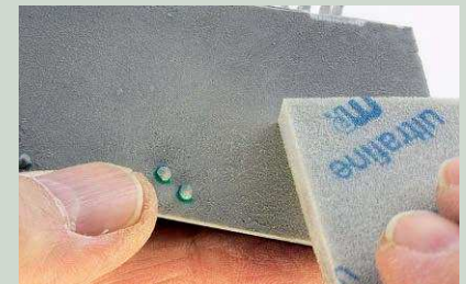
16 Im zweiten Schritt mit Schleifvlies zu grobe Strukturen glatter schleifen. Es bleibt eine leicht raue Oberfläche
