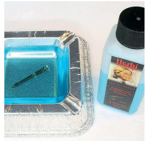
19 Brünierungsmittel eignet sich hervorragend, um Messingteilen ein realistisches Finish zu verpassen
