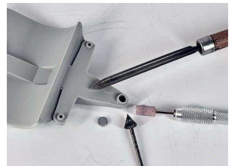
Am Sonderanhänger: Halterungen passend aufbohren und mit einem Scheibenmagnet 5 x 2 und zwei 3 x 1 Millimeter N52 versehen
