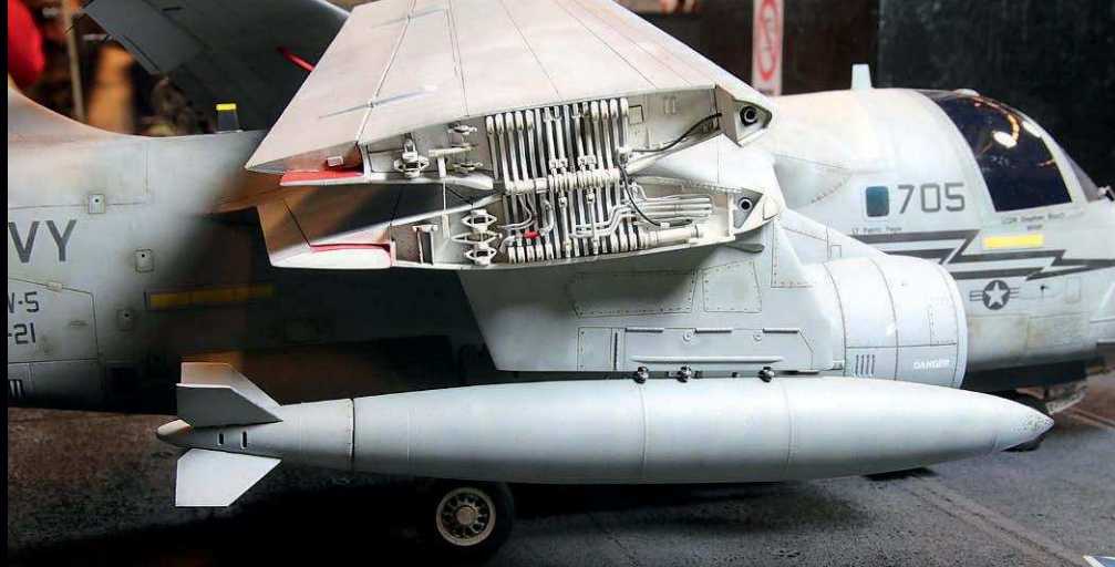
Die einzigartige Lockheed S-3 Viking von Ben Schumacher in 1:32, in fünf (!) Jahren scratch gebaut und mit 3D-Teilen für die Innenstruktur der Faltflügel
