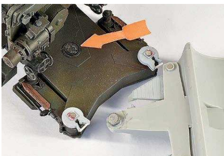
Analog angepasste Nachbesserungen mit zwei 2-x-1-mm-Scheibenmagneten und einer Metallscheibe, an drei Stellen sicher fixiert
