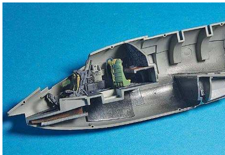
6 Cockpit und Bugradschacht in der rechten Rumpfhälfte – unter dem Cockpit die dicke Bleifolie als Buggewicht
