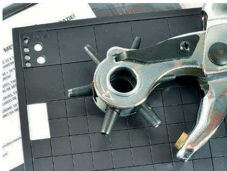
Hersteller Beilheimer: 10 x 10 und 20 x 20 Millimeter starke, selbstklebende Magnetplättchen, mit einem Lochstanzer bearbeitbar
