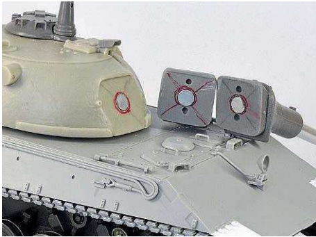
Jeweils eingearbeitete 5 x 2 Millimeter kleine, aber starke Scheibenmagnete tragen hier zwei alternativ verwendbaren Geschützrohre
