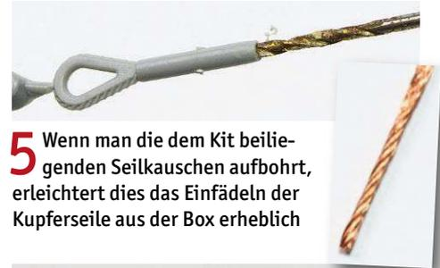
**5** Wenn man die dem Kit beiliegenden Seilkauschen aufbohrt, erleichtert dies das Einfädeln der Kupferseile aus der Box erheblich
