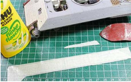
**1** Die Resinplatten haften sehr gut mit Uhu „Flinke Flasche“ (Vielzweck-Kleber) und lassen sich damit leicht in Position schieben
