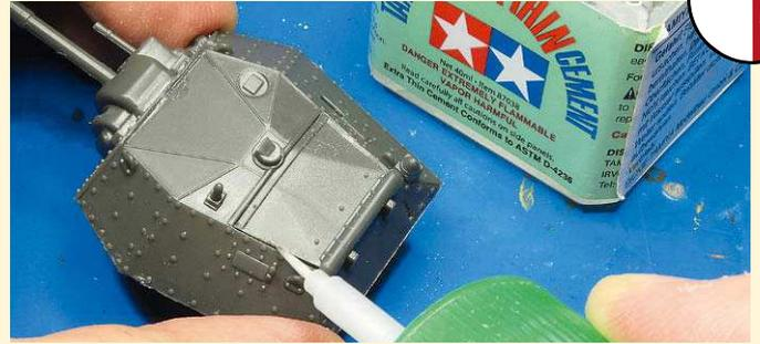
**2** Überlaufender Kleber ruiniert die Oberfläche: Teile zusammenstecken und dünnen Flüssigkleber in die Fugen laufen lassen
