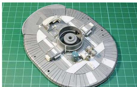
**17** Die Tanks mit Ölkühler und allen Leitungen sowie Anbauteilen für Ölkreislauf und Sprit sind montiert und verlegt
