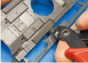
**1** Da die Teile stabil sind, kann man beim Abtrennen den Seitenschneider verwenden. Hier an der Oberwanne etwas Abstand halten
