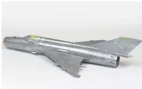
**17** Auf Aluminium aufgetupfte und ausgestrichene Flecken aus Maskol, mit verschiedenen Metalltönen überlackiert
