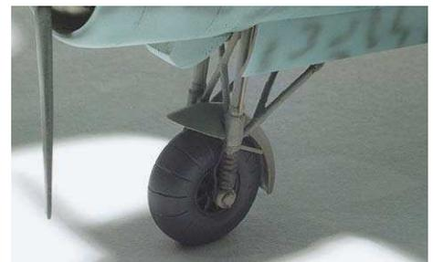
**22** Die Fahrwerksbeine sind mit Schienen für Klappen, Bremsleitungen und Streben zu den Kotflügeln ergänzt
