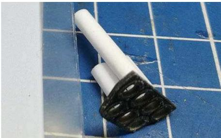
**5** Zur Darstellung fehlender Rohrhülsen Profile von Evergreen an den Teilen C43 und C44 ankleben und passend schleifen
