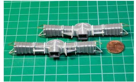
**12** Nachher (innen): Die Klappen sind verfeinert, die Airfix-Klappen liefern die Krümmung für die geöffnete Stellung
