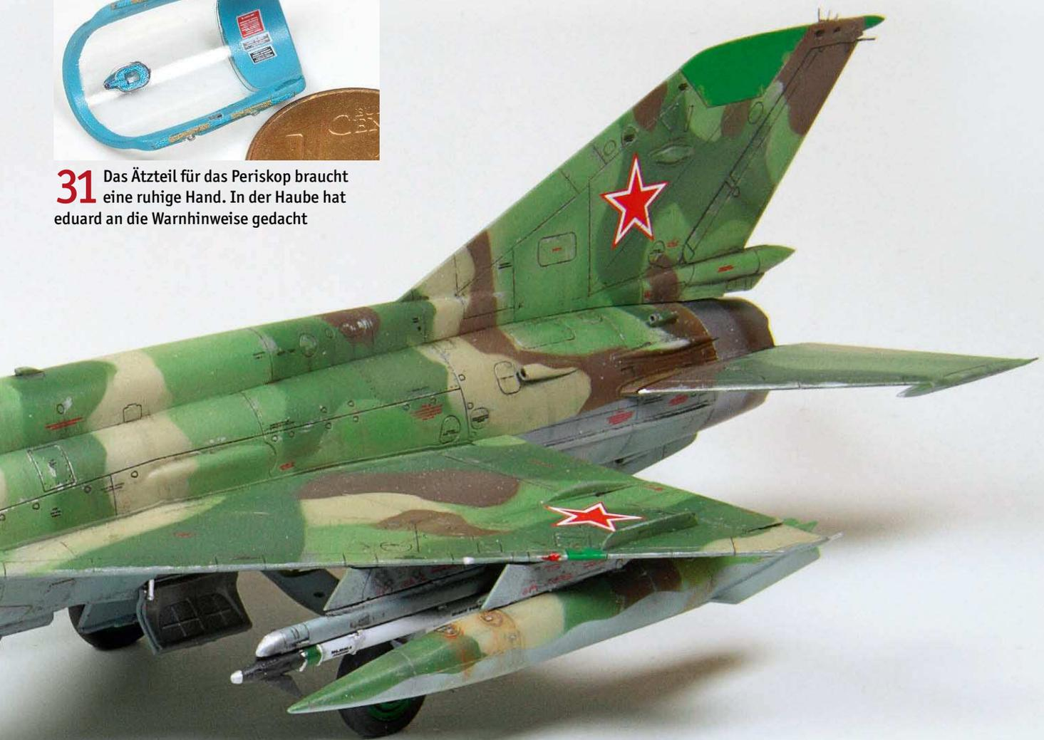
eduard liefert hilfreiche Ätzteile für die Gestaltung des Periskopspiegels und der Verschlusösen (31). Gerade bei der Darstellung mit geöffneter Haube sind diese Teile sinnvoll. Den Schleudersitz für das Modell mit der geschlossenen Haube musste ich dann noch etwas am Boden abfeilen, da er schlicht zu hoch war und die Haube nicht passte.
