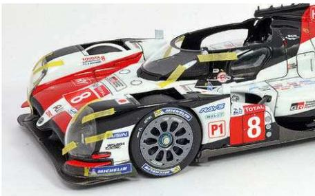
**27** Immer noch die beste und sicherste Lösung: mit Holzleim die Klarteile gefahrlos einsetzen und mit Tape fixieren
