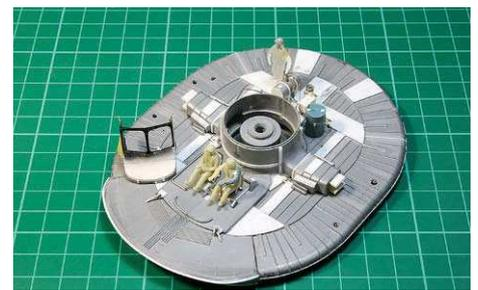
**18** Steuergestänge der Hebel für Vor- und Rückwärtsfahrt sowie Quer- und Längstrimmung, zudem Armaturen für die Kabine
