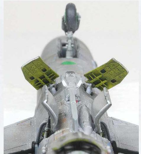
**27** Die genau ausgerichtete Position der vorderen Bremsklappen verlangt Erfahrung und Geduld
