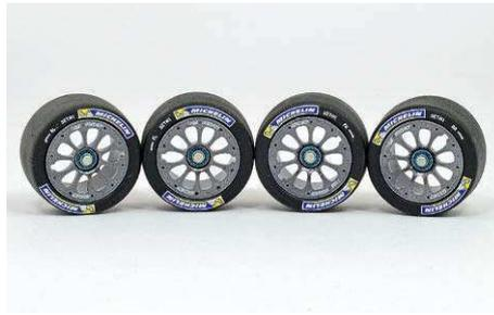
**2** Tamiya TS „Gun Metal“ aus der Spraydose eignet sich sehr gut zum Lackieren der Felgen. Die Decals sind wiederum zugekauft
