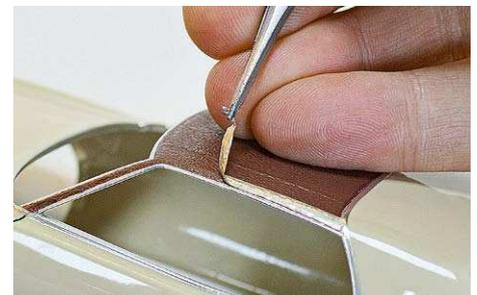
**8** ... und dann mittels Pinzette eine Ecke anheben und den Überschuss abziehen
