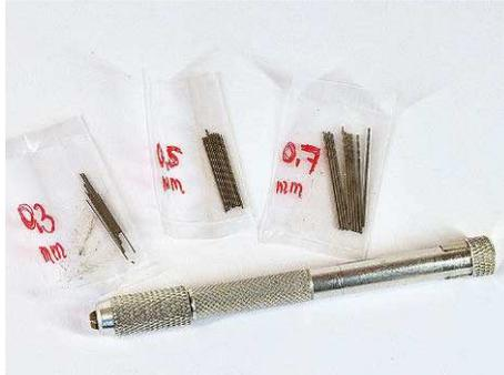
Für die weitere Bearbeitung des Antennensockels am Modell sollten feinste Bohrer von 0,3 bis 0,7 Millimeter verfügbar sein
