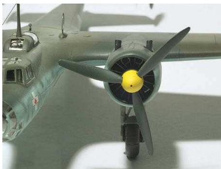
**21** Die Motoren sind gut wiedergegeben. Bis auf die beiden Abgasrohre passt alles gut zusammen
