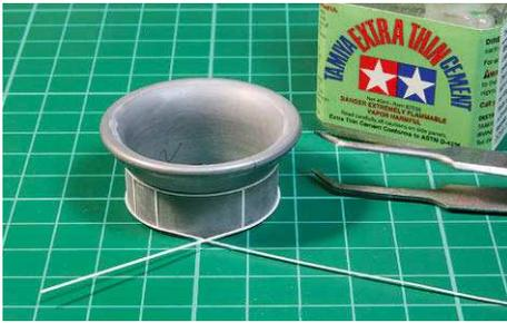
**10** Vorsichtig fixiert, wird der umlaufende Ring durch 0,25-x-0,50-mm-Flachprofil ergänzt und auf Stoß geschlossen
