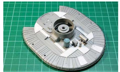
**16** Erste Stellprobe mit Sprit- und Öltank, dem Ölkühler sowie dem „Langstreckentank“ für die Kanalüberquerung
