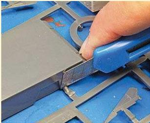
**3** Die meisten Angüsse, hier an der Unterwanne, sind recht dünn und lassen sich leicht mit einem Cutter aus dem Gussrahmen lösen
