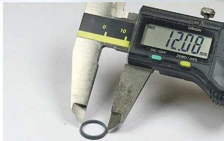
**2** Mit korrekter Abmessung, aber seltsam stumpf ausgeführt, stellt sich der Einlaufing dar
