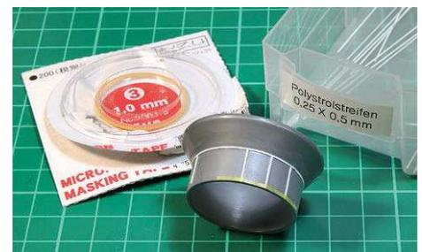
**9** Einen Millimeter über dem unteren Rand des „Eierbeckers“ verläuft ein schmaler Ring, hier im harmlosen Stadium der Markierung und Vorbereitung
