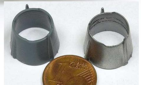
**3** Die etwas dicken Hinterkanten (rechts) der Nachbrennerverkleidung können leicht dünner gefeilt werden
