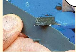
**2** Entgraten an glatten Kanten mit einem Cutter. Hier den Daumen als Unterstützung nehmen und mit wenig Druck agieren (Vorsicht)
