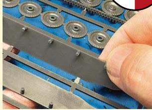
**2** Bauteile, bei denen die Angüsse später nicht mehr sichtbar sind, lassen sich auch einfach durch Abdrehen aus dem Gussast entfernen
