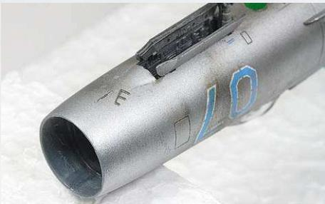
**28** Für die IFF-Antennengruppe ist vor der Lackierung ein Aufnahmeschlitz graviert
