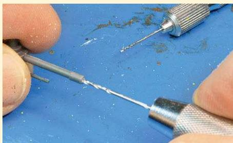
**5** Das Rohr hat an der Mündung keine Öffnung. Mit Bohrern unterschiedlicher Stärke (dünn vorbohren) vorsichtig aufweiten
