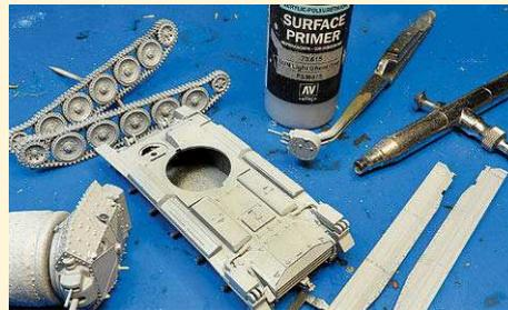
**2** Die Grundierung gelingt hier mit hellgrauem Primer von Vallejo mittels Airbrush oder Pinsel. Ausreichend trocknen lassen
