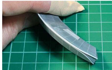
**5** Die Nacharbeit am Schwallbrett hinterlässt auch beim Autor deutliche Spuren: in Form schleifen und Profilstreifen, Gravur und Nietensreihen aufbringen
