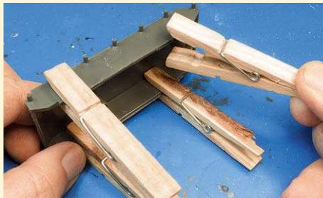
**2** Bis zum Durchtrocknen des Klebers beide Seitenteile mit Wäscheklammern sichern. Solche aus Holz eignen sich ideal
