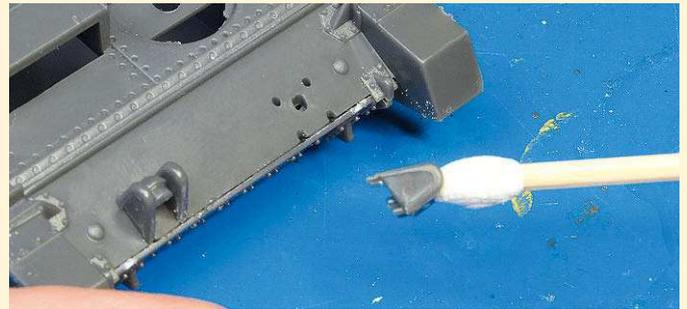
**4** Kleine Teile verspringen leicht. Ein Kügelchen Uhu tac auf einem Zahnstocher fixiert das Detail am selbigen – so platzieren
