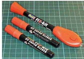
Nun führt auch Revell UV-Klebstoff im Programm. Das senkrecht abstellbare, dreiteilige „FIX-kit“ (Ständer, UV-Marker, Gehäuse mit Schalter und UV-LED) beinhaltet zwei Kartuschen mit je vier Gramm Klebstoff, das Set 39625 enthält nur eine. Der hellgrüne Marker/Filzstift leuchtet unter UV-Licht deutlich sichtbar. Verarbeitung: Klebstoff auftragen, Teile in Ruhe ausrichten, fünf bis zehn Sekunden anleuchten – (bomben-)fest. HSD ★★
