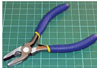
Kleine Kombizange (115 Millimeter) mit Gummierung, so liegen die Griffe gut in der Hand. Die Metallteile sind sauber verarbeitet, die gezahnten
