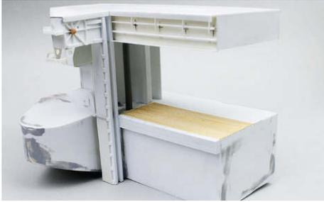
**8** Hier zeigen sich Bleche und Versteifungen, die aus Polystyrolplatten unterschiedlicher Dicke geschnitten wurden
