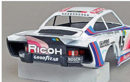
**13** Die mit Klarrot und -orange bemalten Heckleuchten bringt die dahinter geklebte „Bare-Metal Foil“ zum Leuchten
