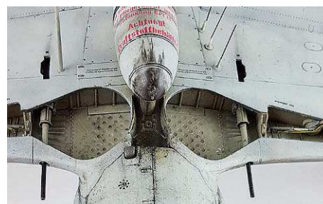
23 Die Unterseite der Motorverkleidung samt Auspuffahne
