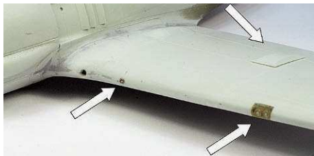
6 Die Schiesskamera, der Landescheinwerfer und die Abdeckungen für die äußeren MG 151 – letztere wurden wieder entfernt
