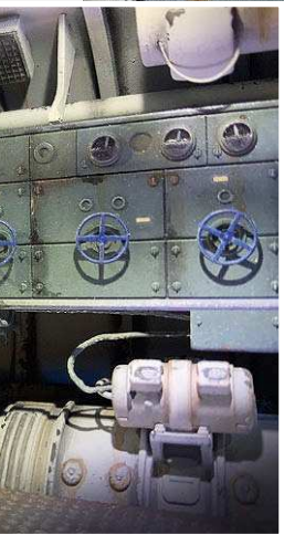
Die Elektromotoren liegen halb versenkt im Laufgang, darüber der Steuerstand
