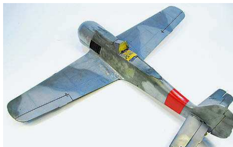
20 Ebenso kommt Klarlack als Haftgrund für die Decals auf die Oberseiten
