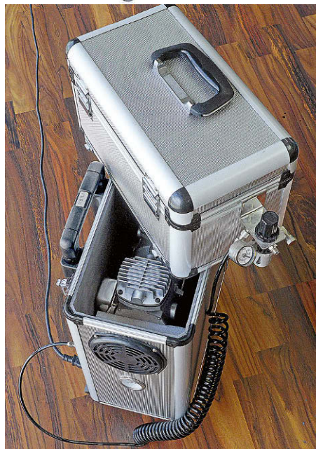
7 Öfter unterwegs? Ein Koffertrolley mit fest eingebautem Kleinkompressor in einem Werkzeugkoffer (kann mehr Laufruhe bringen)
