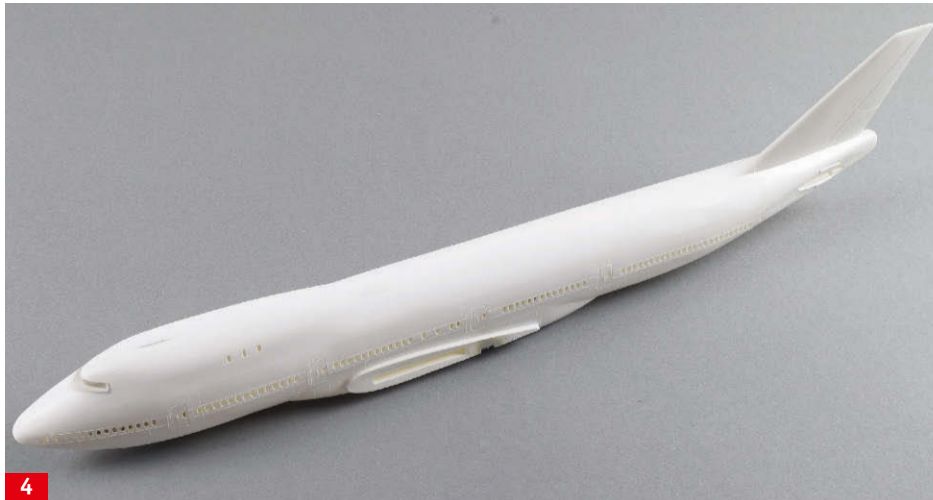
4 Die beiden Rumpfhälften passen hervorragend zusammen. Lediglich das Klarteil der Cockpitscheiben musste der Modellbauer verspachteln, da die Form nicht stimmt. Später kam ein Scheibendecal zum Einsatz
