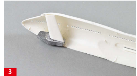
3 Typisch bei Airliner-Modellen ist das notwendige Buggewicht, um ein Tailsitting der 747 zu verhindern. Zusätzlich wurde eine Abstützung für das Bugfahrwerk eingebaut
