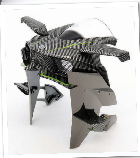
Das „Gesicht“ der H2R mit Decals und den geätzten Lufteinlassgittern
