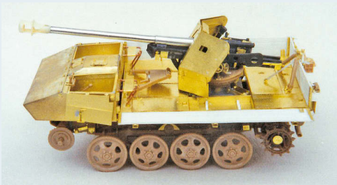
Hier ist alles Messing, was glänzt. Aus Neugier, ob die aus einem Stück geätzte Kabine nach dem Biegen wirklich passt, wuchs dieses aufwendige Projekt auf Basis des alten Italeri R50
