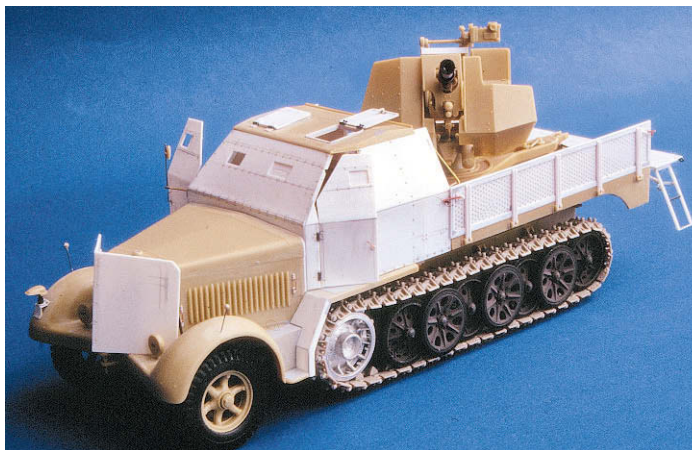
Etwas später detaillierte Harald Fitz das dann erhältliche Tamiya-Modell des Sd.Kfz. 7/2. Kabine und Kotflügel wichen einem Eigenbau, die Löcher im Lochblech waren alle handgebohrt (!)
