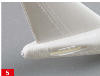
5 Das typische Abgasrohr der APU fehlt leider im Bausatz. Abhilfe schafft ein Plastikrohr von Evergreen im richtigen Durchmesser
