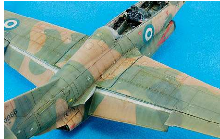
25 Zum Schluss werden die Nietreihen noch durch Trockenmalen mit Acrylfarbe hervorgehoben
