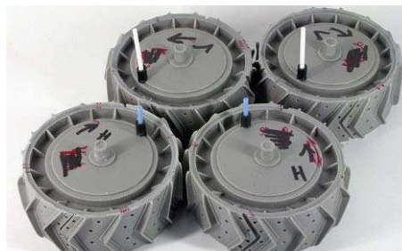
10 Bei der Montage der Räder ist zwingend auf die Laufrichtungen zu achten. Die Räder sind achsbezogen beschriftet
