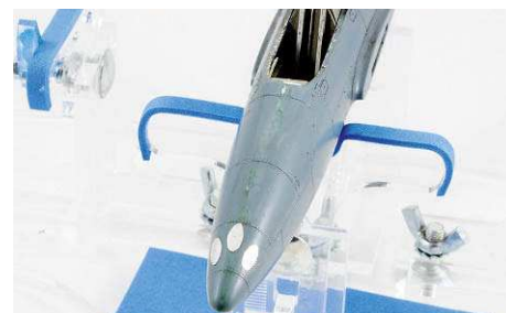
13 Eine Helling erleichtert das Hantieren und Ausrichten des Modells und seiner Anbauteile
