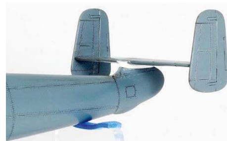
11 Mittels Acrylpachtelmasse, welche sich mit Wasser wieder abreiben lässt, hat der Autor die Bleche dargestellt
