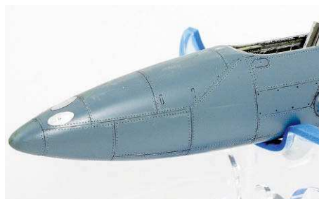
12 Die Abdeckungen waren auf den Vorlagenbildern zu sehen und sind mit Alufolie dargestellt
