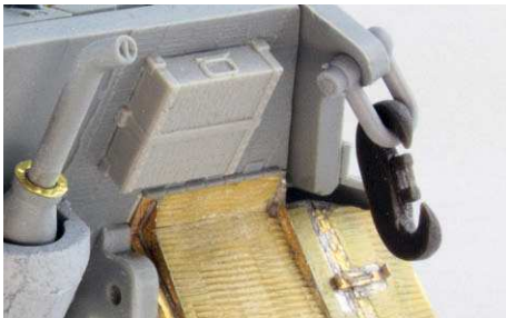
22 C-Haken aus der Restekiste: Zum Einfädeln Halteriegel einseitig anschneiden, nach dem Einsetzen wieder verkleben
