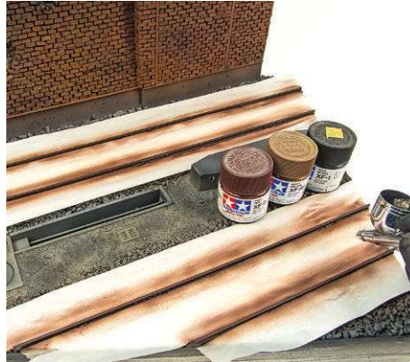
2 Die Gleise mit Kreppband abkleben, mit Tamiya-Farben in den üblichen braun-roten Farbtönen der Originalschienen lackieren
