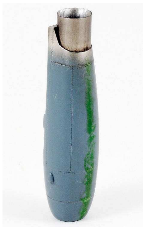
16 Deutlich sind die Farbunterschiede innen und außen am Triebwerksaustritt, Ölschlieren kommen noch
