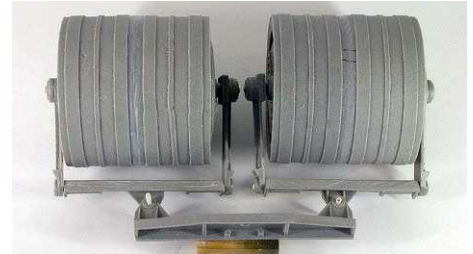
8 Passprobe: Die großen Walzenhälften sind hier bereits verklebt, die Nahtstellen mit Filler ausgeglichen und teils schon verschliffen
