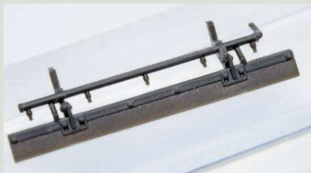
5 Das geht besser: die Rückholfedern rechts und links, hier noch aus Kunststoff und an der Schiene angegossen
