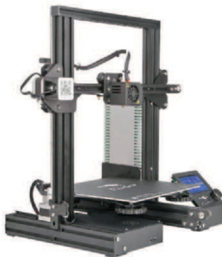
Der „Ender 3D“ – ein typischer FDM-3D-Drucker in der heute üblichen Bauweise. Der bewegliche Druckkopf, der das Filament zuführt, und das beheizte Hotbed, auf dem der Druck schichtweise aufbaut, sind gut zu erkennen Quelle: Creativity3D
