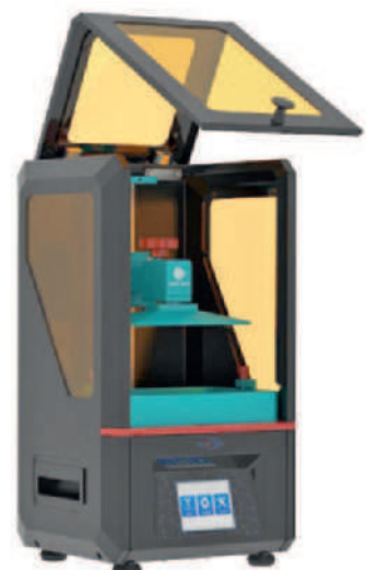
Der „Photon“ – ein DLP-3D-Drucker, mit dem detailreiche Ergebnisse erzielbar sind. Der Druckraum ist mit UV-undurchlässigen Scheiben geschlossen, damit der UV-Anteil im Tageslicht den Druckprozess nicht beeinflusst. Quelle: Anycubic
