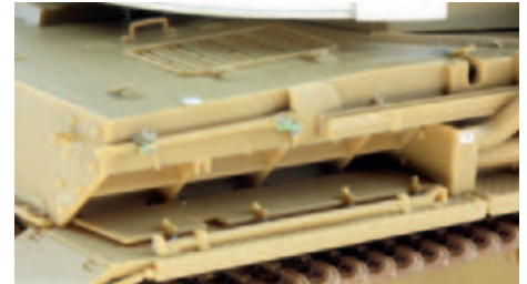
10 Zusätzliche Vorreiber für die Lüftungs-klappen. Die Aufnahme der Schaufel scheint auch recht speziell zu sein
