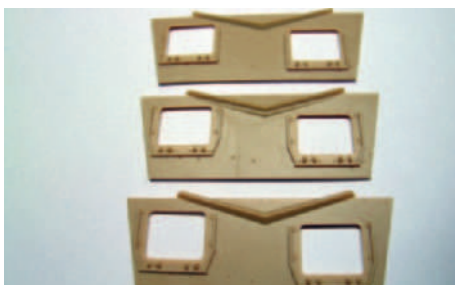
6 Die Unterschiede am Turmabweiser beziehungsweise der Fahrer- und Funkerluken-Einfassung sind gut zu erkennen
