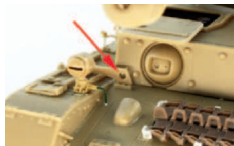
7 Die Kettenabdeckungsstütze jetzt mit Loch (Nibelungen-Fahrzeug), um die dahinterliegende Schraube erreichen zu können
