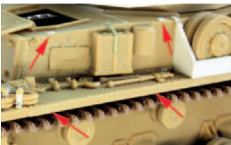
13 Es fanden „S“-Haken anstelle der üblichen „C“-Haken Verwendung. Ergänzt sind auch die Bohrungen der Schürzenhalter
