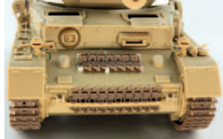
2 Die Schrauben auf der Bugplatte (die gleichen wie an der Frontpanzerung) sind hier abgetrennt und die Fläche verschliffen
