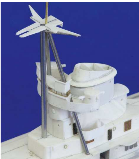
33 Endlich passen Plattformen, Stützen und der Schornstein zusammen. Die Teile sind vor dem Kleben bemalt
