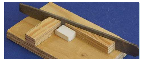
37 Um einheitliche Winkel feilen zu können, baute man eine Vorrichtung aus Sperrholz-Stückchen
