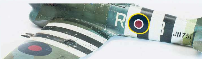
20 Die tollen Decals sind in mehreren Schichten transparenten Acryl-Lacks eingegossen, hier „Aquadgloss“ von Alclad
