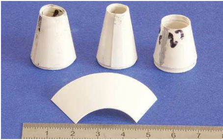
25 Ein Kreissegment und drei Versuche, einen Kegel herzustellen. Der rechte wurde beim Modell verwendet
