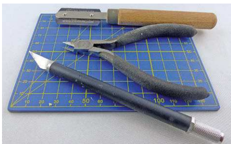
4 Nützliches Werkzeug zum Entfernen der Angüsse. Oben im Bild die im Text genannte unentbehrliche Feinsäge
