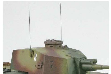
Die flexiblen Antennen des Typs 5 CHI-RI (IJA) aus dünnem Stahldraht (0,5 Millimeter), die nicht durchbrechen können
