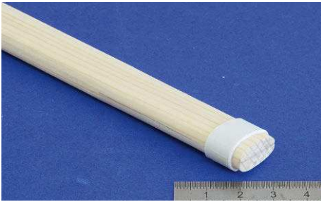
28 Schornstein-Herstellung: Plastikstreifen um Stab wickeln, mit Schichten Klebeband sichern, in kochendes Wasser tauchen
