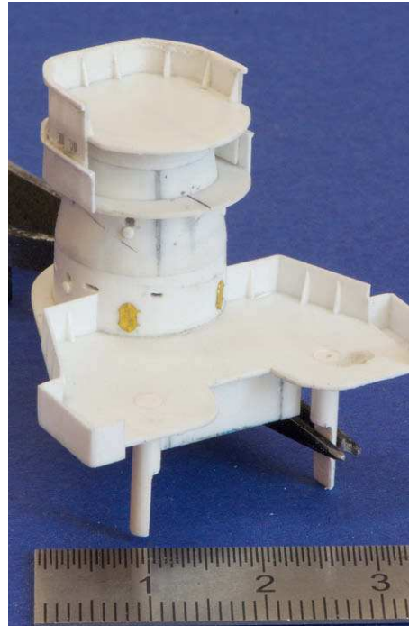
26 Mit 0,5- und 0,3-mm-PS kann man bessere Plattformen und Schanzkleider bauen, als die Bausatz-Hersteller gießen können
