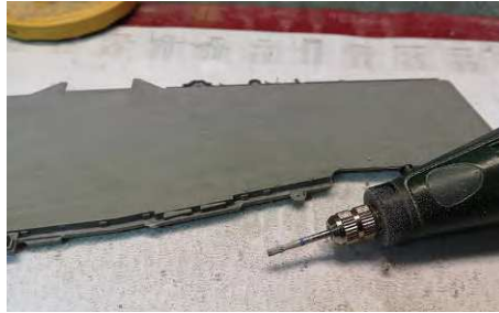
24 Das Abfräsen der angegossenen Niedergänge erfordert Mut und Ruhe, klappt aber dann ganz gut
