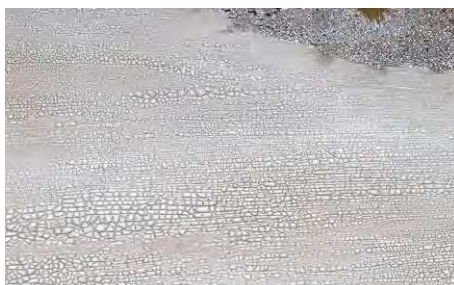
26 Je nach Dicke gibt es größeren Effekt, aber mit Klarlack-Schichten sollte alles dauerhaft fixiert werden
