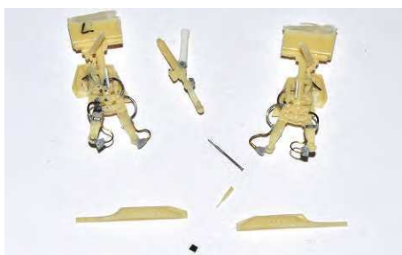
24 Die Fahrwerksklappen und Leitungen dienen auch als Verstärkungen für das labile Fahrwerk
