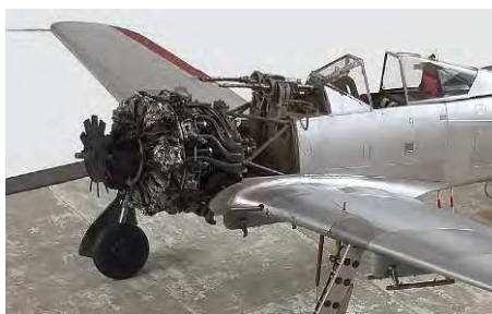
23 Der Motoreinbau verläuft ohne Probleme. Leider fehlten erst die Leitungen zwischen Brandschott und Motorrückseite
