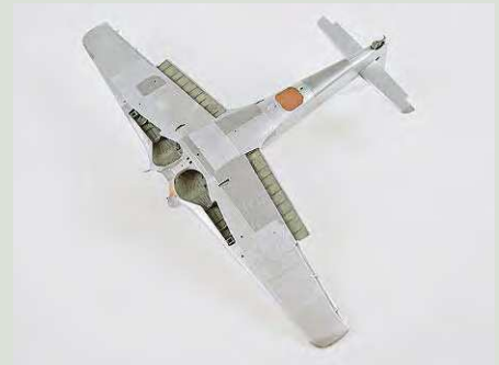
19 Der untere Mannlochdeckel erhält als Kontrast zum Metall eine Holzoptik mit Hilfe der Ölfarbertechnik
