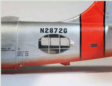
Genietete Oberflächen und über Kreuz verlaufende Streben auf den Fenstern der ehemaligen Coast-Guard-Maschine
