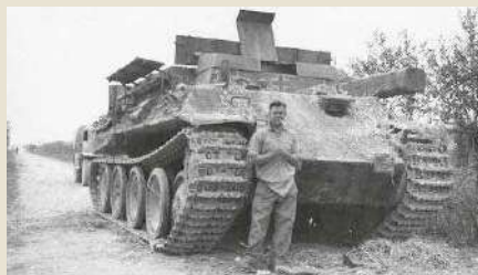
Bergepanther in Italien mit Aufbau über Fahrer und Funker (Truppenumbau zum Schutz gegen Witterungseinflüsse)
