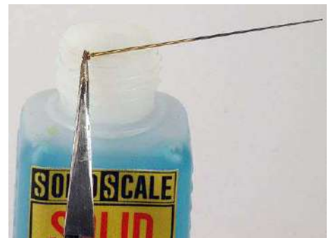
Die Verfärbung (= Brünierung, rechts) ist deutlich zu erkennen – eine umfassende und homogene Farbgebung ist das Ergebnis
