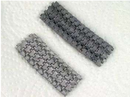
Der untere Kettenstrang ist unbehandelt, der obere bereits mehrfach mit Reinigungsmittel und Borstenpinsel bearbeitet
