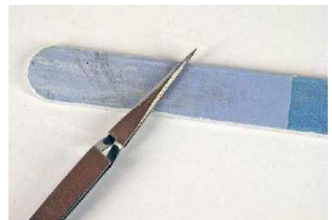
„Mitbrüniertes“ Werkzeug lässt sich leicht reinigen und dies sollte man auch unmittelbar danach umsetzen (Schleifwolle, -papier)
