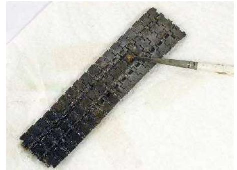
Die weitere und erneute Brünierung gelingt mit „Solid Track“ auch gut mittels Pinsel, (unterschiedliche Grade der Intensität)
