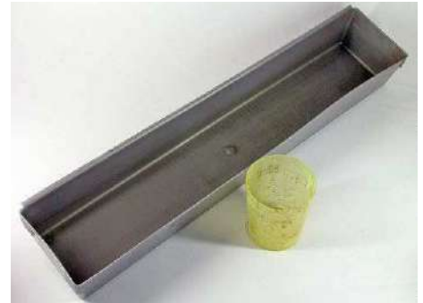
Kettenstränge: Eine schmale, längere Wanne aus dem Heimwerkerbedarf (hier für Besteck) kann man zum Reinigen und Brünieren nutzen
