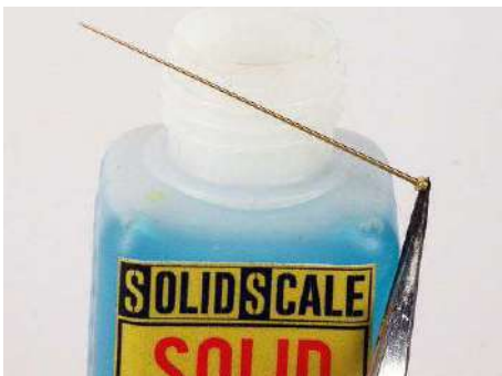
Auf der Pinzette steckt eine aus Messing gefertigte Funkantenne aus der Fabrikation von Schatten-Modellbau. Die soll ins Tauchbad
