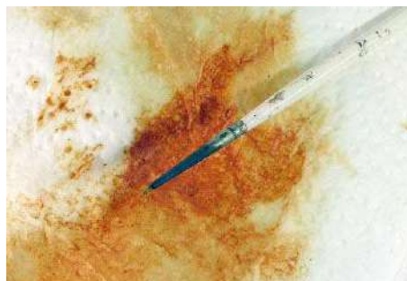
Die Oxidationsreste aus dem verwendeten Brüniermittel, hier auf einem Küchenpapier-tuch, das als einfacher Filter dient
