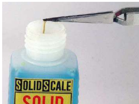
Es reicht, diese Antenne (mit der Pinzette sicher gehalten) für weniger als eine Minute in die Brünierflüssigkeit einzutauchen
