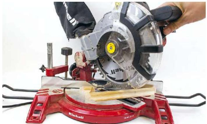
**6** Profilholz für Bilderrahmen und Zierleisten aus dem Baumarkt mit einer 45°-Kappsäge zusägen. Sie bilden den Zierrahmen
