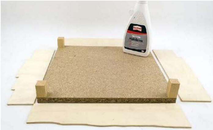
**3** Entsprechend der Geländestruktur mit fünf Millimeter Aufmaß die seitlichen Blenden aus Sperrholz aussägen und verkleben
