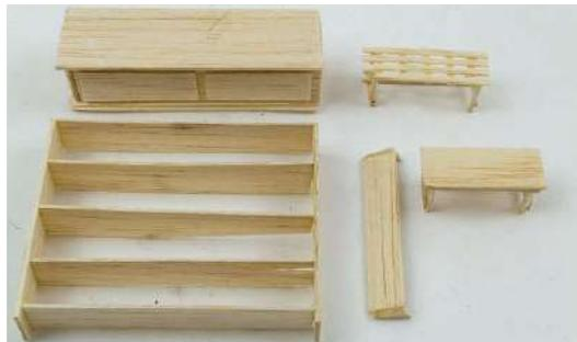
**1** Aus dem Balsaholz lassen sich mittels Lineal und Skalpell „Bretter“ ausschneiden und mit Sekundenkleber zu den gewünschten Möbeln verleimen
