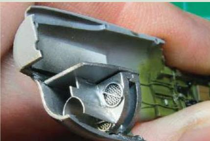
Das runde Leitblech zum Ölkühler war ein Trinkhalm, der unter dem senkrechten Leitblech eingepasst wurde
