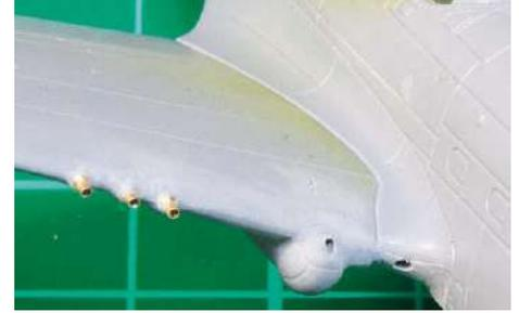
**9** Die Montage von Tragwerk und Rumpf hinterließ am Innenflügel eine leichte Stufe, wo es beim Original „nur“ Blechstärke war
