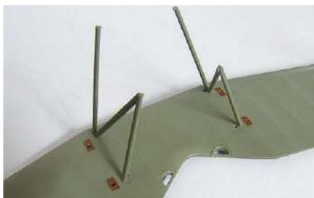
**18** Die Stiele passen hervorragend. Die kleinen Löcher in den braunen Feldern dienen zur Aufnahme der Spannschlösser
