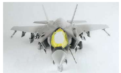
9 Der Rohbau ist nun fertig zum Lackieren. Das Cockpit sollte man in jedem Fall sorgfältig abdecken
