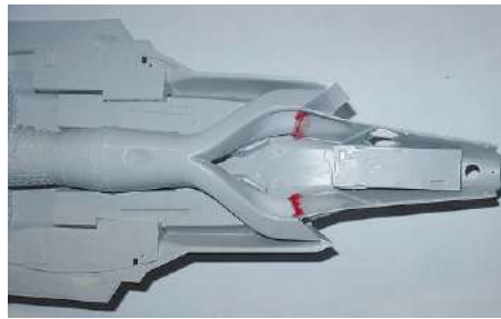
5 Spachteln war hier notwendig, bevor die Zelle und die Lufteinläufe nahtlos aneinander passten
