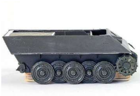
Die Laufräder sind mit Sekunden-Gelkleber vorbefestigt und mit Flüssigkleber und Filler auf den Innenseiten nicht sichtbar fixiert
