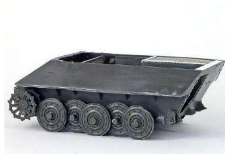
So gelingt es, dass alle Laufräder in einer Ebene auf dem Boden stehen. Hier ginge es dann mit dem Aufziehen der Ketten weiter
