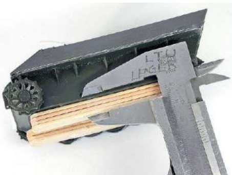
Mit einem Messschieber den Abstand überprüfen und anschließend die Holzstäbchen entsprechend aufeinander zusammensetzen
