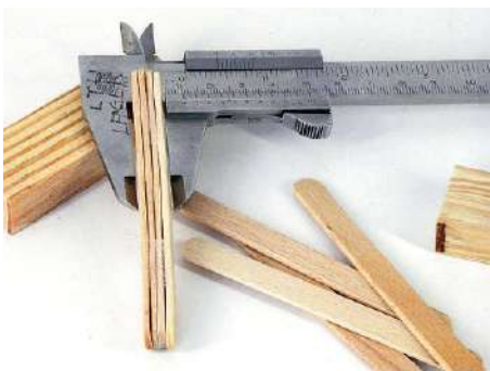
Die Holzklötze sind zu stark und nicht geeignet. Hölzerne Eisstäbchen liefern das gewünschte Maß (alternativ: Pappe)
