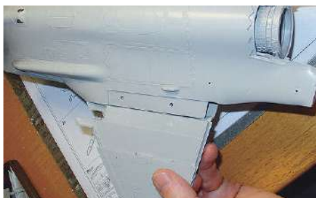
7 Die für die Montage der Flügel an den Rumpf vorgesehenen Zapfen passten nicht und kamen deshalb weg
