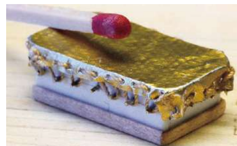
15 Oberdeck-Niedergang aus Polystyrol mit Holzfurnier, Silberdraht, Takelgarn. Die Folie stammt von einem Rotwein
