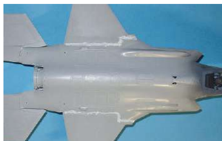
8 Hier klappt nach dem Zusammenbau eine Spalte, die Füllmaterial und Schleifarbeit erfordert
