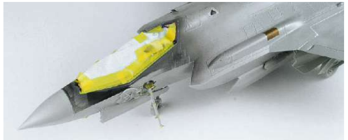
11 Spritzschäden und Farbnebel haben im Inneren des Flugzeugführerplatzes nichts zu suchen
