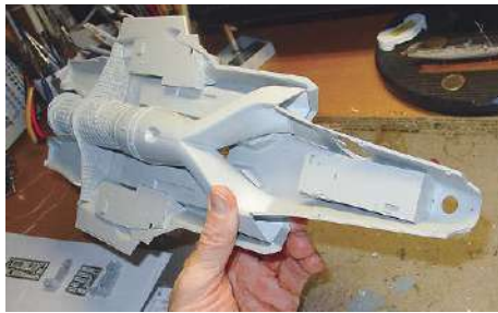
4 Die Innenseite weist einige Auswurfdefekte auf, welche der Modellbauer noch aus-schleifen muss
