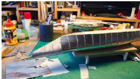
8 Das Alublech wurde vor dem Aufbringen auf den Rumpf von der Rückseite mit einem Nietenrad verziert
