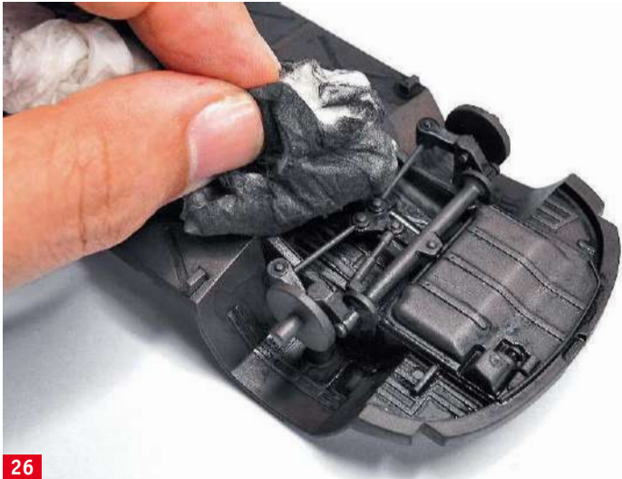
26 ... übertriebene Alterungsspuren entfernt
