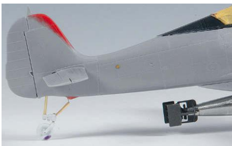
19 Das Heckteil mit dem verlängerten Rad. Die Achse ist ein Aluminiumröhrchen von Albion Alloys
