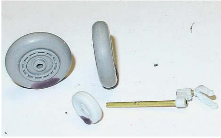
13 Die Gewichtssimulation ist aus Wachs modelliert. Auch zu sehen ist das verlängerte Heckbein
