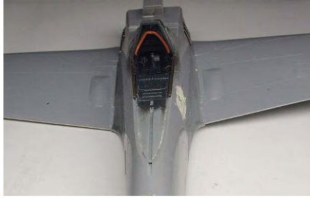
11 Die gefütterte Schutzkante um das Armaturen Brett ist aus der Isolierung eines Kabels hergestellt
