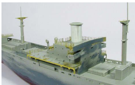
5 Der aufgefütterte Schornstein ist fertig verschliffen, Aufbauten und Rumpf sind mit einem Primer geglättet
