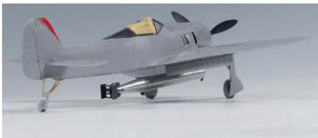
16 Der Rohbau, von hinten gesehen, macht deutlich, warum das verlängerte Heckrad notwendig war
