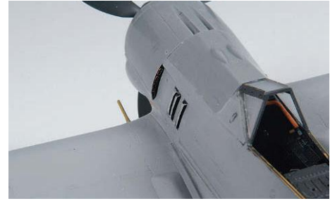
15 Detailansicht auf die Kiemen, die jetzt wirklich hohl sind. Auch schon installiert sind die fertigen Abgangsrohre
