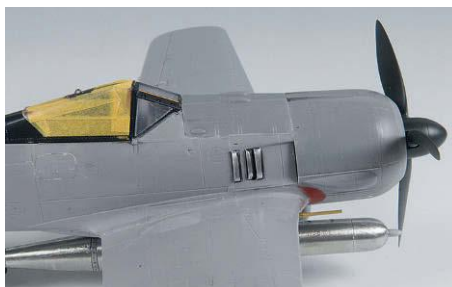
20 Seitenansicht mit inneren Bordwaffen. Die Bewaffnung vor dem Cockpit war ausgebaut worden, um Gewicht zu sparen
