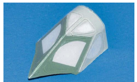
35 Das ist nicht Batmans Maske, sondern der von innen lackierte Atomexplosions-Blendschutz
