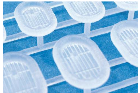
27 Ähnlich gut sieht es bei den Rettungsflößen im Rohzustand aus. Feinste Details sind zu erahnen
