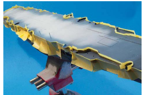
30 Vor der Lackierung des Flugdecks heißt es wieder reichlich Abkleben. Die Paßstifte fixieren später die Insel
