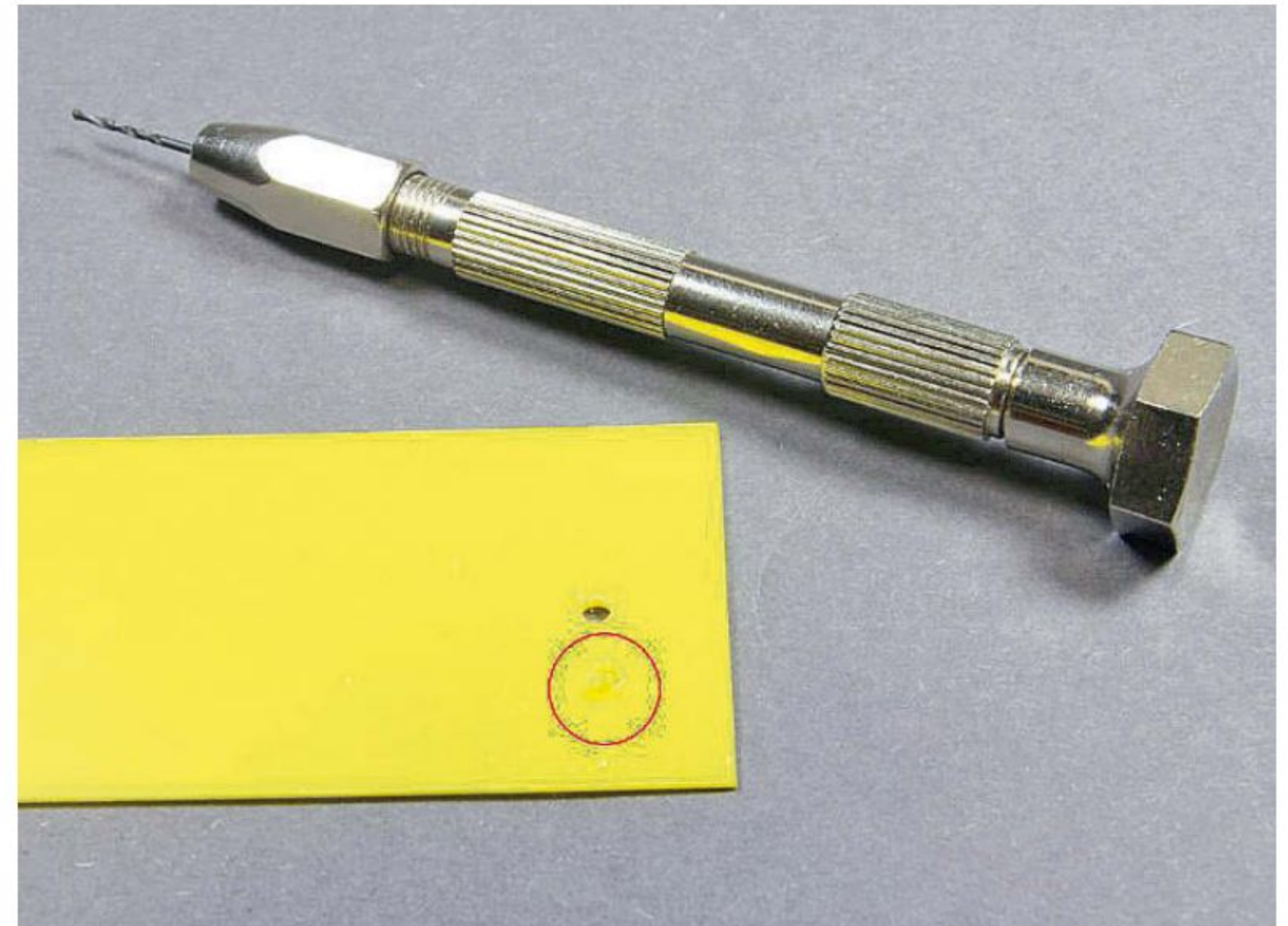
Vorsicht beim Bohren und Schleifen: Zu hohe Geschwindigkeiten führen unweigerlich zum Schmelzen. Besser einen Handbohrer benutzen
