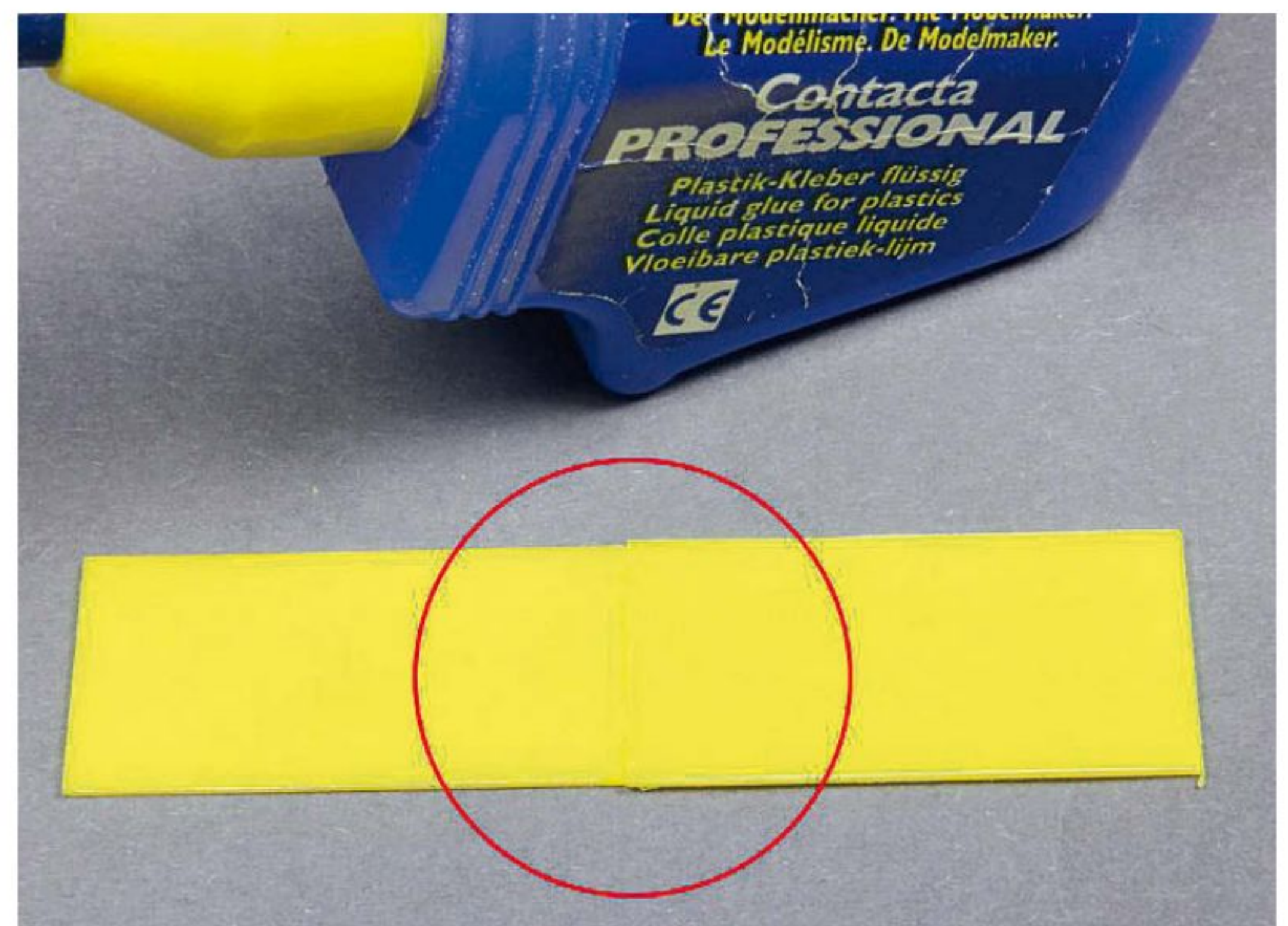
Das Verkleben von Plastikteilen gelingt durch das Anschmelzen mit Klebstoff, dadurch verbinden sich die Bauteile dauerhaft
