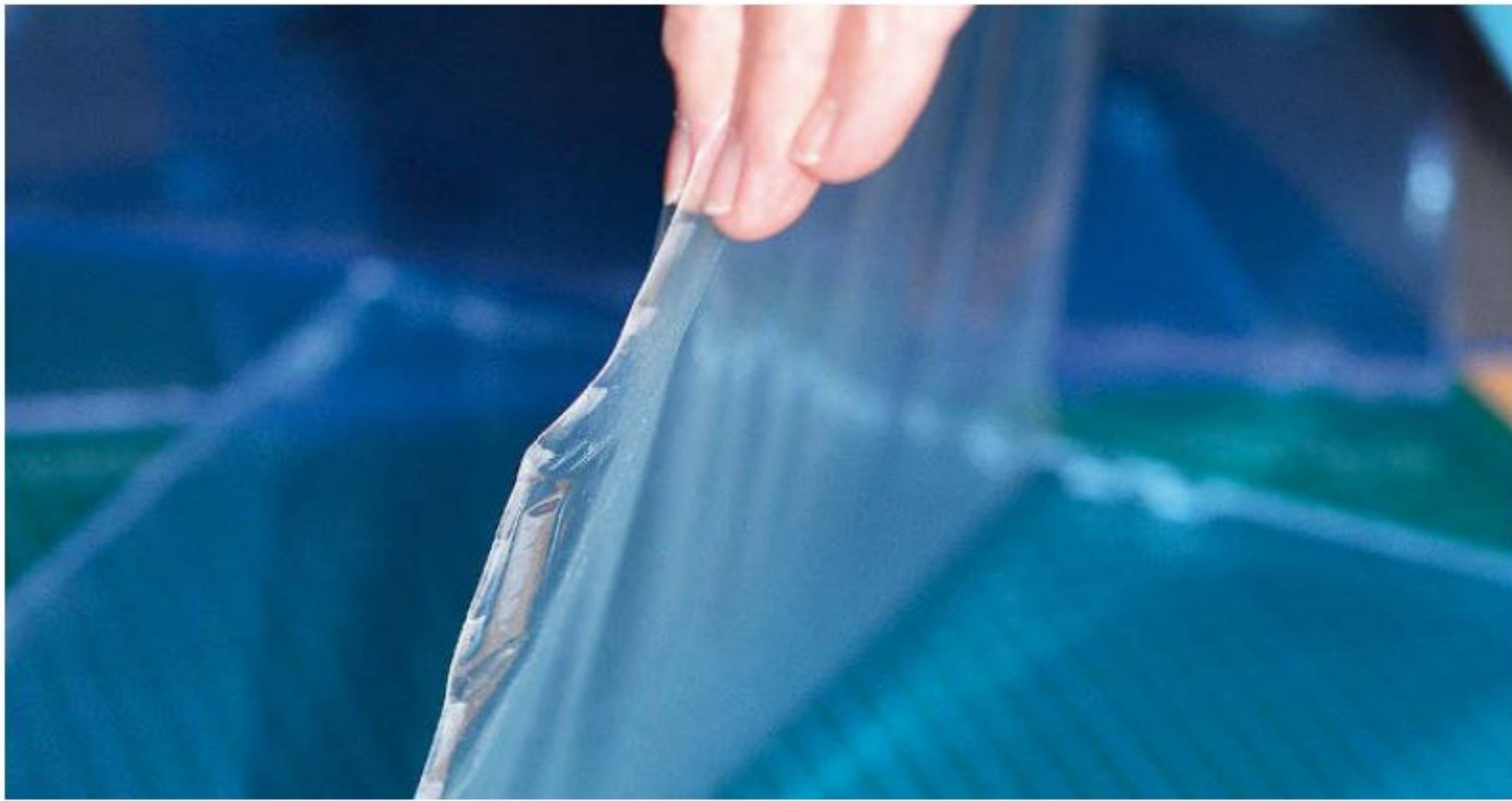
Vor dem Zusammenbau ist die beidseitig aufgebrachte Schutzfolie abziehen. Das Plattenmaterial aus Kunststoff ist nur bedingt kratzfest
