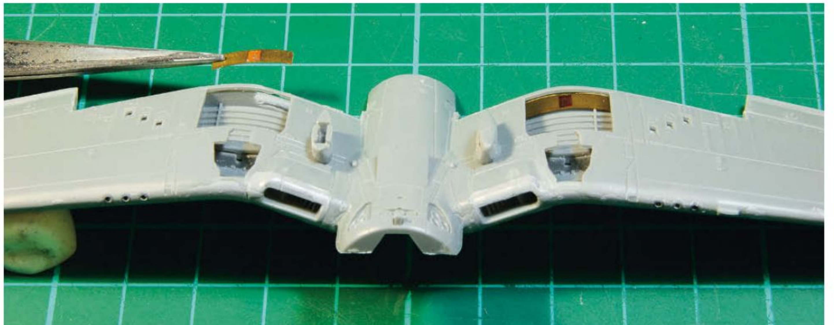
14 Für die Klappen war die Rückwand des Schachtes erheblich abzutragen. Ätzbogenreste verdecken die Durchbrüche
