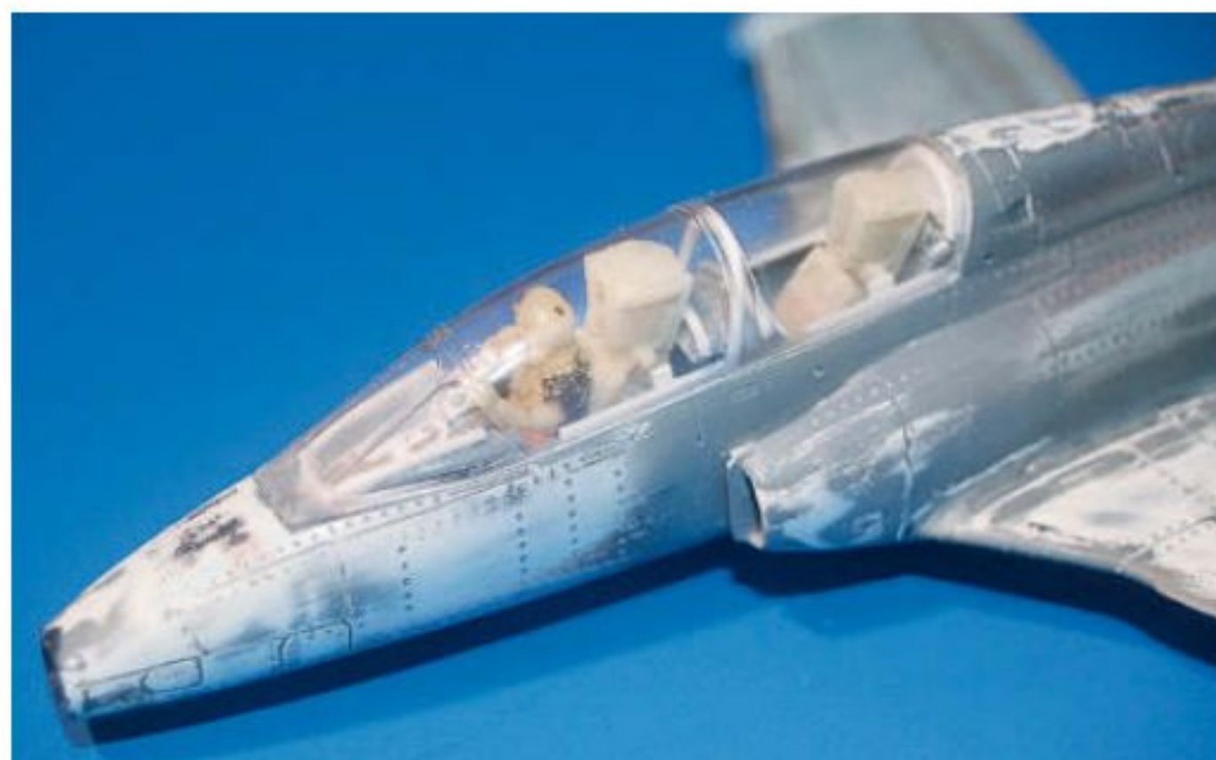
17 Trockenproben sind extrem wichtig und zeigen, ob all die neuen Teile überhaupt unter die Haube kommen
