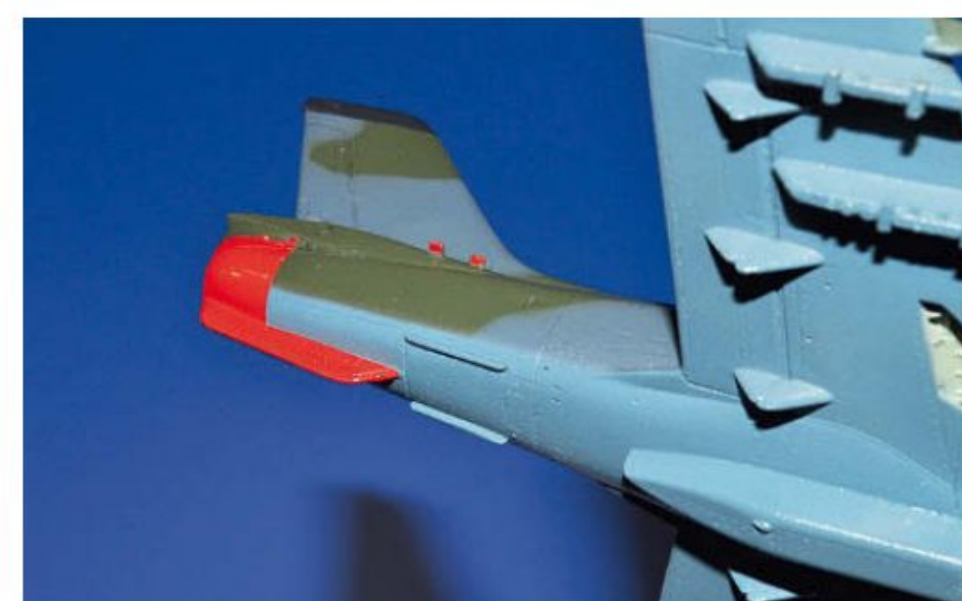
31 Durch den Klarlack offenbaren sich Lackierfehler. Hier sind gut 20 Stellen zum Teil mehrfach nachgearbeitet
