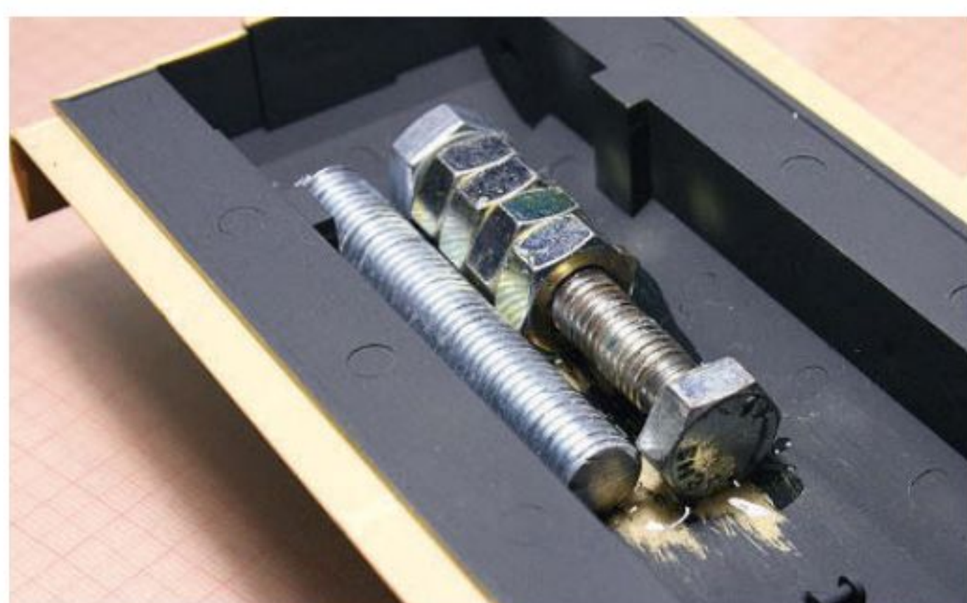
26 Wie schon beim Vietnam-Modell sorgt viel Ballast für einen sicheren Stand, denn der Ausleger trägt später ein Gewicht
