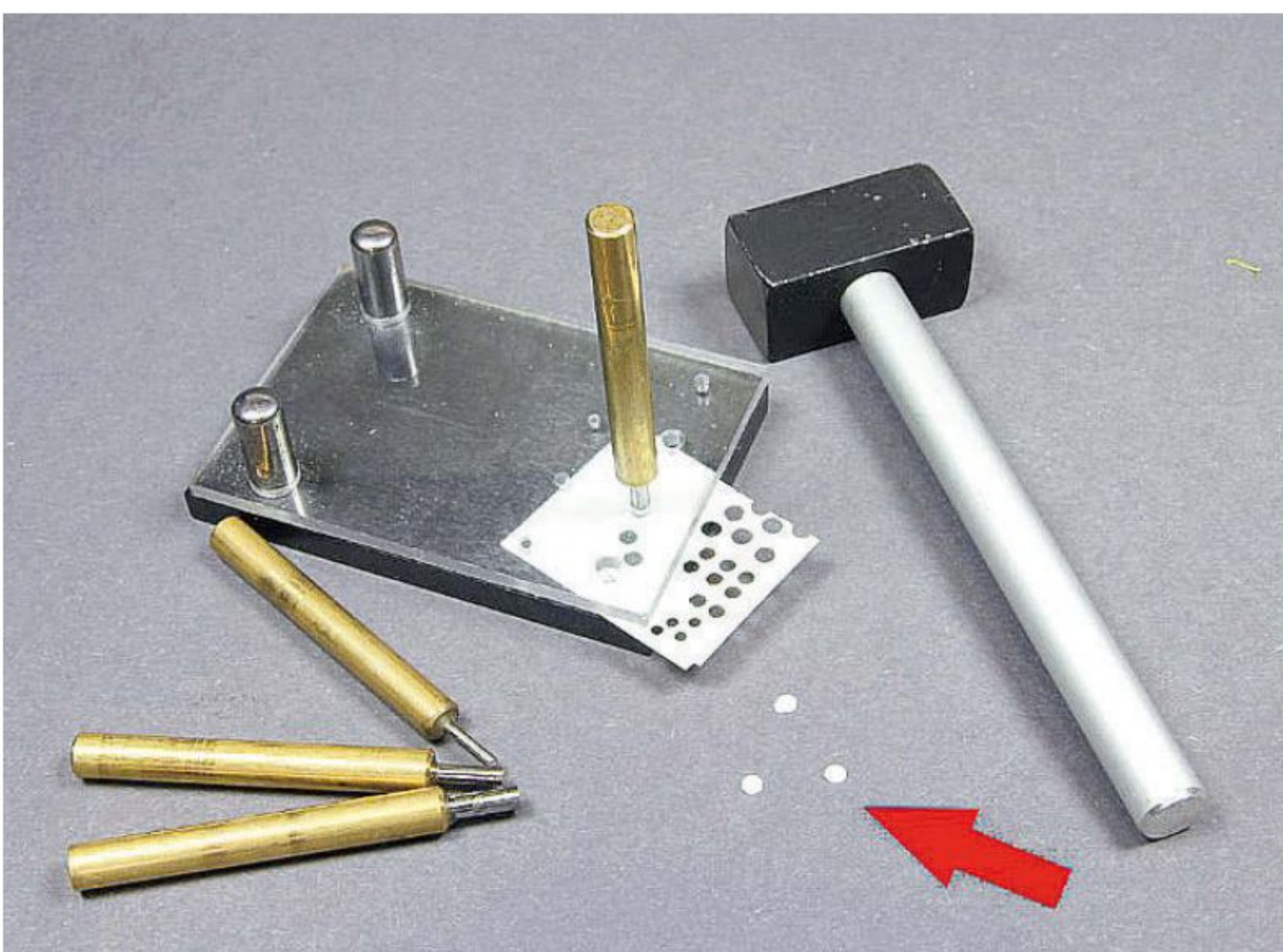
Für die Herstellung von kleinen Plastikplättchen bietet sich die Verwendung von „Punch-&-Die“-Sets an (Plättchen ausstanzen)
