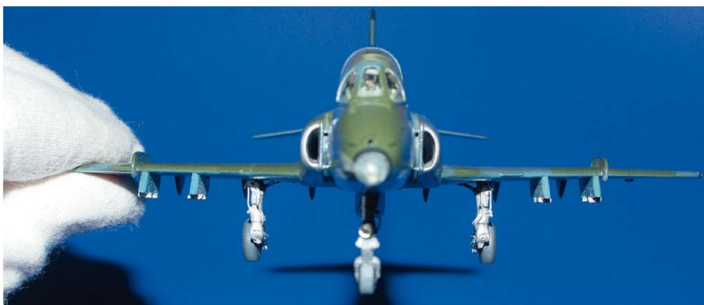
29 Das wichtigste Kriterium: Der Modellbauer muss die Elemente wie beim Original exakt ausrichten. Mangelnde Symmetrie fällt sofort auf
