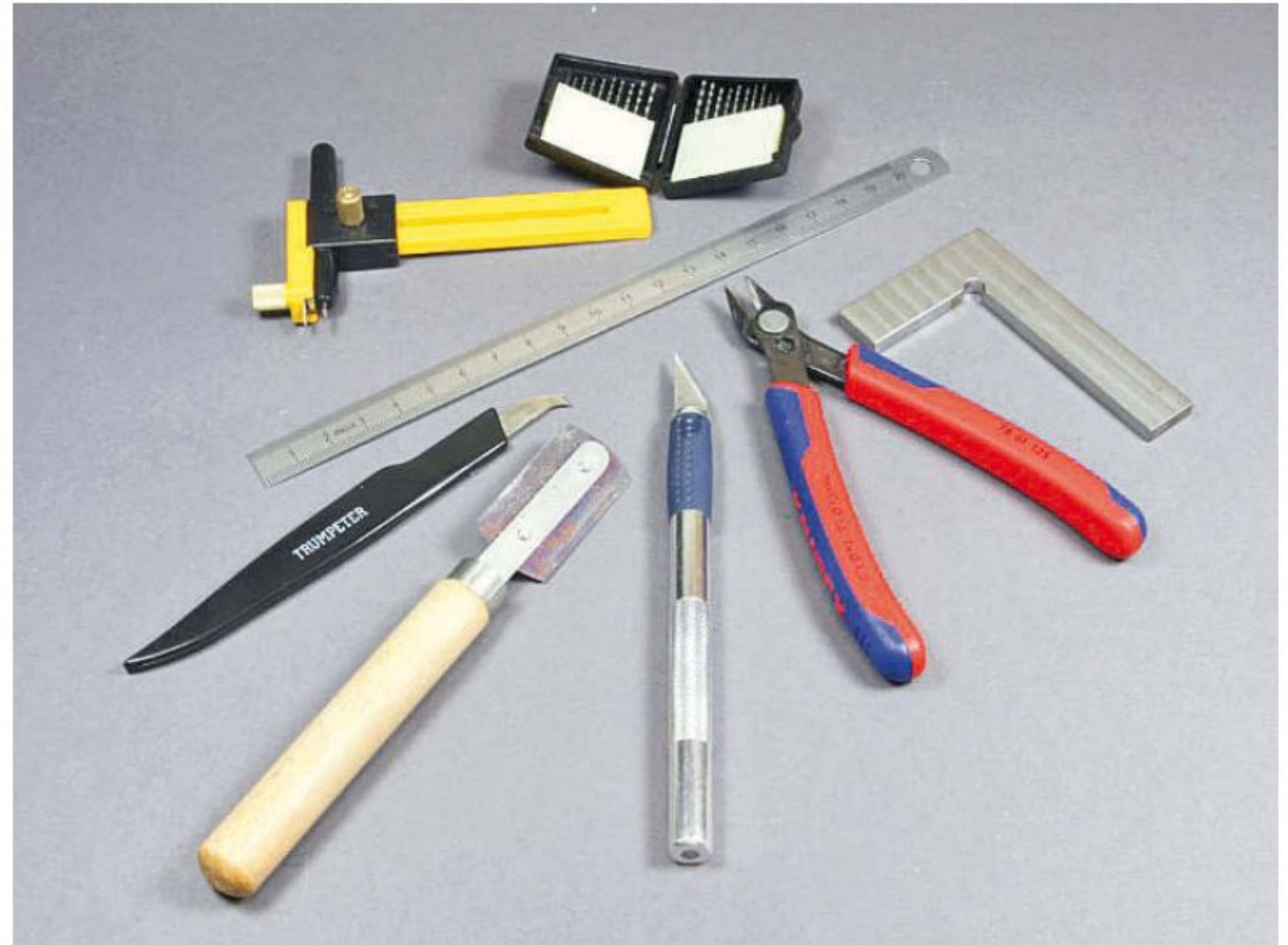
Einfaches Werkzeug genügt: Bastelmesser, Gravierwerkzeug, Säge, Stahllineal, Winkel, Messschieber, Seiten- und Kreisschneider, Bohrer
