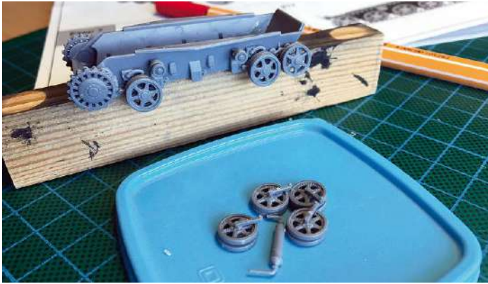
Bereits bei der Montage des Laufwerks hilft ein Holzstück, die Laufräder korrekt und passgenau auszurichten und zu verkleben
