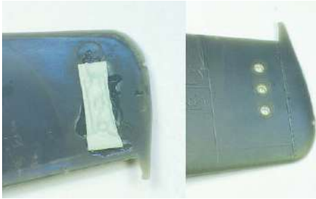
10 Die Positionslichter für Backbord und Steuerbord sind eingeklebt und mit einem Stück Alufolie „verschlossen“
