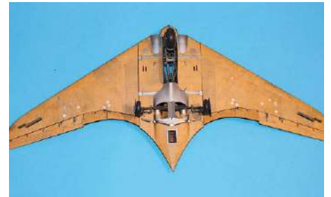
22 Die Unterseite der Horten mit Beplankung. Leider zeigten sich hier zwischen Flügel und Rumpf leichte Passprobleme
