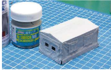
12 Die Plane nach dem Verkleben und Verspachteln kleiner Lufteinschlüsse grundieren und oben mit Mr. Surfacers 500 betupfen
