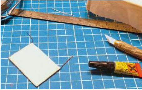
11 Planenbau: ein Stück Kunststoffplatte zuschneiden und mit Papiertuch bekleben. Den Rahmen aus Bleifolie erstellen
